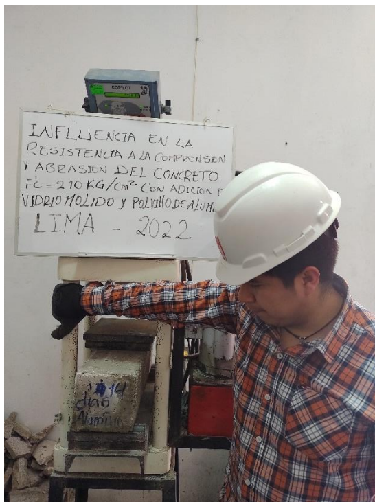
Figura 15. Ensayo de la resistencia a la flexión
