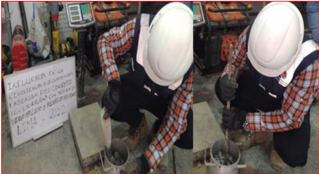
Figura 69. Llenado y compactado del agregado grueso
