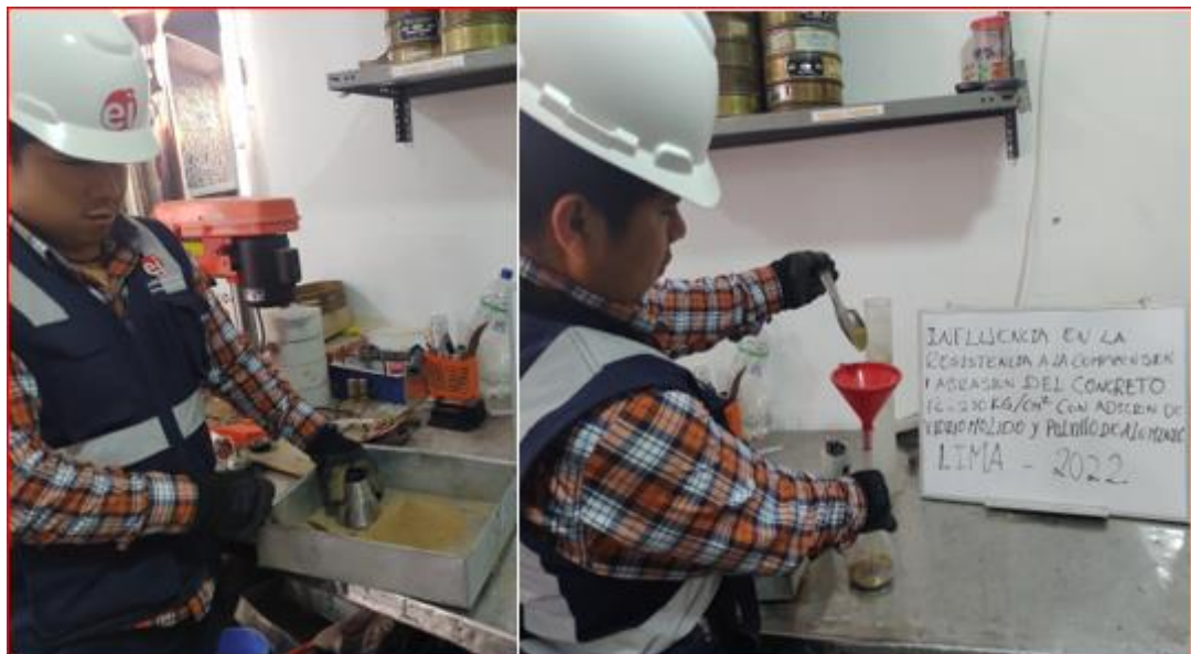
Figura 72. Procedimiento para determinar el peso específico y la absorción del agregado fino
