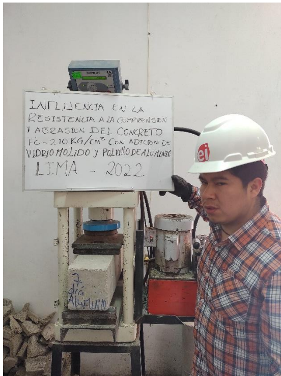
Figura 13. Ensayo de la resistencia a la flexión
