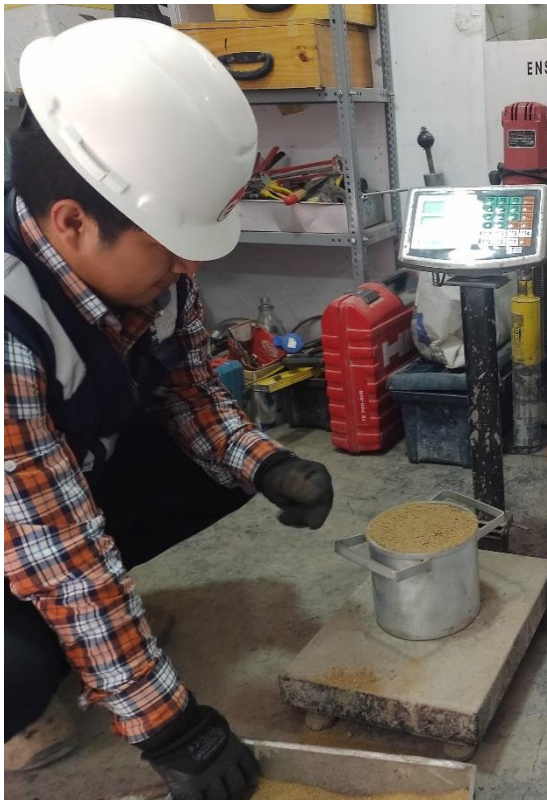
Figura 64. Pesado del agregado fino suelto
