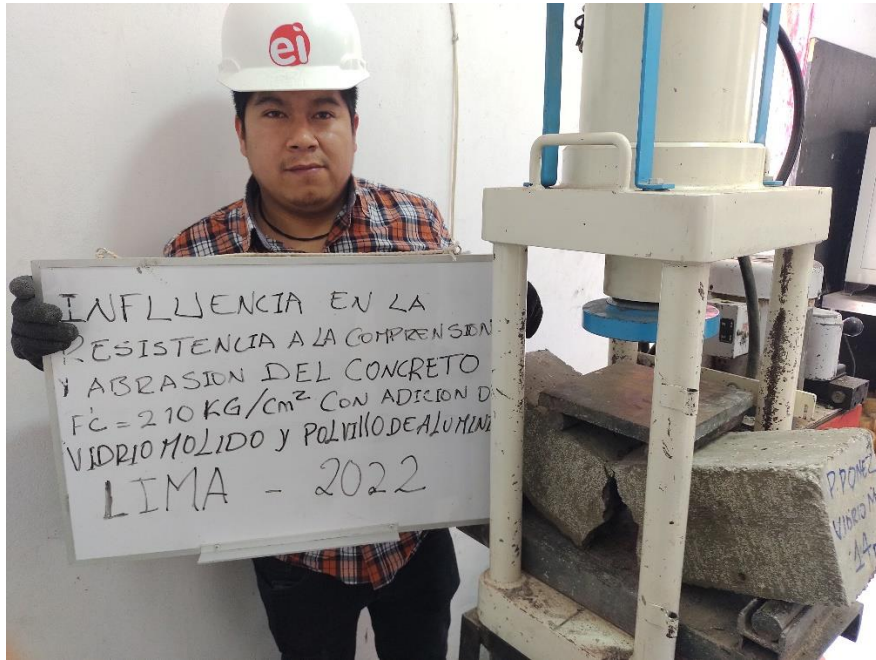
Figura 16. Ensayo de la resistencia a la flexión
