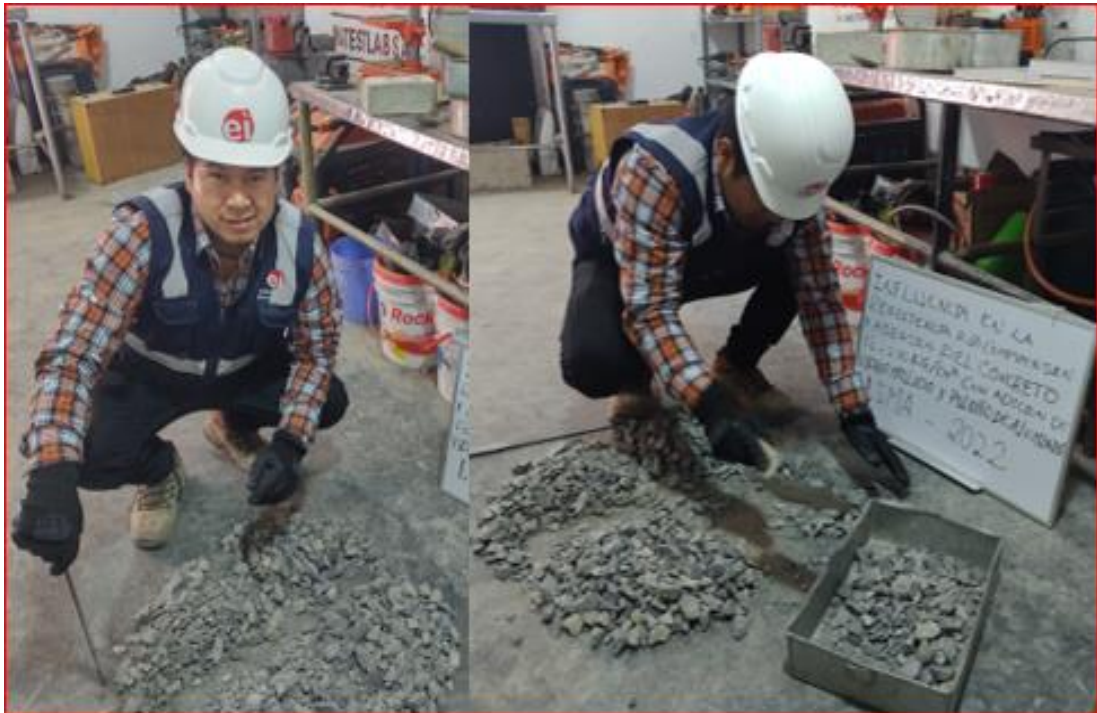
Figura 51. Cuarteo y seleccionado de agregado grueso
