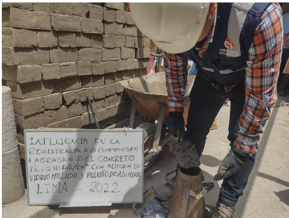
Figura 84. Prueba del Slump
