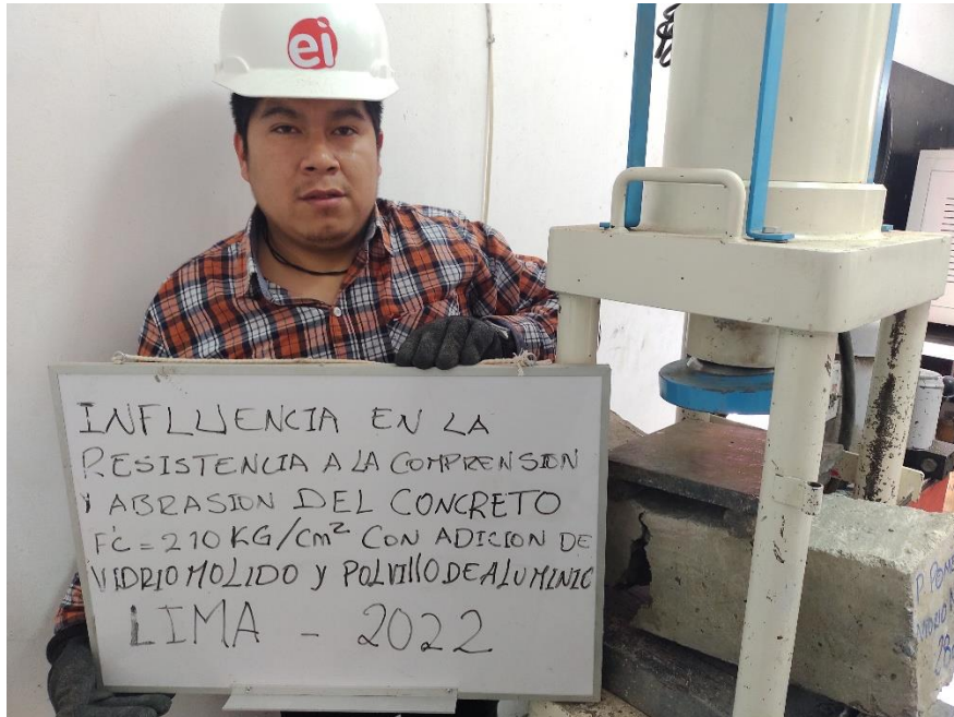
Figura 103. Ensayo de la resistencia a la flexión
