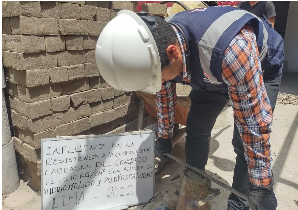
Figura 85. Prueba del Slump
