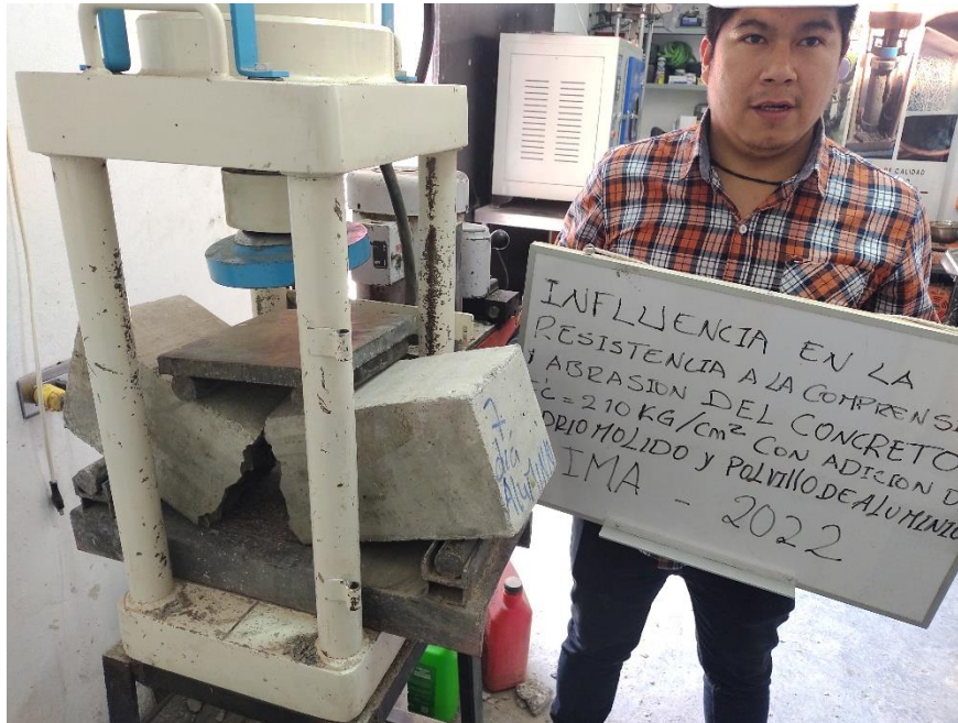
Figura 99. Ensayo de la resistencia a la flexión
