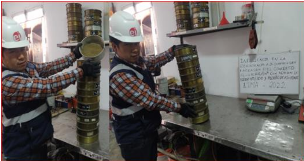
Figura 55. Llenado y tamizado del agregado fino
