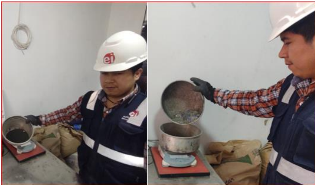
Figura 78. Materiales para la mezcla con adición de vidrio pulverizado y polvillo de aluminio
