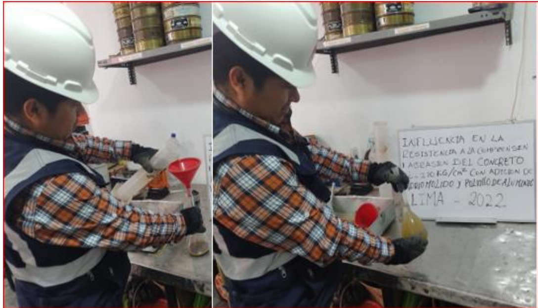
Figura 73. Procedimiento para determinar el peso específico y la absorción del agregado fino
