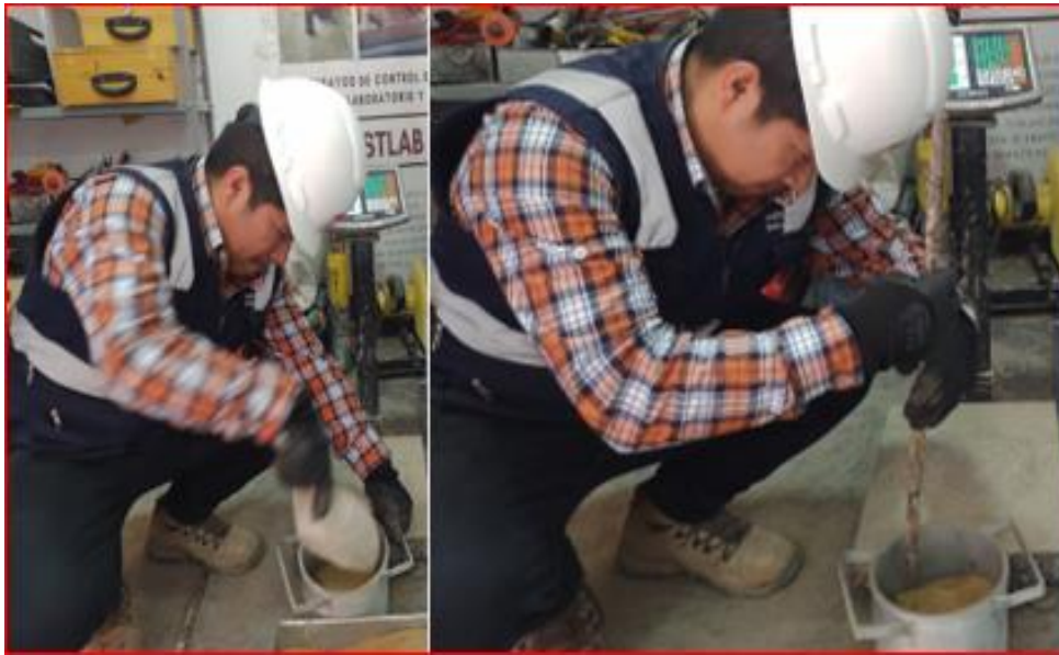
Figura 67. Llenado y compactado del agregado fino
