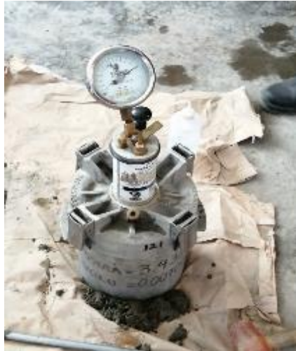
Figura 87. Prueba de contenido de aire
