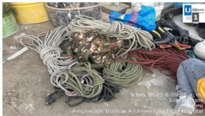
Foto N°7: Inspección de líneas de vida
