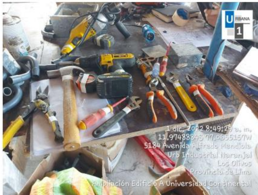
Foto N°3: Inspección de herramientas manuales al área de II.EE.
