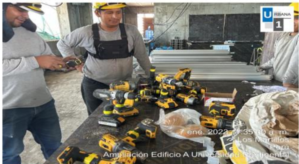
Foto N°5: Inspección de herramientas manuales a la cuadrilla de vidrio, donde se solicita la colocación de la cinta de seguridad del mes (color amarillo - enero).
