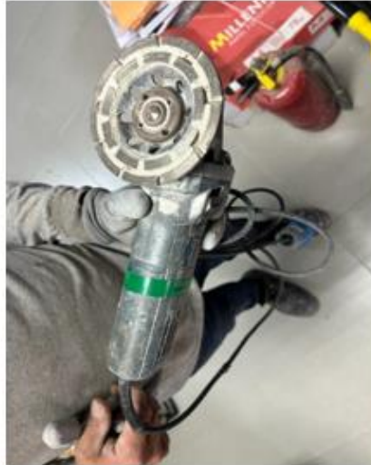
Foto N°2: Inspección de amoladora solo para uso de desbaste
