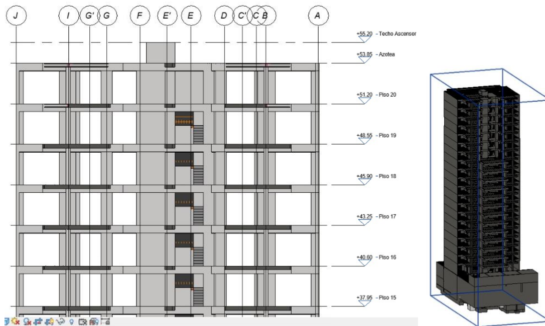
Modelado de superestructura - Central Home
