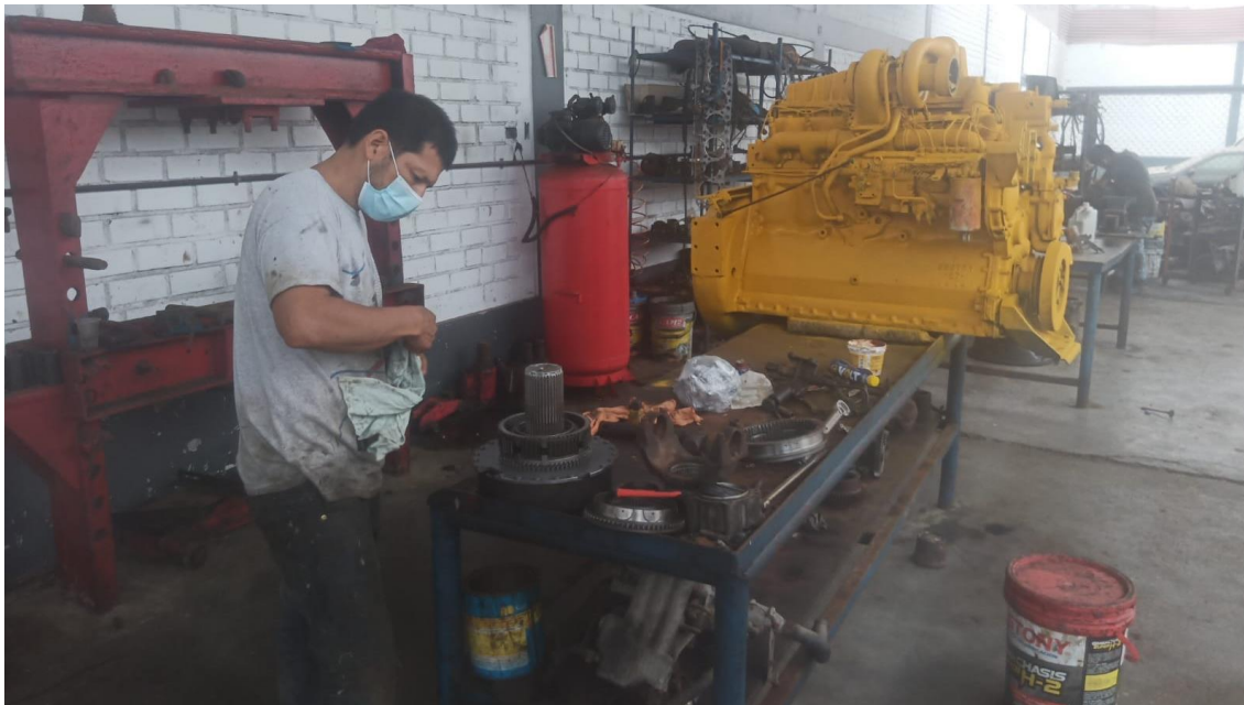
Anexo 5: Adhiriendo repuestos nuevos de empaque en la empresa P&F Reparaciones S. A. C.
