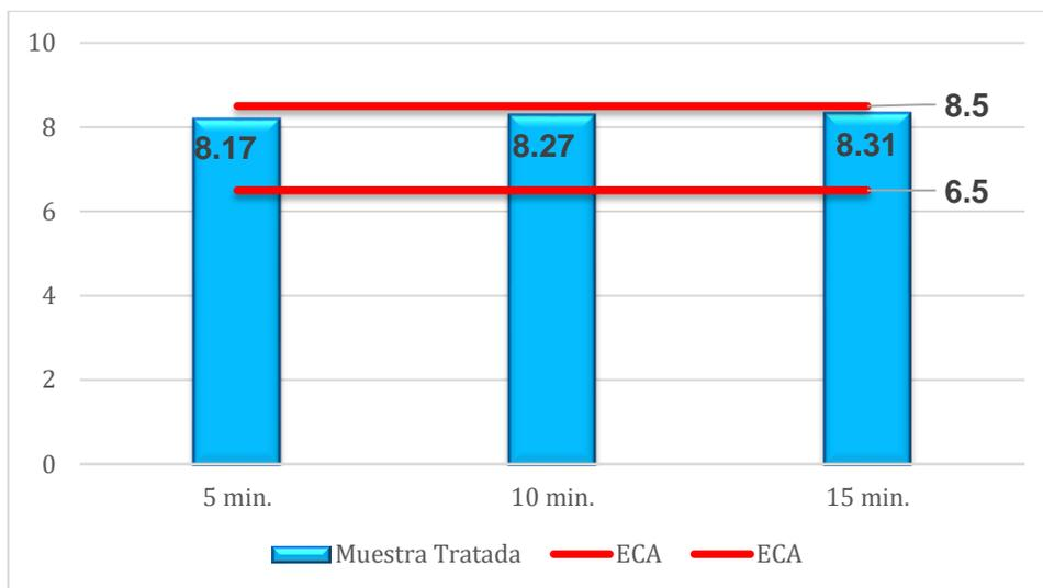
*Nota:* En el siguiente gráfico se tiene la estimación de los promedios de las muestras tratadas del río Rímac con el tratamiento de micro burbujas de forma teórica en los intervalos de tiempo de 5,
