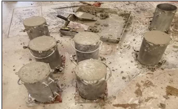
Figura 16. Preparación de probetas segundo lote
