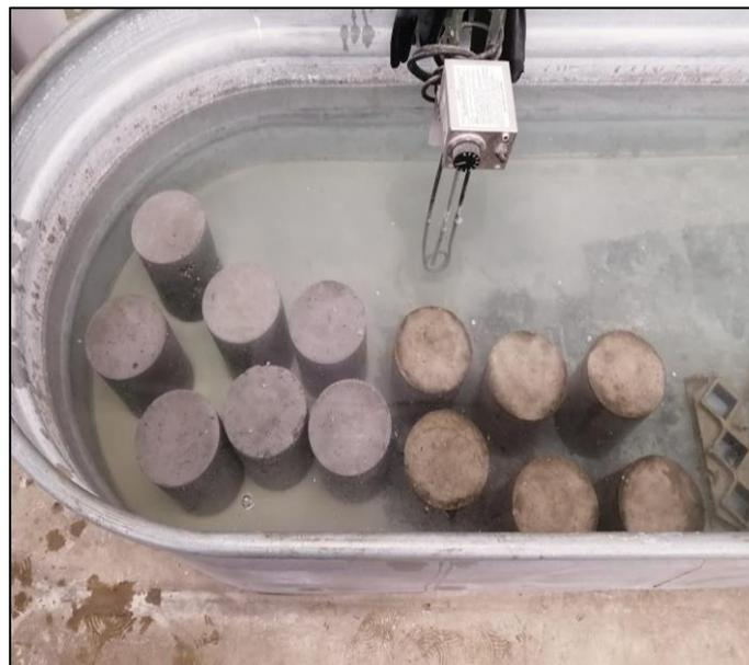
Figura 19. Colocación de las probetas en la tina de curado
