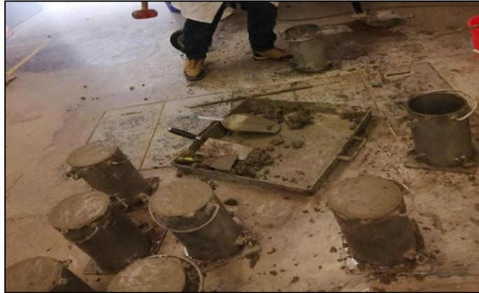
Figura 15. Preparación de probetas primer lote
