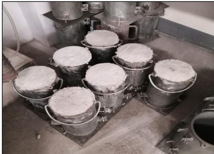
Figura 17. Probetas listas para desmoldar
