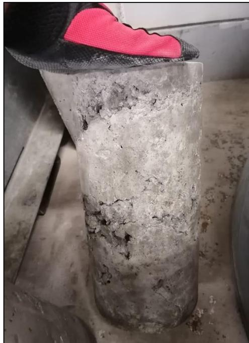
Figura 18. Presencia de cangrejeras en las probetas
