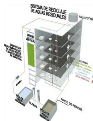
Figura N° 18 Tratamiento de agua grises en edificio sostenible
