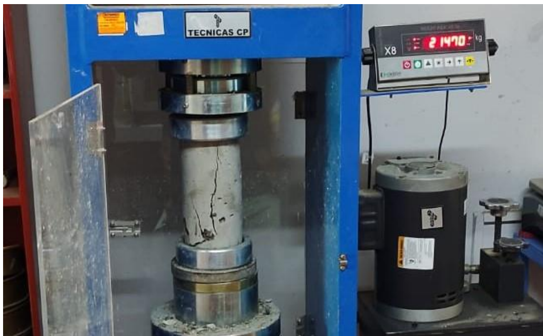
Resistencia a compresión, a edad de 28 días Concreto con Sika Aer al 0.09%.
