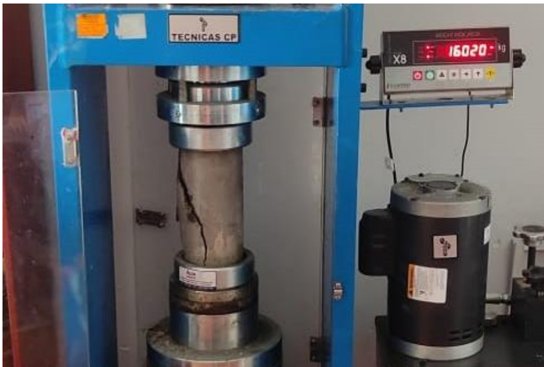
Resistencia a compresión, a edad de 07 días Concreto con Sika Aer al 0.06%.
