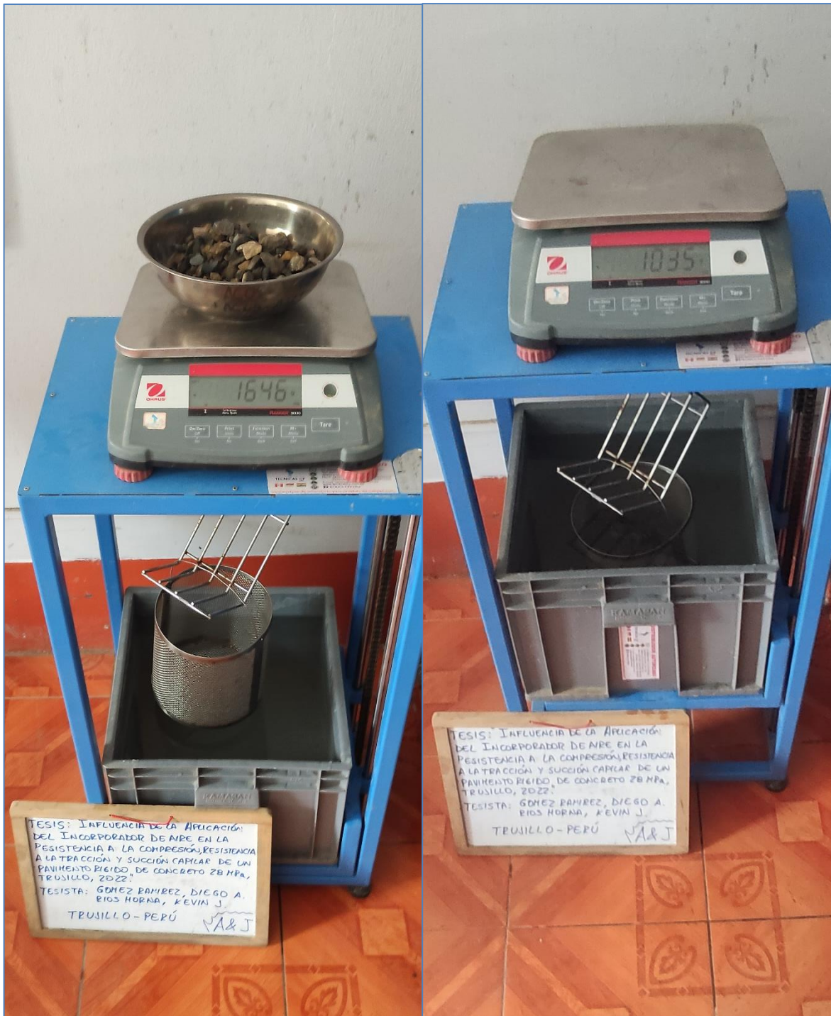
De izquierda a derecha: Toma de dato de Peso Saturado superficialmente seco del agregado grueso. Toma de dato del peso sumergido de la misma muestra de agregado.
