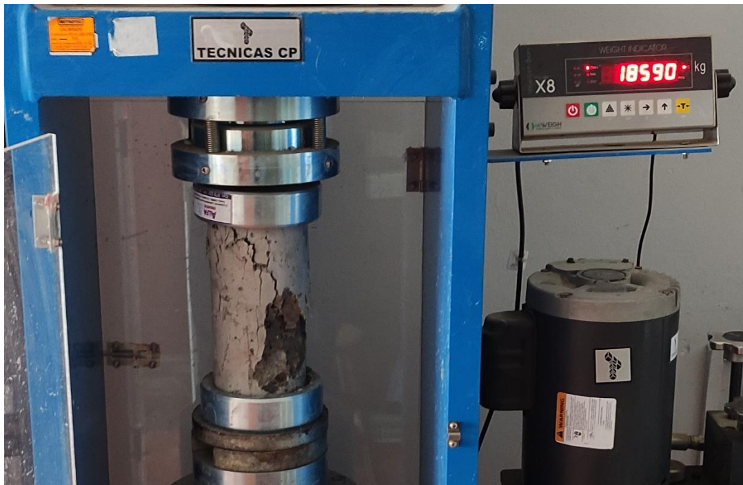
Resistencia a compresión, a edad de 14 días Concreto con Sika Aer al 0.09%
