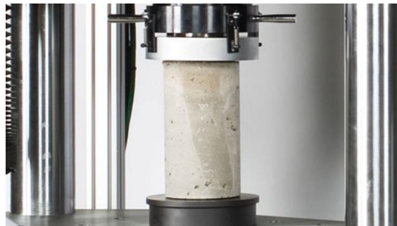
Figura 1 Ensayo de resistencia a la compresión
