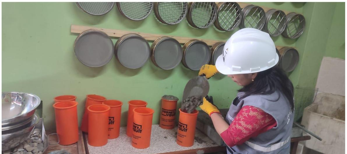
Figura 2. Elaboración de probetas
