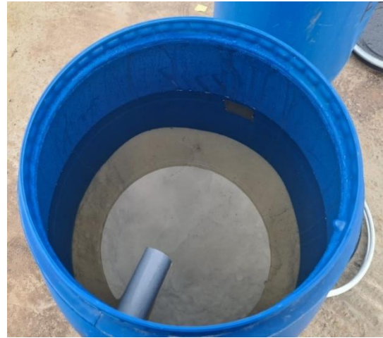
Imagen N° 12: Filtro de piedra Caliza y arena Cuarzosa
