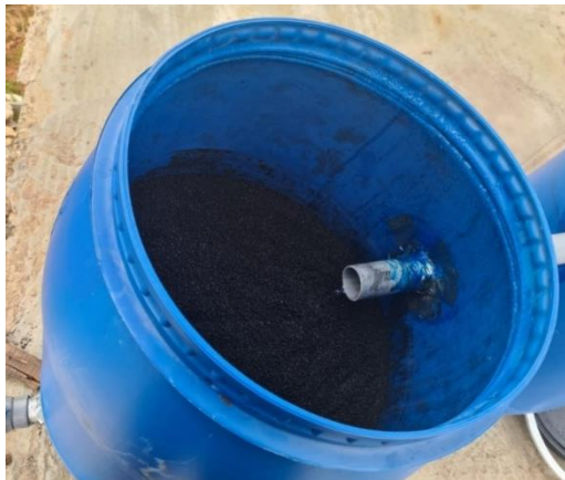
Imagen N° 15: Filtro de carbón Activado
