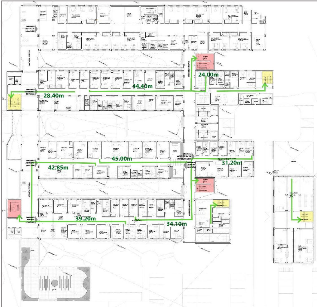
Figura 114: Diseño y ubicación de la escalera de evacuación - resto de UPSS y UPS Fuente: Elaboración propia
