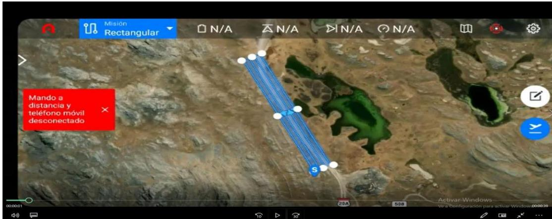
*Nota.* Se muestra en la figura la programación de recorrido de 4 pasadas rectangular a una altura de 60 metros
