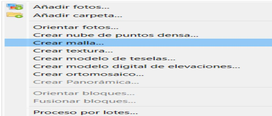
*Nota.* Cómo se puede observar en la figura ya teniendo la información de nubes de punto densa ya se puede crear malla que consiste en hacer o reconstruir un modelo poligonal.
