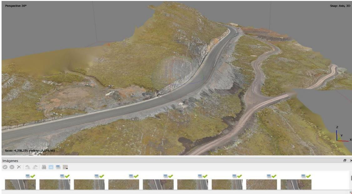
*Nota.* Se observa en la figura ya el resultado donde se ha creado el modelo de teselado, modelo de texturizado y malla en 3D.
