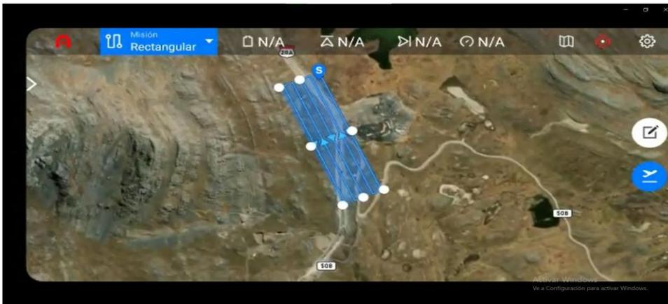
*Nota.* Se observa en la figura la programación de recorrido de 5 pasadas rectangular a una altura de 60 metros
