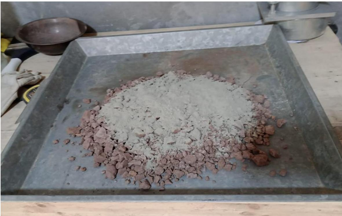
**Figura 89.** Mezcla de cemento portland tipo I y material granular de la cantera San Vicente
