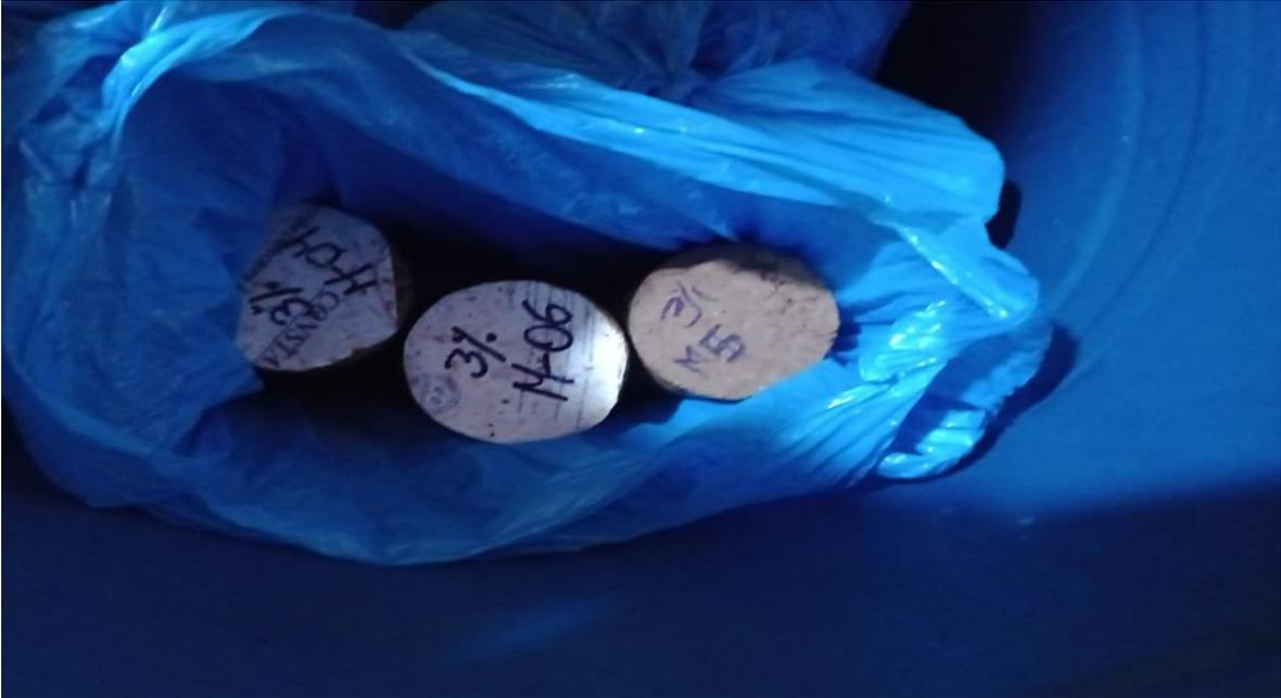
**Figura 94.** Curado de Probetas de suelo con las dosificaciones para diseño.
