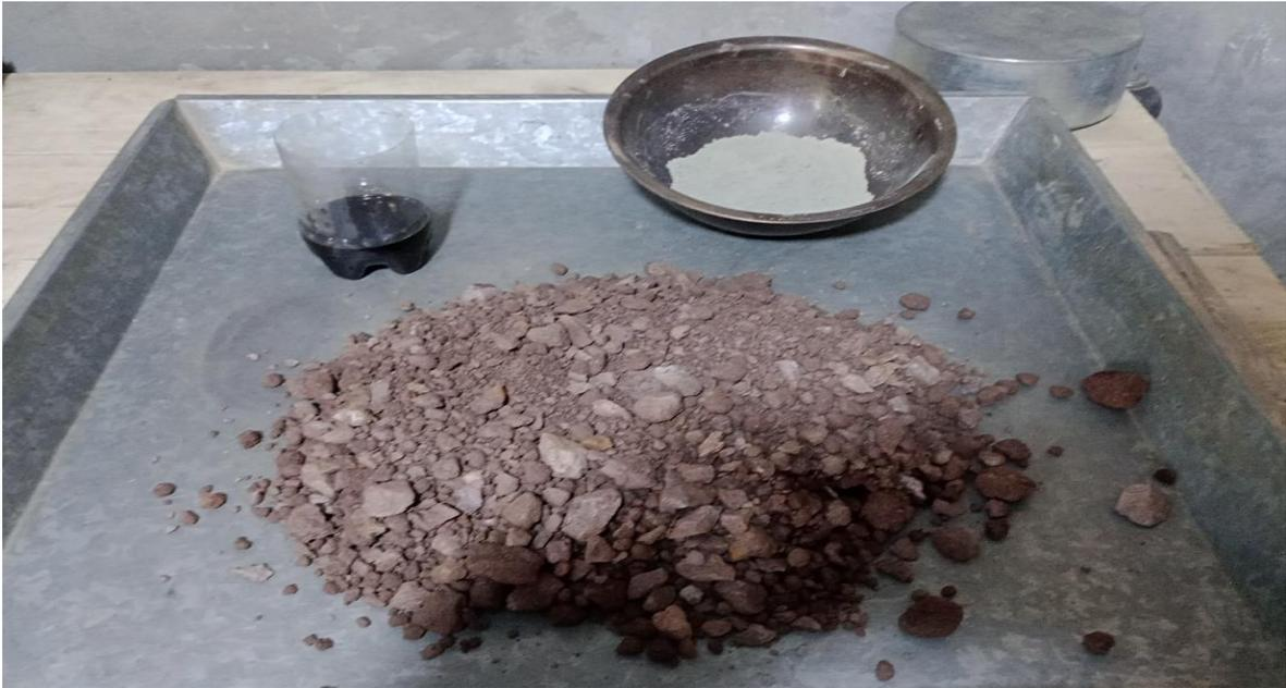
**Figura 88.** Mezcla de Aceite de motor reciclado, cemento portland tipo I y material granular de la cantera San Vicente
