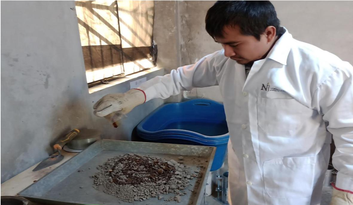
**Figura 90.** Mezcla de Aceite de motor reciclado, cemento portland tipo I y material granular de la cantera San Vicente
