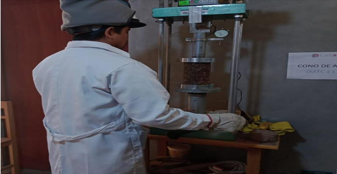
**Figura 96.** Resistencia a la Compresion Probetas de suelo con las dosificaciones para diseño.
