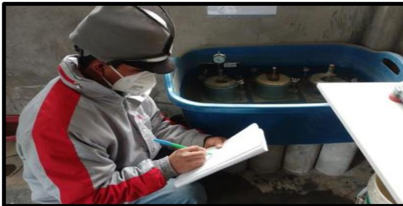
*Figura 15. Ensayo CBR*
