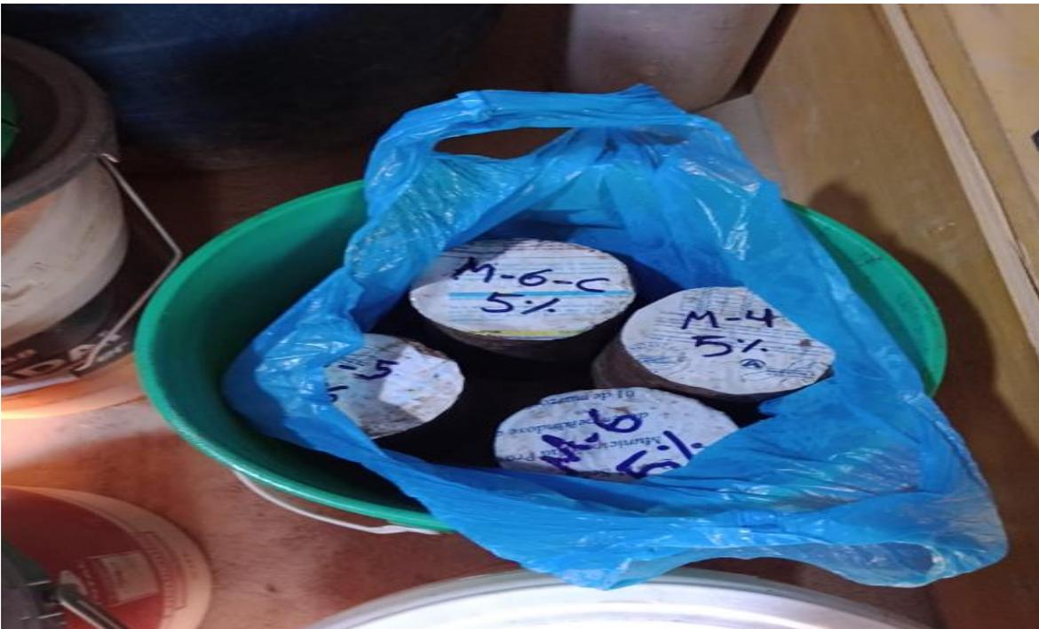
**Figura 95.** Curado de Probetas de suelo con las dosificaciones para diseño.
