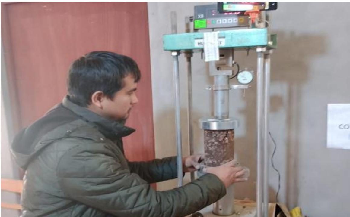
**Figura 97.** Resistencia a la Compresion Probetas de suelo con las dosificaciones para diseño.
