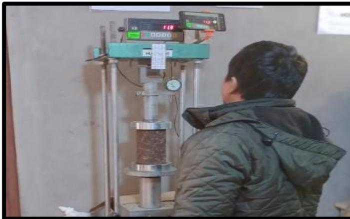
*Figura 17.* Resistencia a la compresión Simple.
