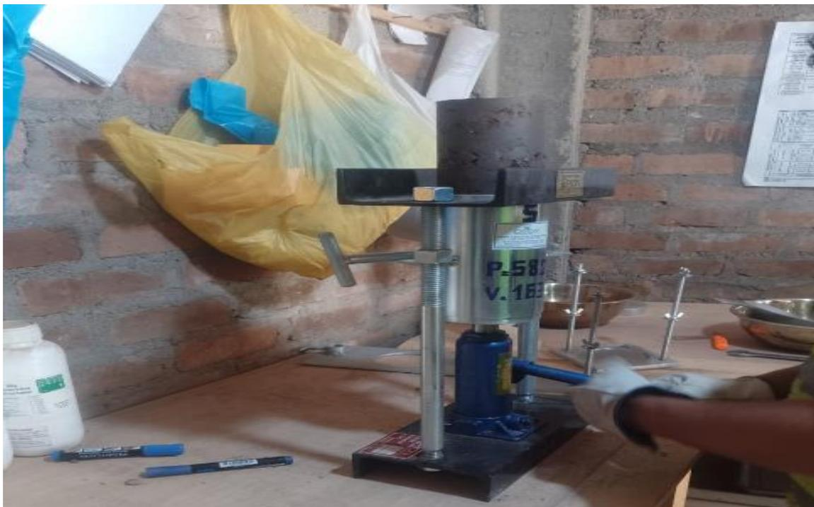
**Figura 91.** Extracción de probeta.
