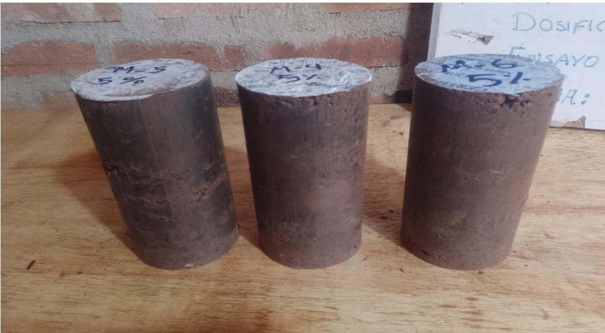
**Figura 93.** Probetas de suelo con las dosificaciones para el diseño.
