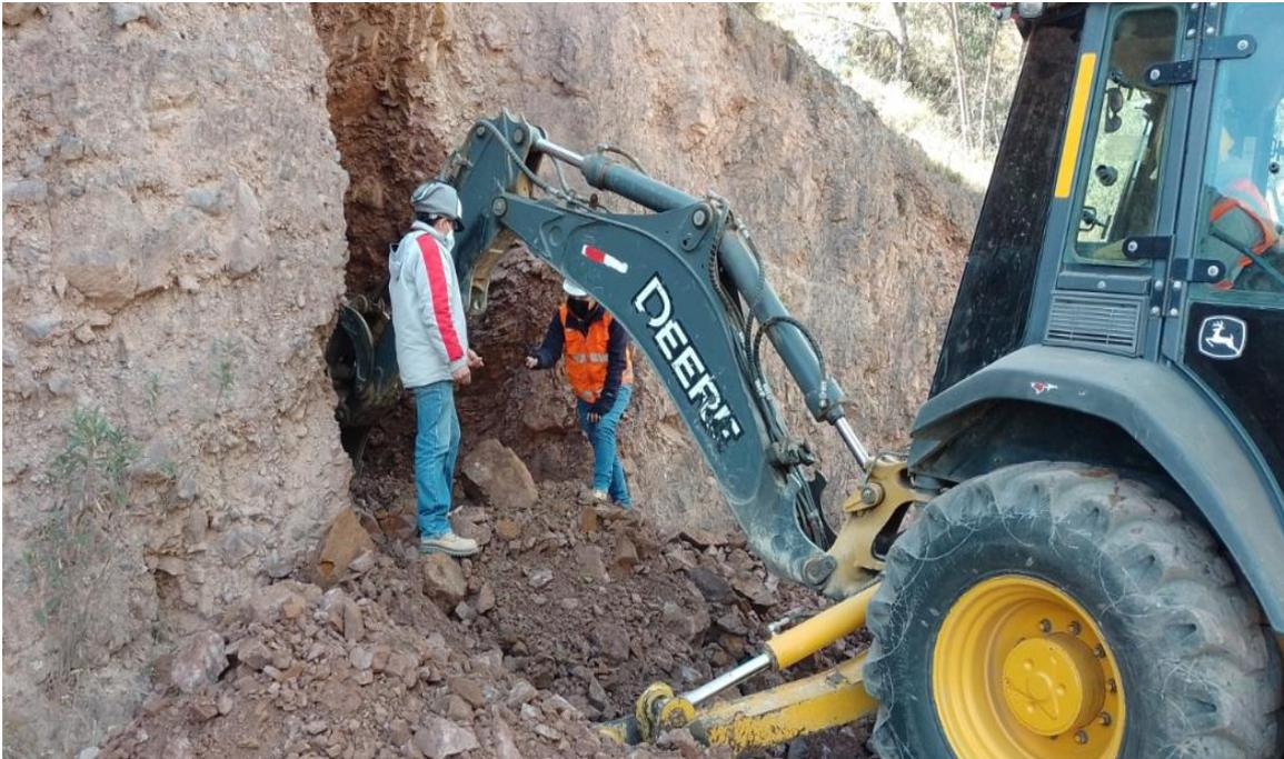
**Figura 85.** Toma de muestra según la Guía para muestreo de suelos y rocas (MTC E 101) –
