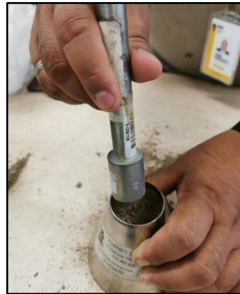
Figura N° 68 Apisonamiento del Agregado Fino
