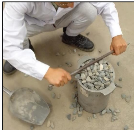
Figura N° 42 Retiro del Exceso del Material
