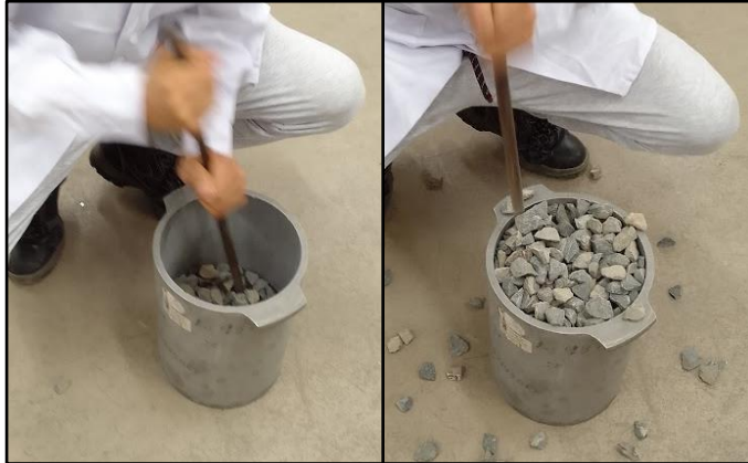
Figura N° 45 Apisonamiento del Agregado Grueso
