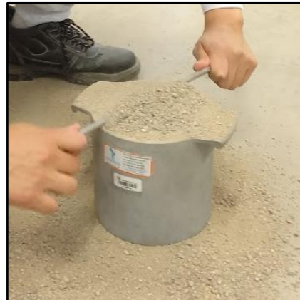
Figura N° 55 Retiro de Exceso de Material
