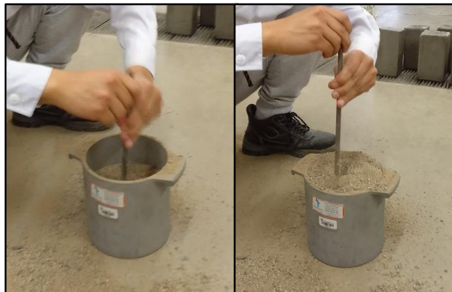
Figura N° 54 Apisonamiento del Agregado Fino
