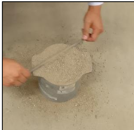
Figura N° 50 Retiro de Exceso del Material
