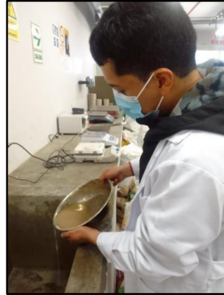
Figura N° 66 Decantación del Agua del Agregado Fino
