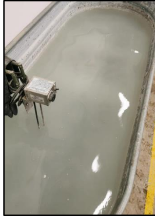
Figura N° 85 Reposo de los Especímenes en la Piscina de Curado
