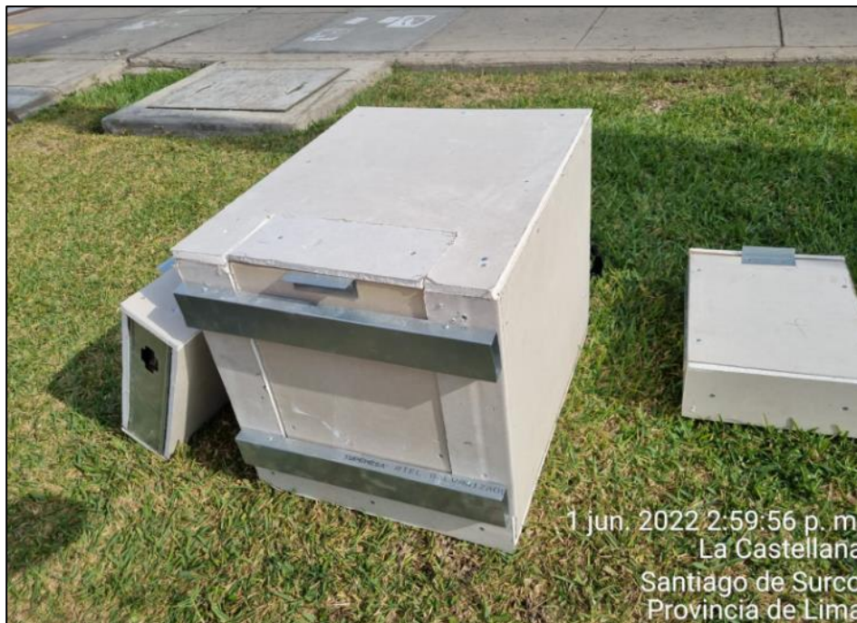
Figura 17: Medición de absorción de ruido de tabique tipo estándar sin relleno acústico
