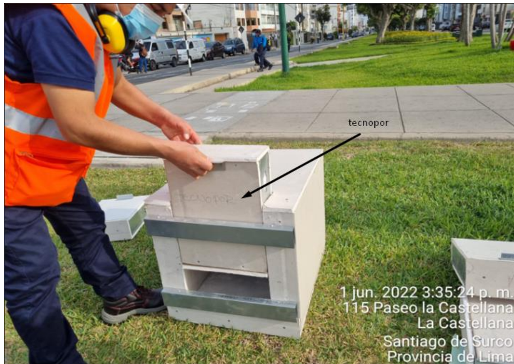
Figura 33: Medición de absorción de ruido del tabique tipo estándar con relleno de Tecopor
