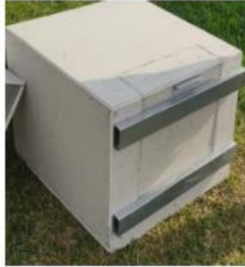
Fotografía 3 Medición con el tabique de lana de vidrio Fuente: Propia
