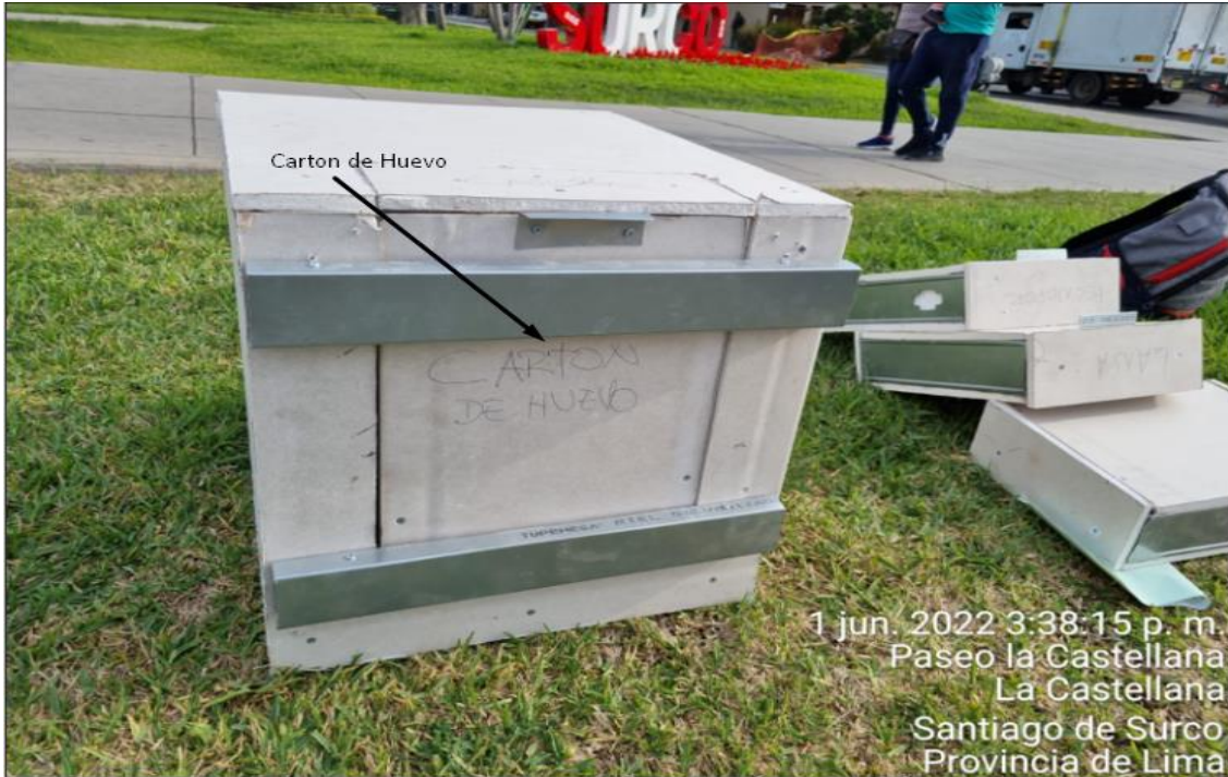
Figura 34: Medición de absorción de ruido con tabique tipo estándar con cartón de huevo
