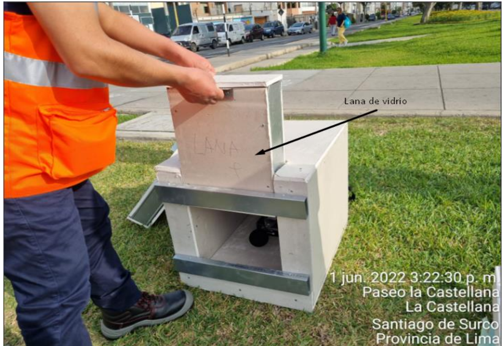
Figura 21: Medición de absorción de ruido con tabique tipo estándar con relleno de lana de vidrio
