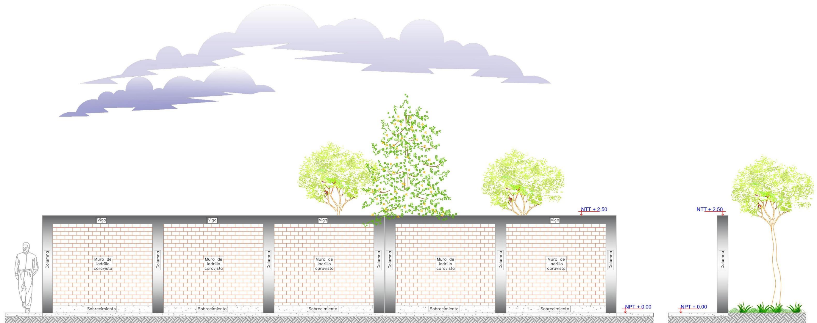
ELEVACIÓN DE MURO PERIMÉTRICO EN ALBAÑILERÍA- LONGITUD: 14.70 m ESCALA: 1/30
