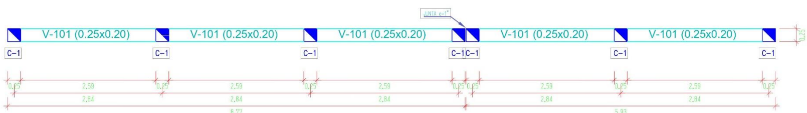
PLANTA DE CIMENTACIÓN DEL MURO PERIMÉTRICO EN ALBAÑILERÍA- LONGITUD: 14.70 m ESCALA: 1/30
