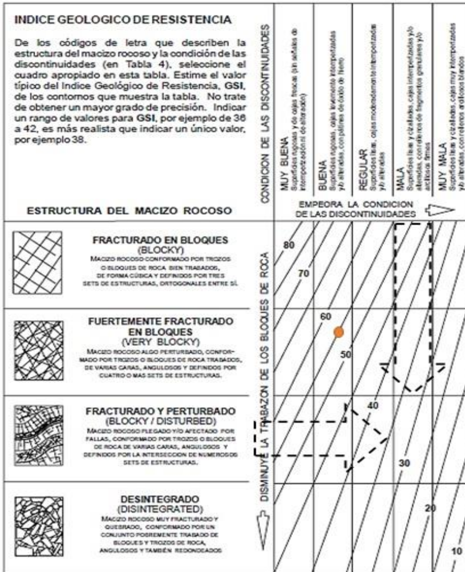
Figura:15 Ploteo del Valor de GSI, en función de las estructuras y condiciones de las discontinuidades; en el cual se aprecia que el valor de GSI es 55
