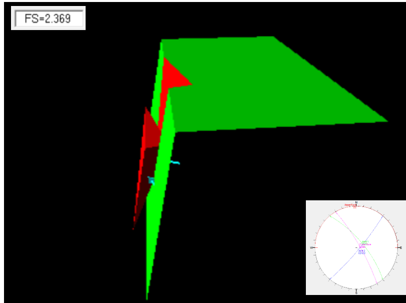
Figura N°39 Análisis del Factor de Seguridad por el modelo de Mohr coulomb, en la que se aprecia que el talud es estable en condiciones saturadas y estáticas con un Factor de seguridad de 2.369 por lo cual no se produce la falla en cuña en estas condiciones.
