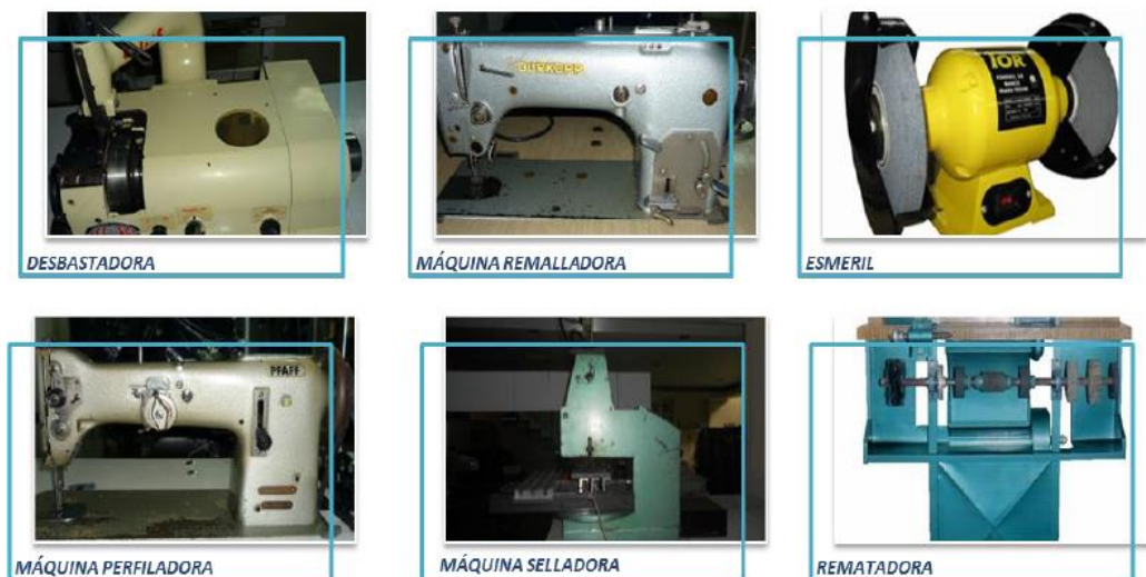
Figura 7. Maquinaria y equipos necesarios para la elaboración de calzado
