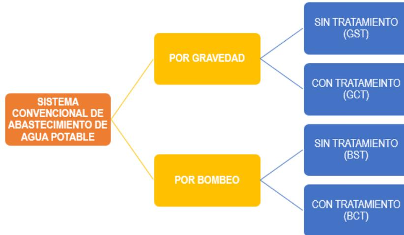
*Nota:* El esquema representa la clasificación que tiene un sistema convencional que abastece de agua potable a una determinada comunidad, este se puede clasificar por gravedad o por bombeo; y asimismo algunos reciben tratamiento y otros no. Fuente: Elaboración propia.
