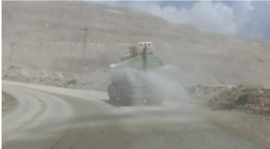
*Figura 13.* Riego de vías mediante cisternas.
