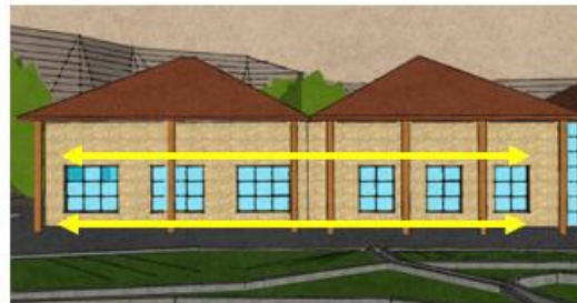
Empleo de volúmenes regulares con sustracciones horizontales ubicadas a una misma altura en zonas de uso público.
