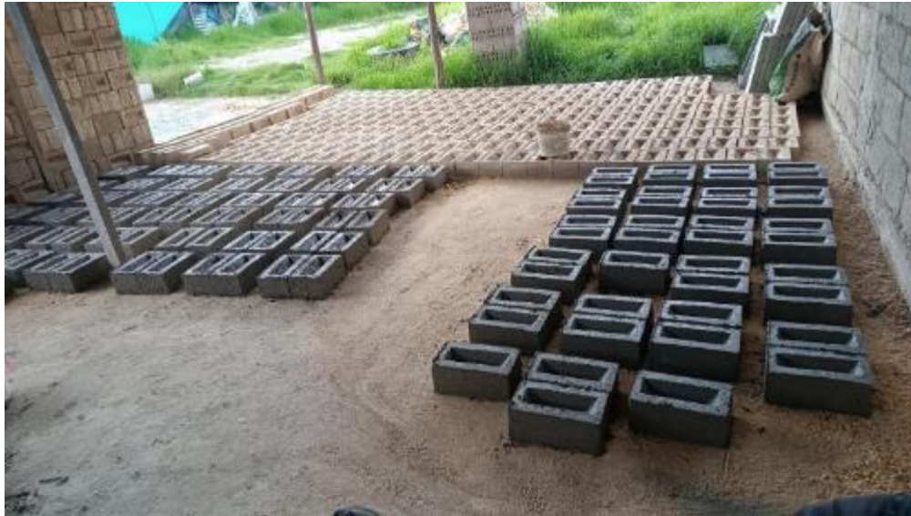
Figura 50 Curado de ladrillos
