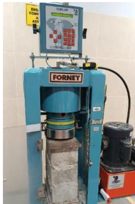
Figura 58 Ensayo de resistencia a la compresión de pilas de albañilería
