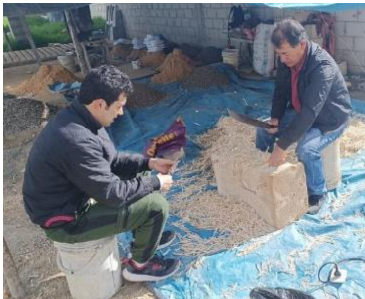
Figura 38 Preparado de fibra de bagazo de caña con 13-70mm de largo y espesor de 0.25 – 1.5mm
