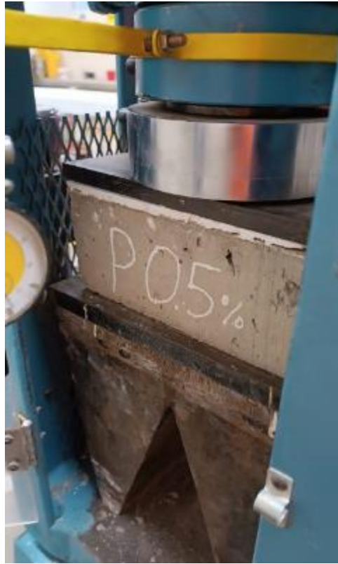
Figura 58 Ensayo de resistencia a la compresión de pilas de albañilería
