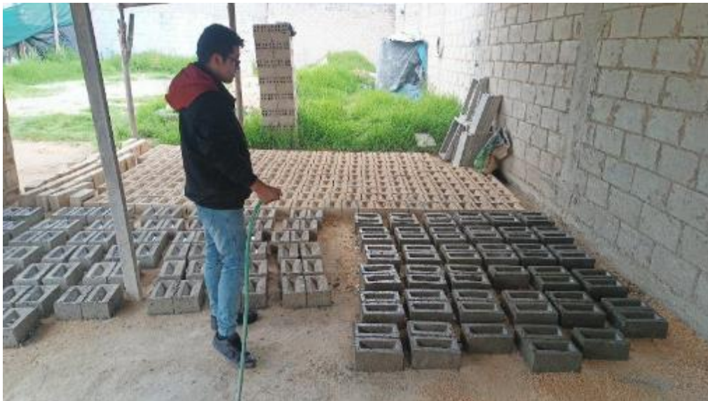
Figura 50 Curado de ladrillos
