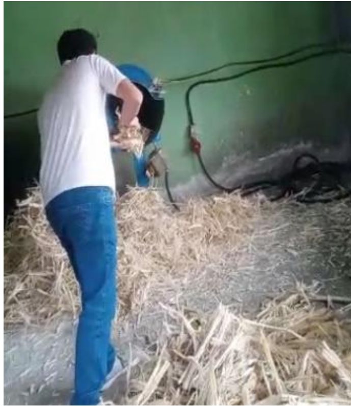
Figura 38 Preparado de fibra de bagazo de caña con 13-70mm de largo y espesor de 0.25 – 1.5mm
