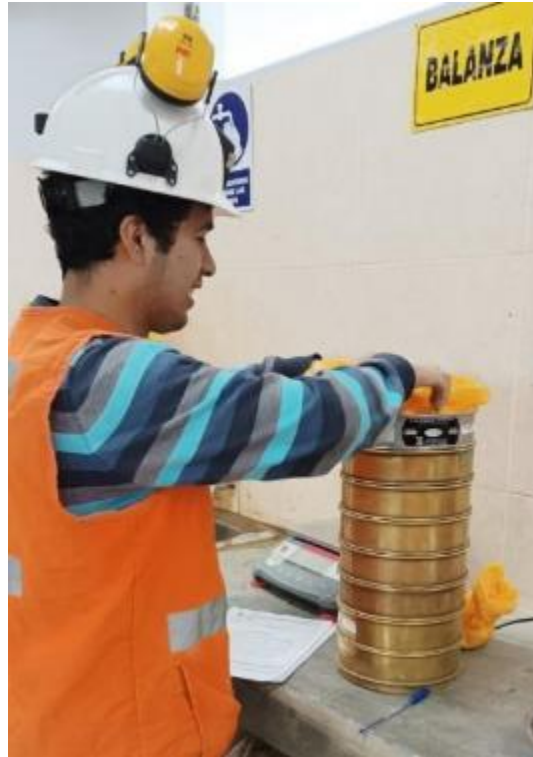
Figura 18 Ensayo de granulometría de agregados. - peso retenido en tamiz
