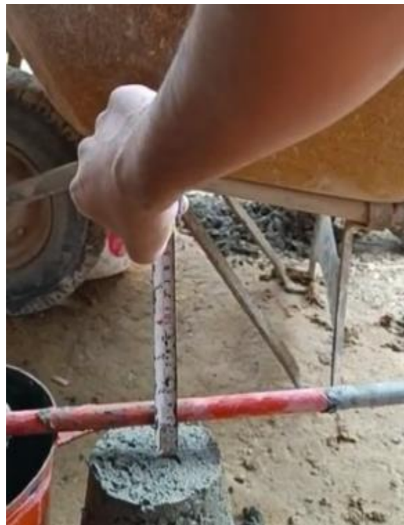
Figura 44 Medida del asentamiento de la mezcla
