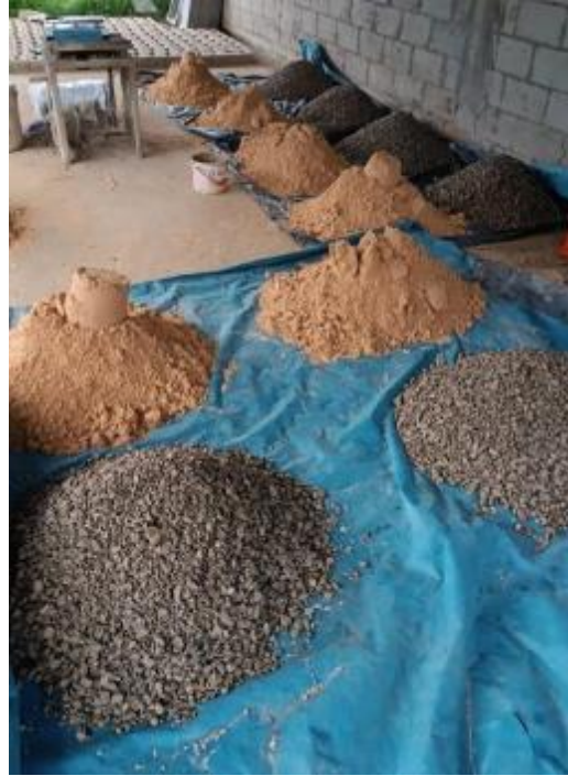
Figura 40 Preparado de la mezcla para cada porcentaje de fibra
