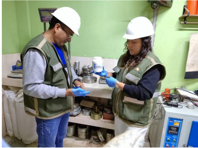
Fotografía 7: Adición de MgCl_2 en suelo natural
