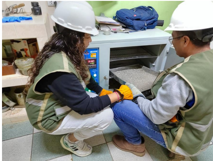
Fotografía 3: Material natural en horno para el contenido de humedad
