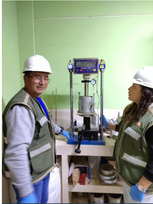
Fotografía 9: Ensayo de CBR adicionado al 3% MgCl_2
