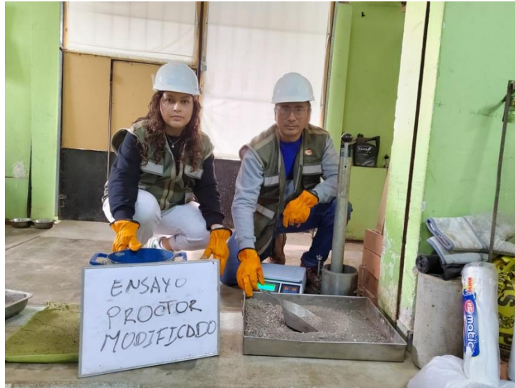
Fotografía 5: Ensayo Proctor del terreno natural
