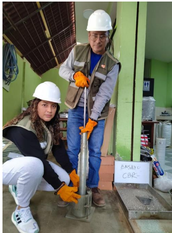
Fotografía 6: Elaboración de compactado en ensayo CBR
