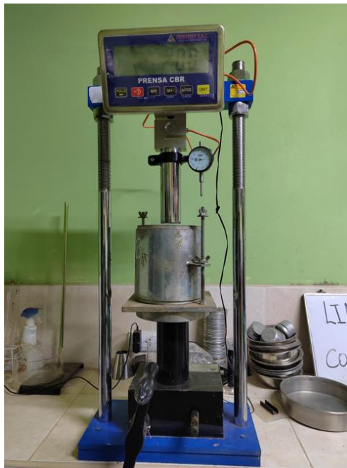
Fotografía 8: Ensayo de CBR adicionado MgCl_2
