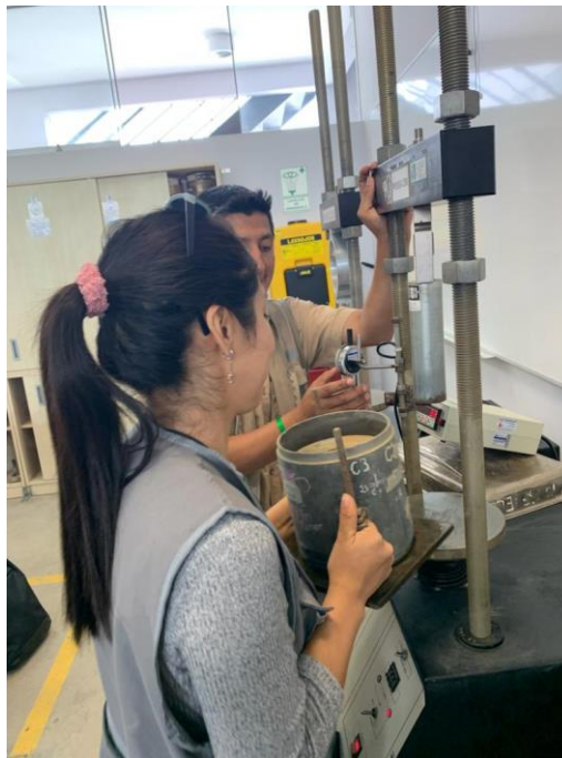
Colocación de muestras a la máquina de penetración para ensayo de CBR.
