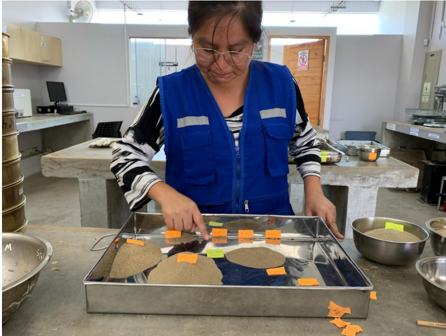
Separación de muestras tamizadas por proceso de análisis granulométrico.
