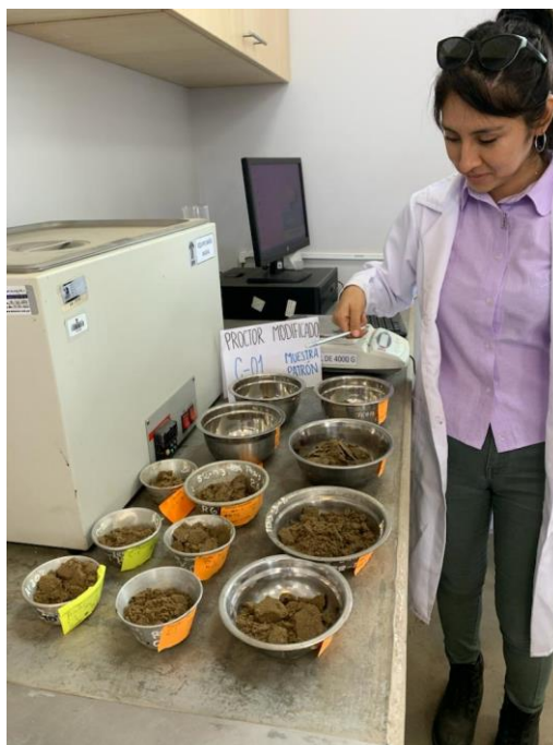
Muestras húmedas previamente a ser colocadas en el horno para contenido de humedad para ensayo de Proctor Modificado
