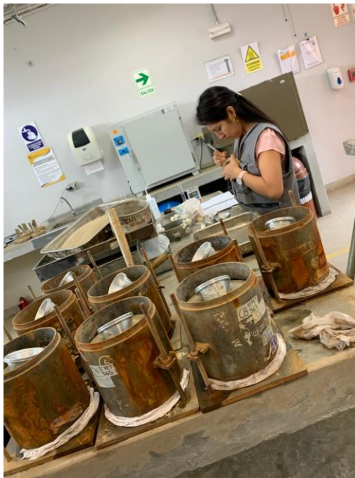
Muestras tras haber pasado por la máquina de penetración para ensayo de CBR.
