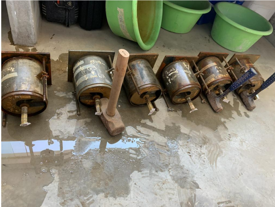
Drenado de muestras para ensayo de CBR.
