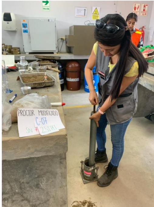
Compactación de muestra natural más adición de PET al 2.5 % para ensayo de Proctor Modificado.
