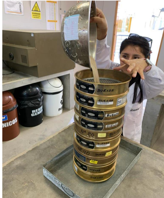
Material siendo colocado en los tamices para el análisis granulométrico.
