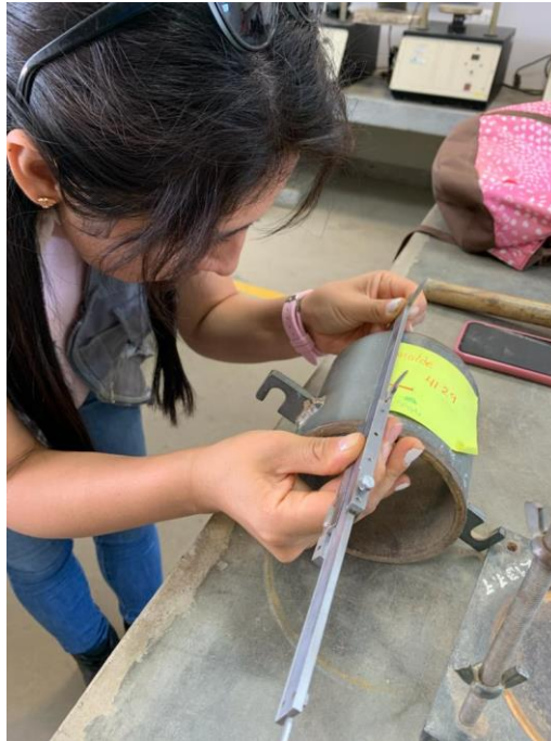
Medidas de dimensiones de molde de 4" para ensayo de Proctor Modificado.
