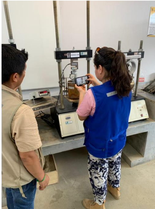
Ensayo de penetración para ensayo de CBR.
