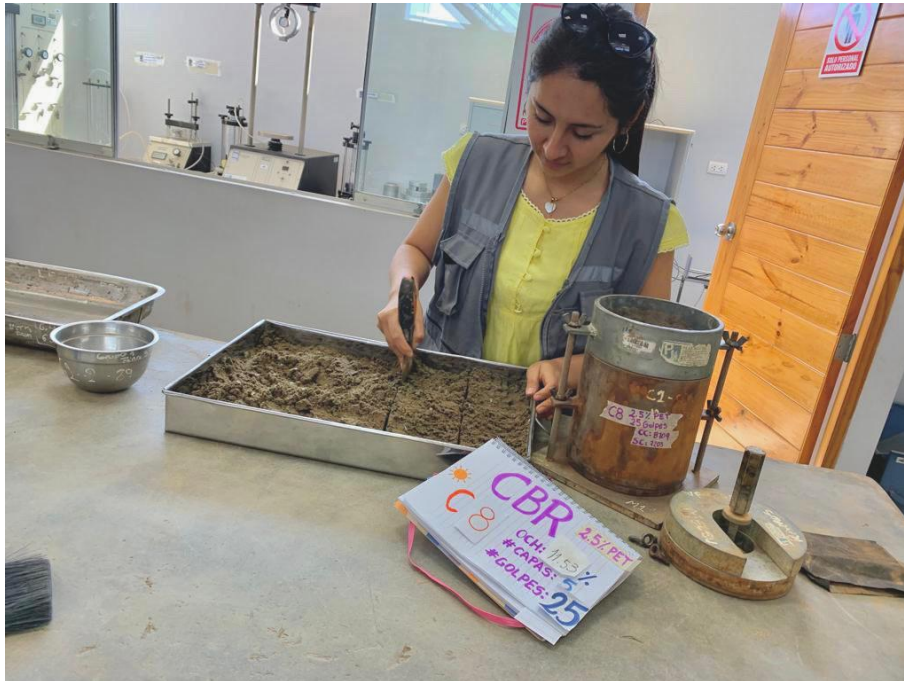
Cuarqueo de material para ser colocado en el molde de CBR.
