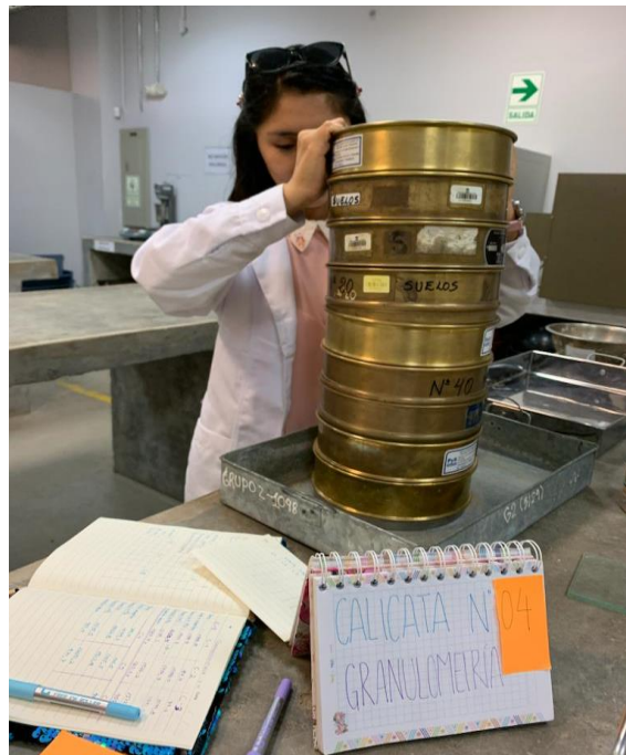
Tamizado de material para ensayo de análisis granulométrico.
