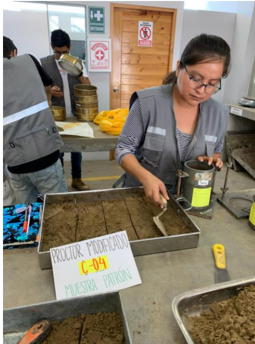
Cuarqueo de material para ser colocado en el molde de Proctor Modificado.
