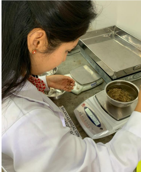
Pesado de muestra natural para la obtención de contenido de humedad
