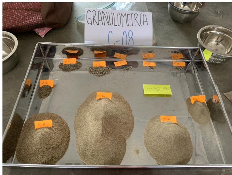
Separación de muestras tamizadas por proceso de análisis granulométrico de la calicata N° 08.
