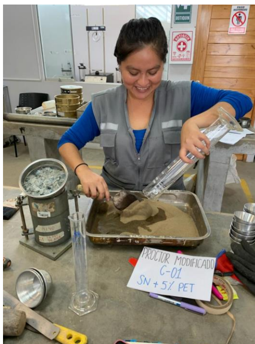
Adición de agua destilada a la muestra natural más la adición de PET al 5 % para ensayo de Proctor Modificado.
