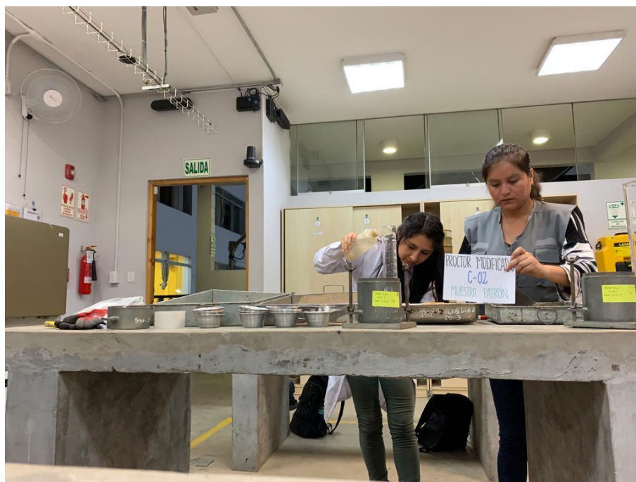
Colocación de agua destilada a las muestras para ensayo de Proctor Modificado.
