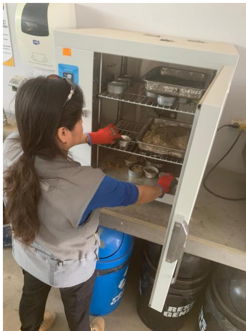
Colocación de muestra natural en el horno por 24h para contenido de humedad.
