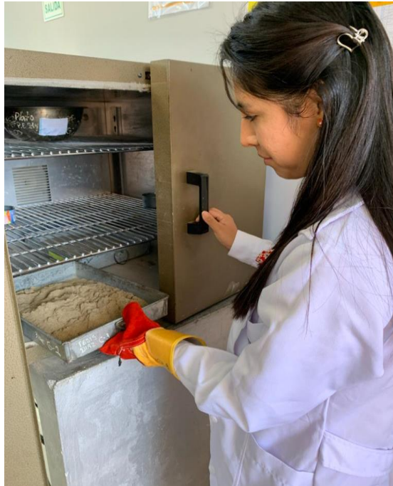
Retiro de muestra del horno para ensayo de análisis granulométrico.
