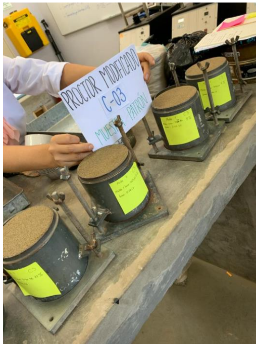
Muestras rasadas en el molde de Proctor Modificado post compactación.
