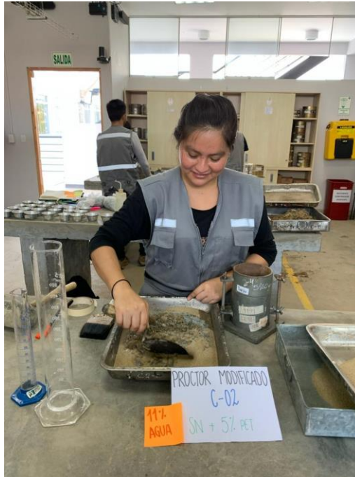
Mezclado de muestra natural más la adición de PET al 5 % para ensayo de Proctor Modificado.
