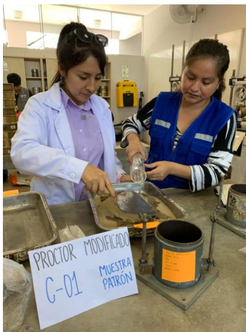
Proceso de ensayo de Proctor Modificado.
