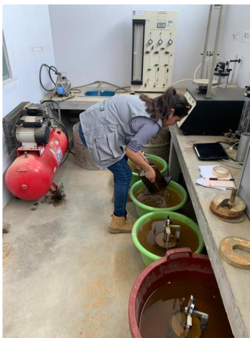
Muestras siendo sumergidas para la prueba de inmersión para ensayo de CBR.
