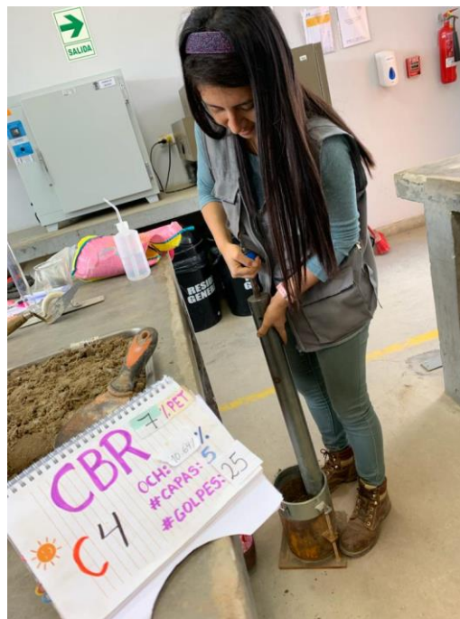
Compactación de muestra natural más adición de PET al 7 % para ensayo de CBR.
