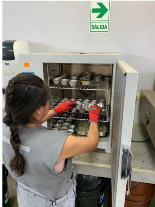
Muestras siendo colocadas en el horno para la obtención de contenido de humedad para ensayo de Proctor Modificado.
