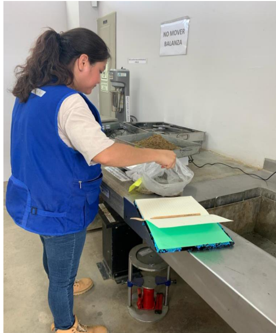
Peso del material natural húmedo para ser colocado en el horno para ensayo de análisis granulométrico
