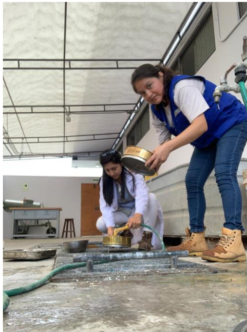
Lavado de material fino por malla #200 para ensayo granulométrico
