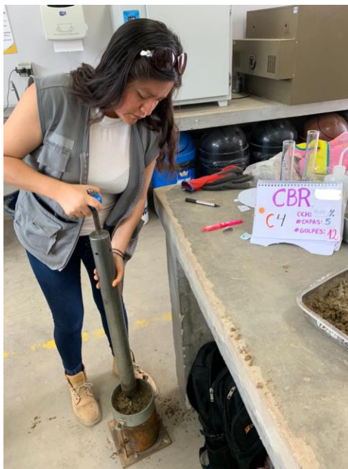
Compactación de muestra natural de la calicata N° 04 para ensayo de CBR.
