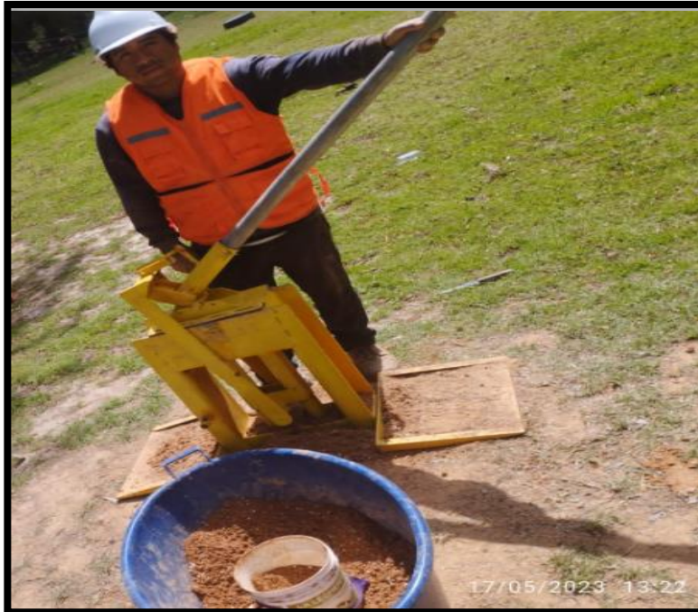
Fotografía N°17: Preparación de tierra con adición de plásticos para fabricación de adobe compactado.
