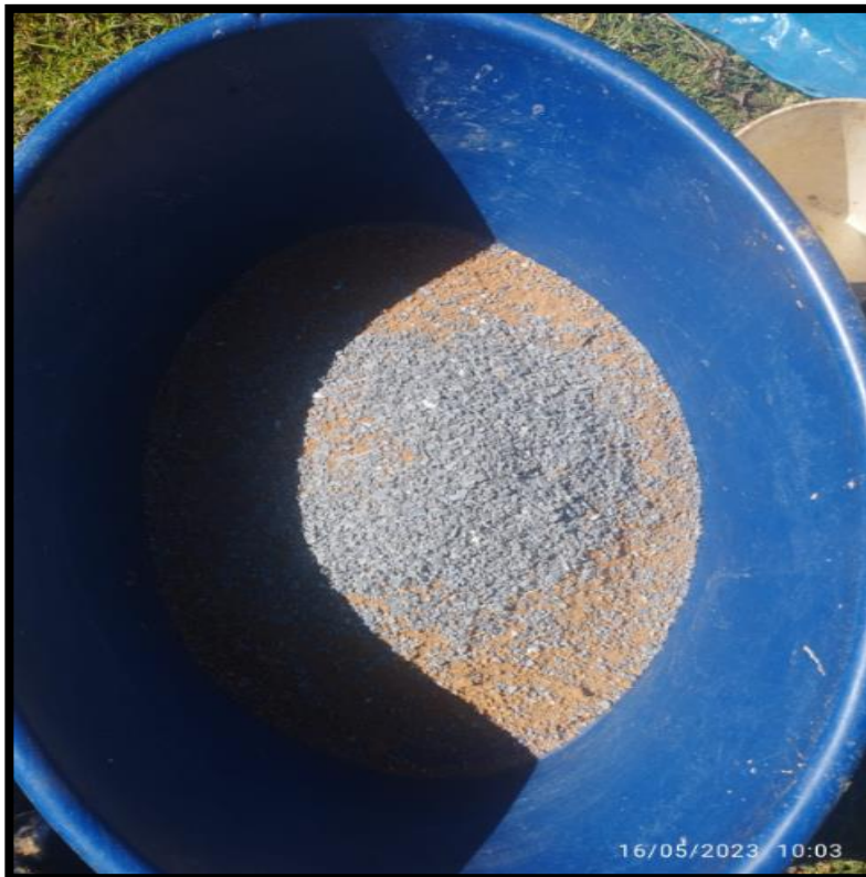
Fotografía N°16: Preparación de tierra con adición de plásticos para fabricación de adobe compactado.
