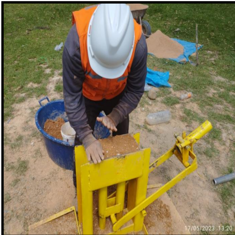
Fotografía N°18: Colocación de tierra en la máquina que fabrica adobe compactado.
