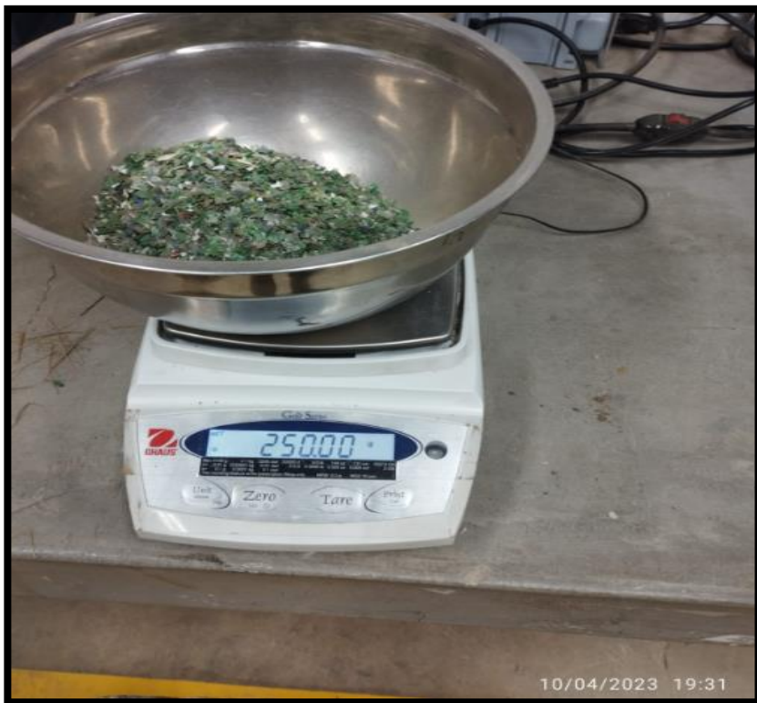
Fotografía N°12: Peso de plásticos para ensayo de Proctor Modificado.
