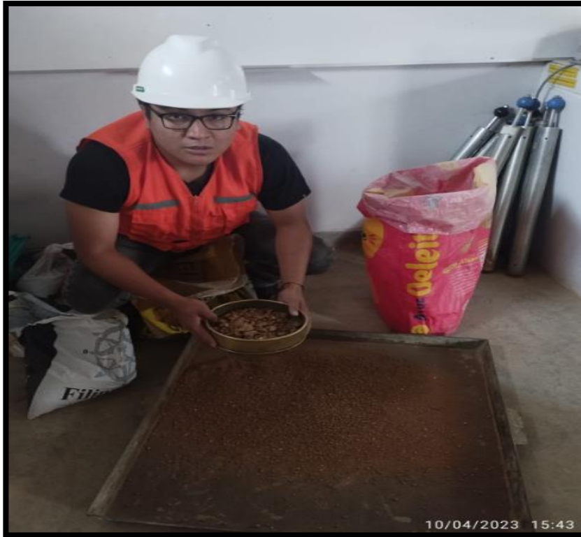
Fotografía N°11: Preparación de material en laboratorio, material tamizado por la malla N°4.
