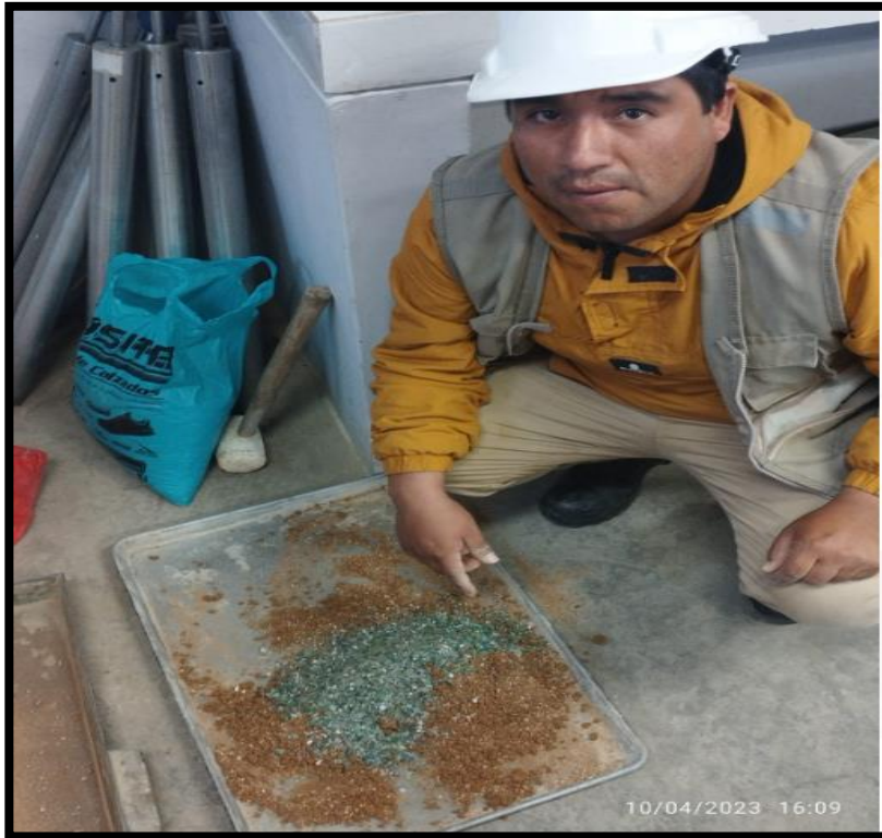
Fotografía N°13: Adición de plástico a la tierra para análisis de Proctor Modificado.
