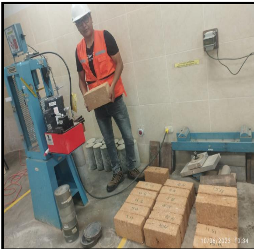
Fotografía N°22: Adobes compactados en laboratorio para ensayo de compresión.
