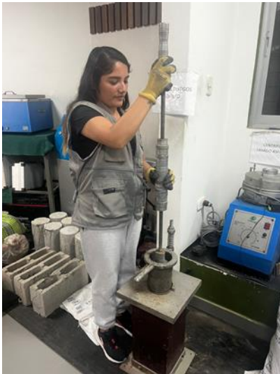
Preparación de briquetas para ensayo de Marshal
