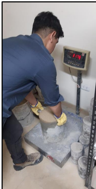
Imagen 4: Determinación de peso unitario en agregado fino
