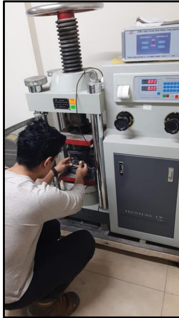
Imagen 15: Rotura de probeta para medición de elasticidad estática del concreto
