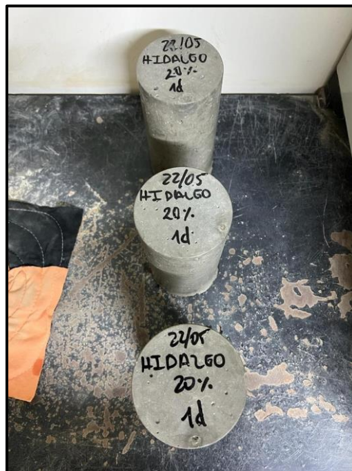
Imagen 12: Vista de probetas antes de rotura a 1 Día
