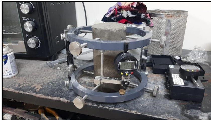
Imagen 14: Preparación de probeta para obtención de modulo de elasticidad
