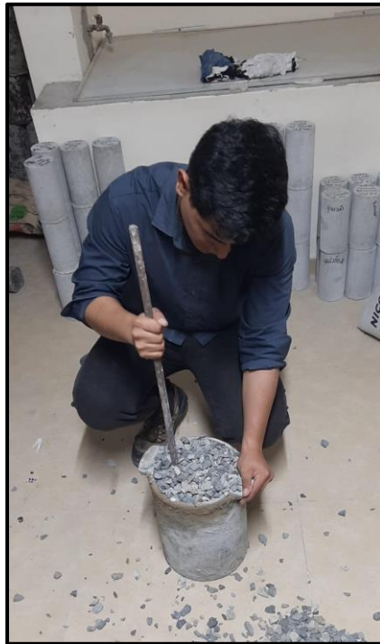
Imagen 3: Determinación de peso unitario en agregado grueso
