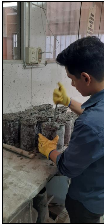
Imagen 11: Preparación de probetas de concreto
