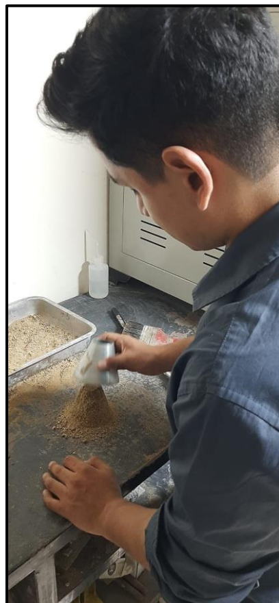
Imagen 6: Determinación de estado SSS de la arena
