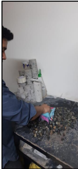
Imagen 7: Determinación de estado SSS de la piedra
