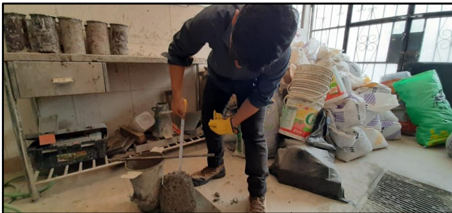
Imagen 10: Determinación de slump para concreto fresco
