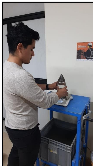
Imagen 8 Peso de picnómetro con agregado fino saturado
