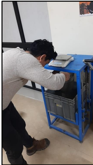
Imagen 9 Peso de piedra en balanza de flotabilidad
