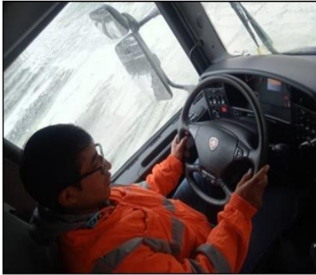
Posición de las manos en el volante del volquete 364 al momento de bajar la rampa a descarga Facilidades inferior
