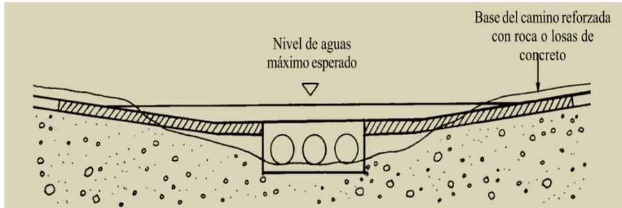
**Nota:** Esta figura nos indica en un extremo la base del camino reforzada con la losa de concreto y en el medio el baden los tubos de alcantarilla con un cauce ancho, esto es baden simple. Huamán, (2019).
