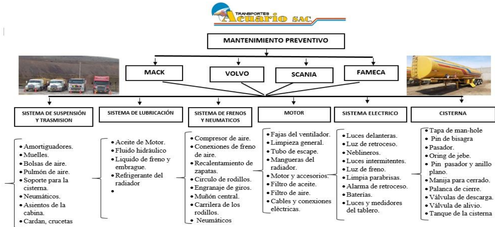
Figura 28. Principales fallas mecánicas en la flota de las unidades
