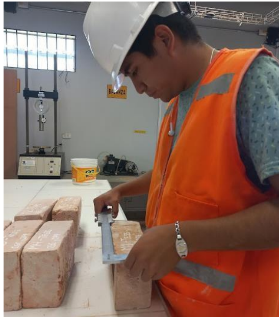
Figura 16: Medición de las unidades de albañilería
