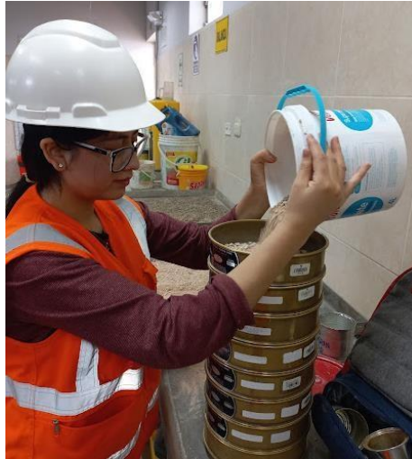
Figura 23: Tamizado de agregado fino
