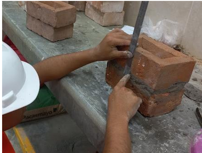
Figura 40: Medición de las juntas de mortero
