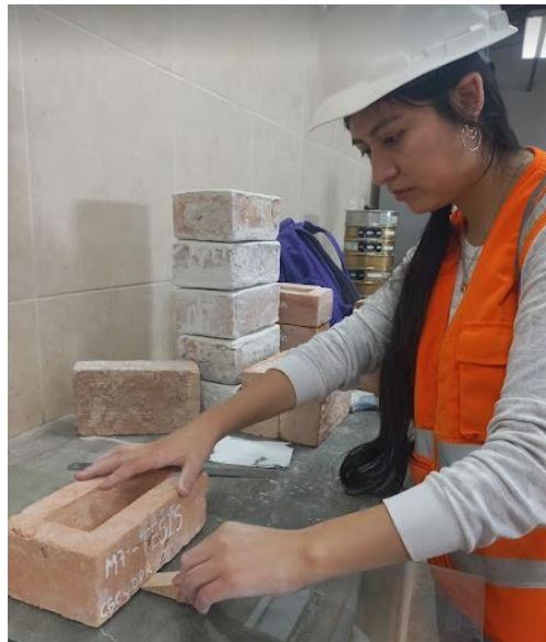
Figura 19: Alabeo de las unidades de albañilería
