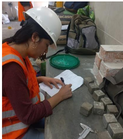
Figura 37: Medición de los cubos de morteros
