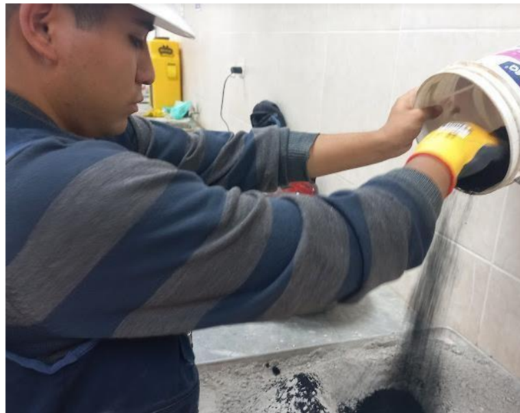
Figura 35: Colocación de caucho en la mezcla para los morteros
