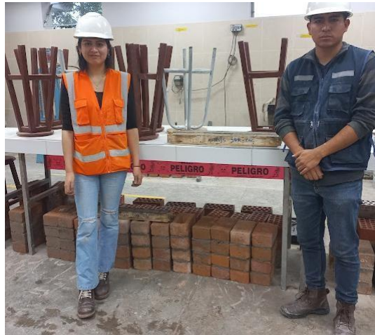
Figura 41: Pilas de albañilería realizadas
