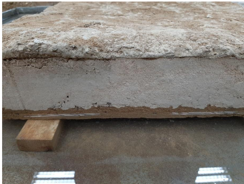
Adobe con la cara sumergida con tierra desprendiéndose.
