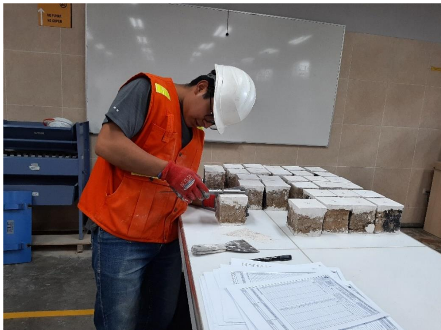
Medición de las caras del adobe con un vernier.
