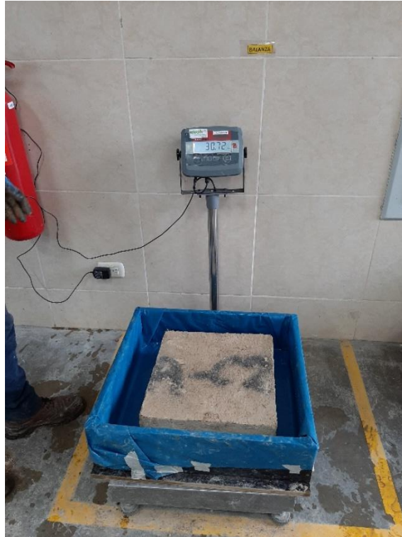
Pesaje del depósito con soportes de madera y adobe.
