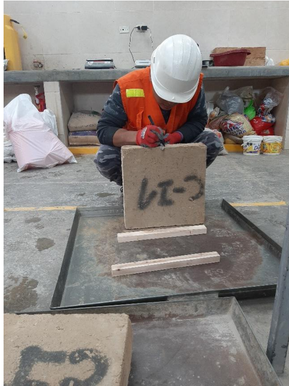
Colocación de soportes y marcación del nivel del agua en el adobe.
