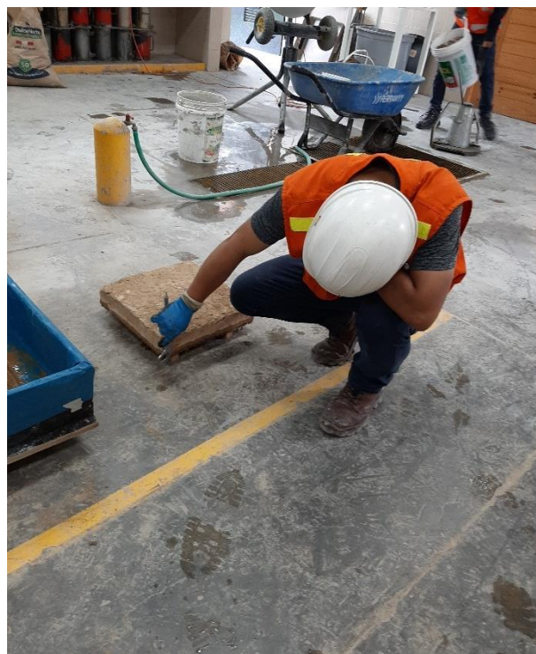
Medición de la huella de agua con vernier, lado 3.
