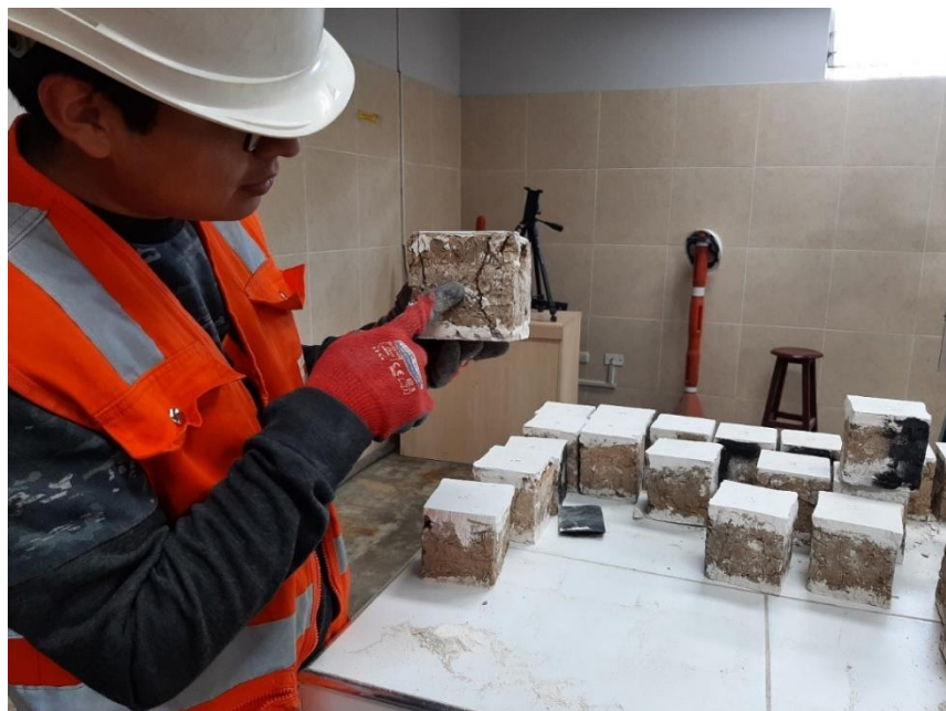
Identificación de grietas en un cubo después del ensayo.
