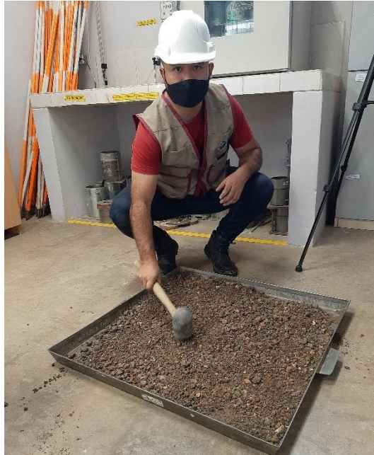
Preparación de muestra, triturado del suelo con un mazo de goma.
