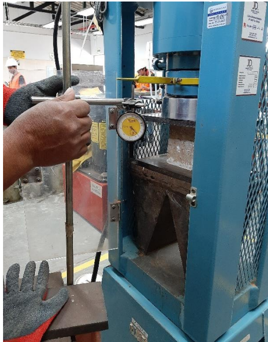
Calibración del deformímetro a la altura del cubo de adobe.
