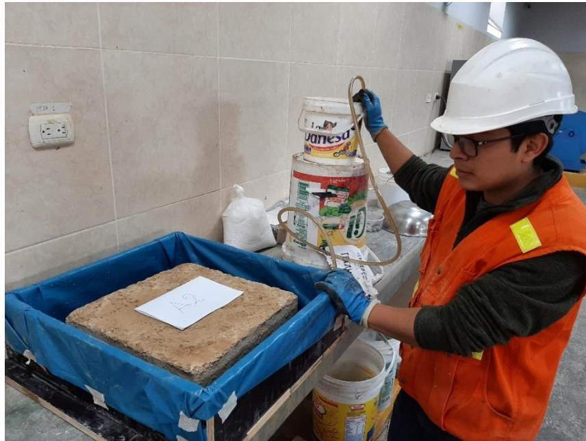
Llenado de agua al nivel requerido con ayuda de una manguera.
