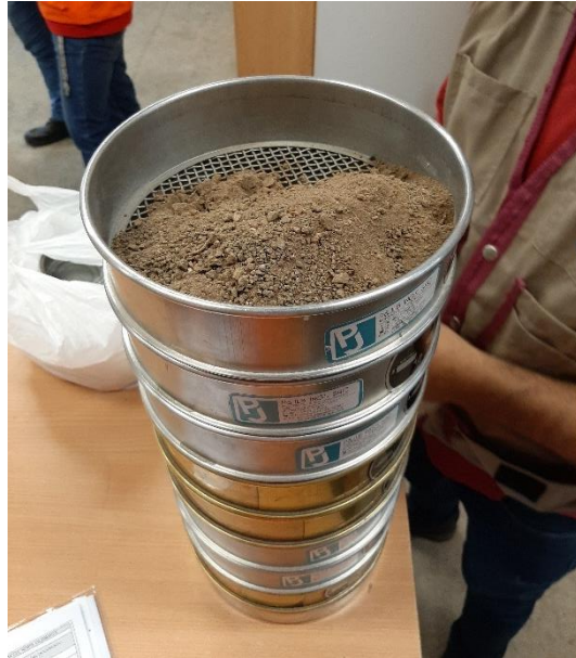
Tamizado de la muestra de suelo – tamizado en seco.
