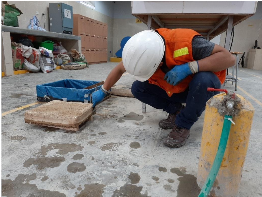
Medición de la huella de agua con vernier, lado 1.
