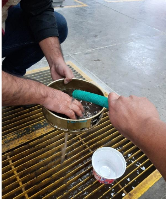
Lavado de muestra bajo el chorro de agua – granulometría por lavado.
