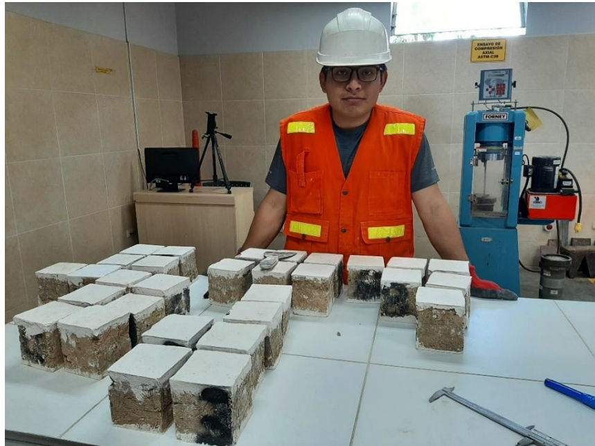
Cubos de adobe con una capa de yeso para nivelar su superficie.
