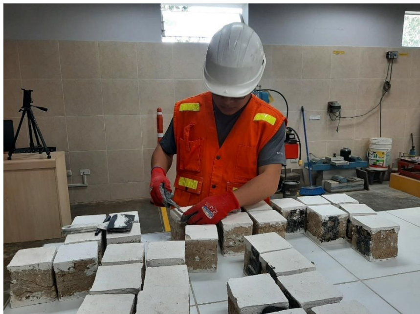
Medición del área de la superficie a compresión.
