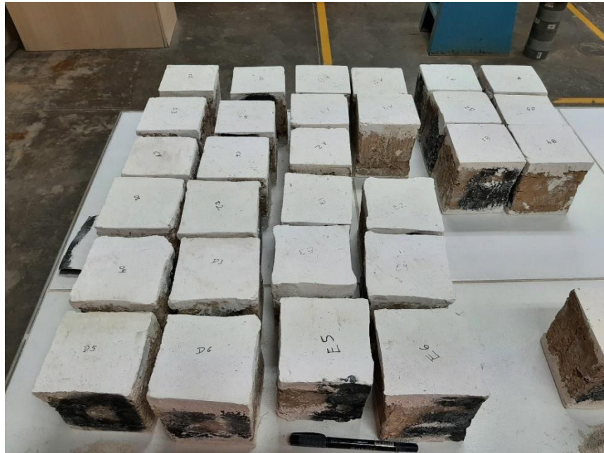
Cubos rotulados por cada espécimen listos para el ensayo.
