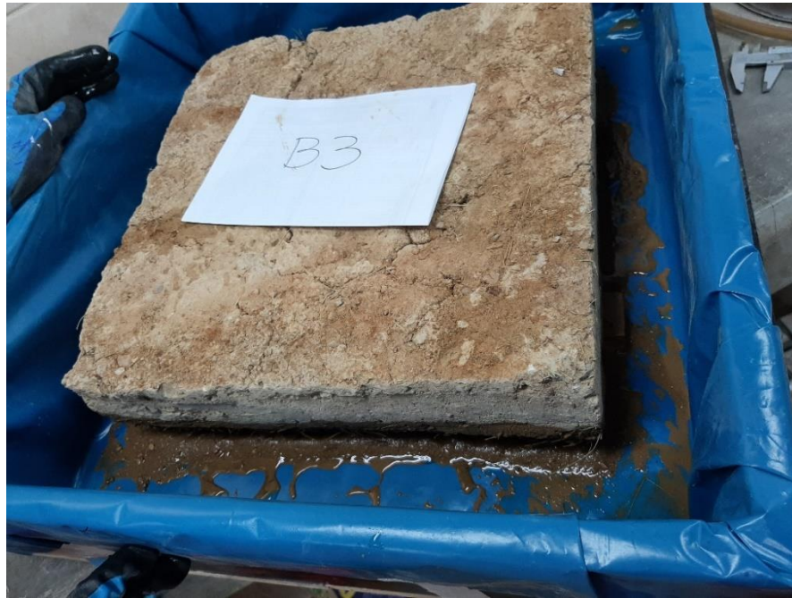
Deposito con adobe después de evacuar el agua lista para pesaje.
