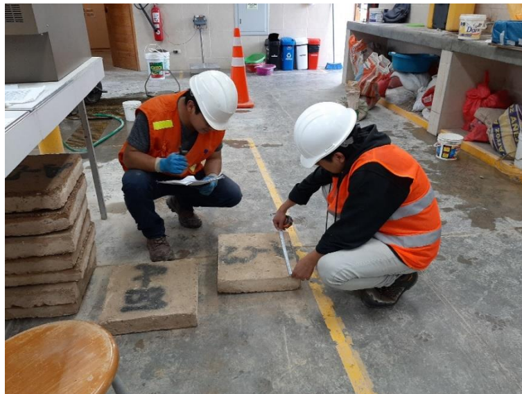
Medición de los lados del adobe para obtener el área.
