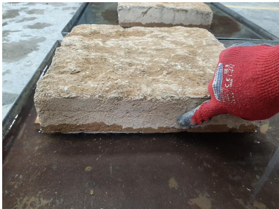
Verificación del nivel del agua constante.
