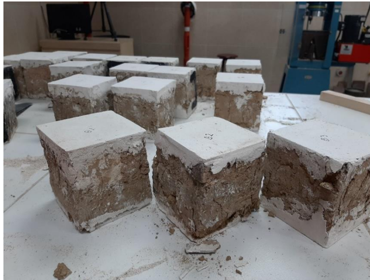
Cubos con presencia de grietas después de ser ensayados.
