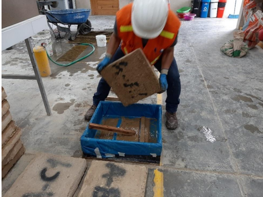
Adobe sin emulsión deteriorado por el agua.
