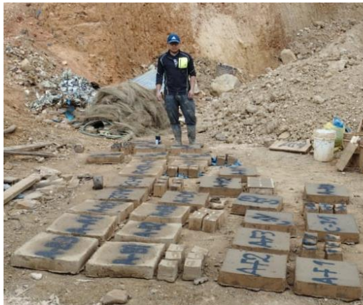
Culminación de los adobes con las diferentes dosificaciones.
