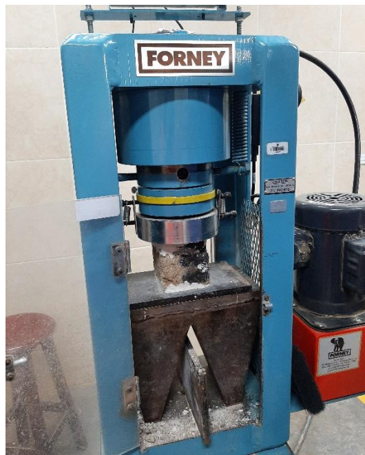
Ensayo de compresión axial en curso.
