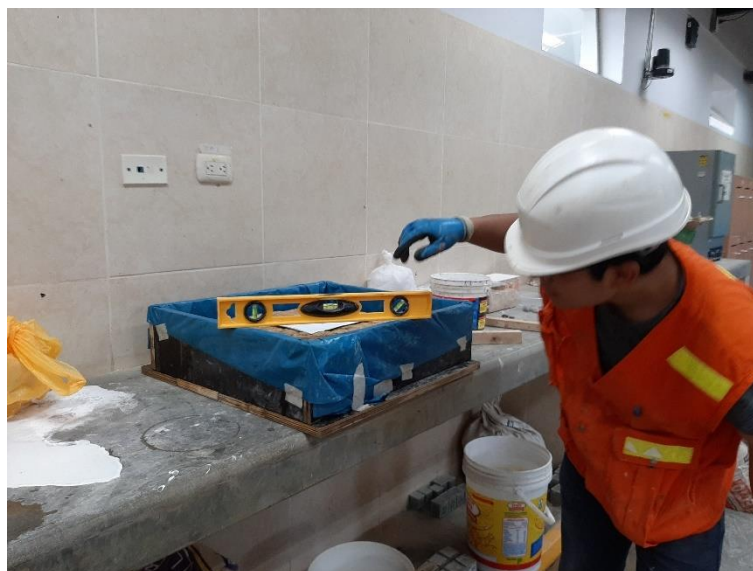
Nivelación del depósito para llenar el agua hasta el nivel requerido.
