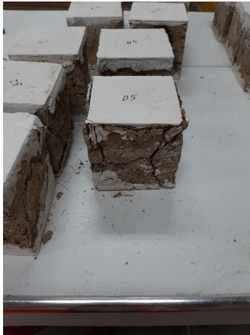
Adobes después del ensayo de compresión axial.
