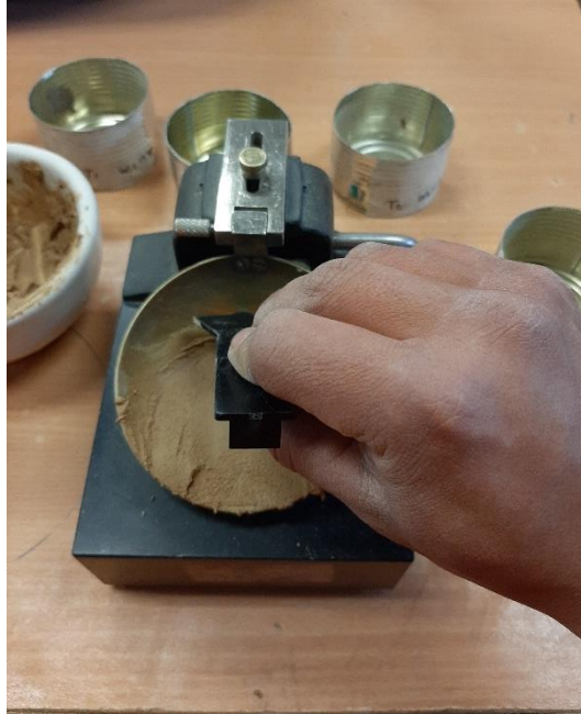
Acanalado la muestra – límites de plasticidad.
