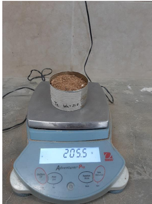
Pesaje de tara con muestra húmeda – contenido de humedad.
