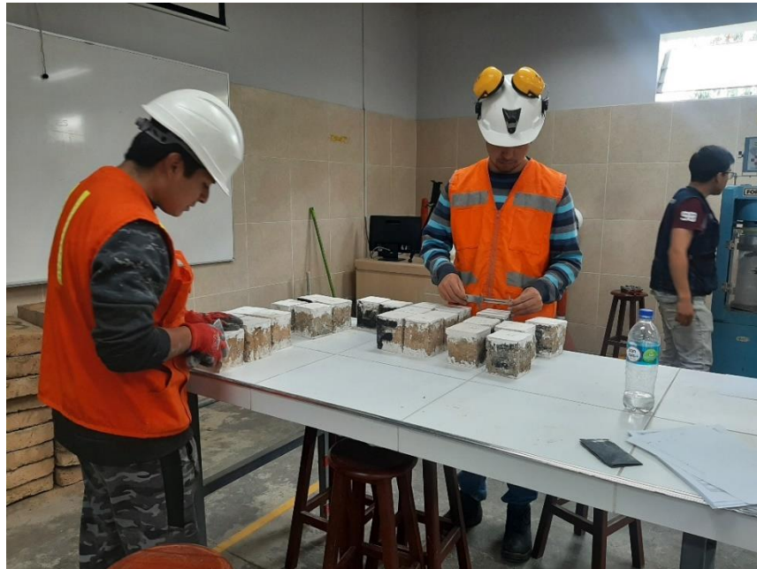
Perfilado y medición de bordes de cubos de adobe.
