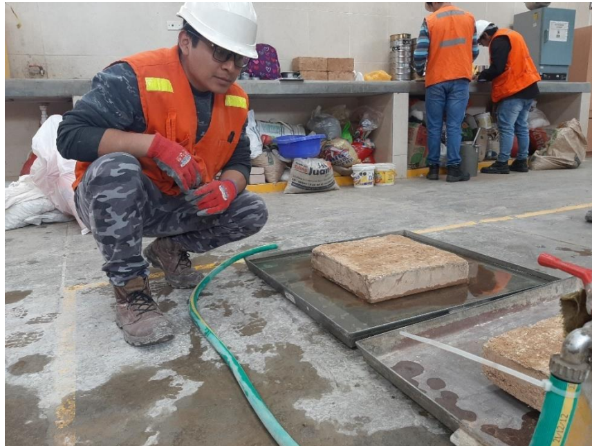
Llenado de la bandeja con agua hasta el nivel marcado en el adobe.
