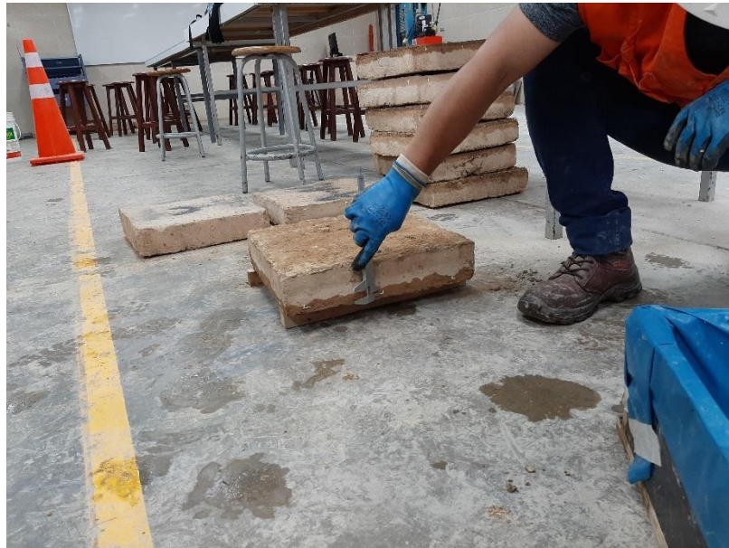
Medición de la huella de agua con vernier, lado 2.
