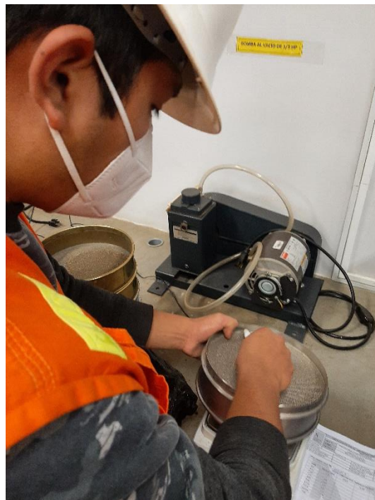
Pesaje de suelo retenido por cada tamiz – tamizado en seco.
