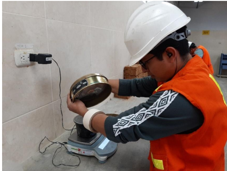
Tamizado y pesado de muestra seca – granulometría por lavado.
