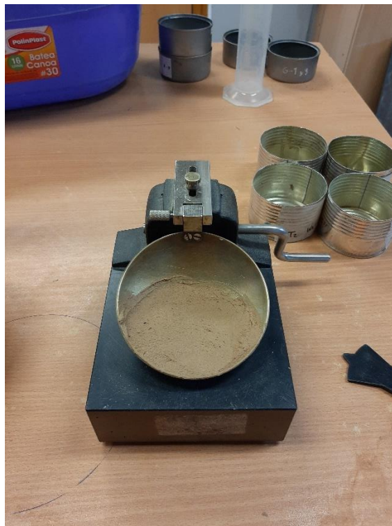
Llenado de la copa de Casagrande con la muestra – límites de plasticidad.
