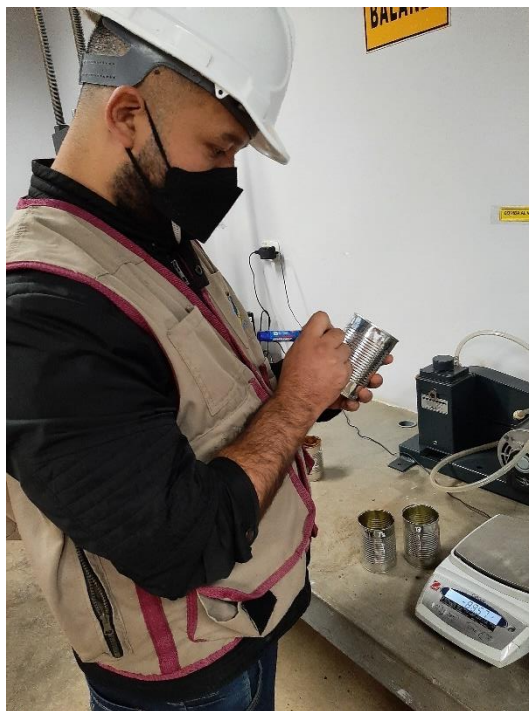
Identificación de la tara – granulometría por lavado.
