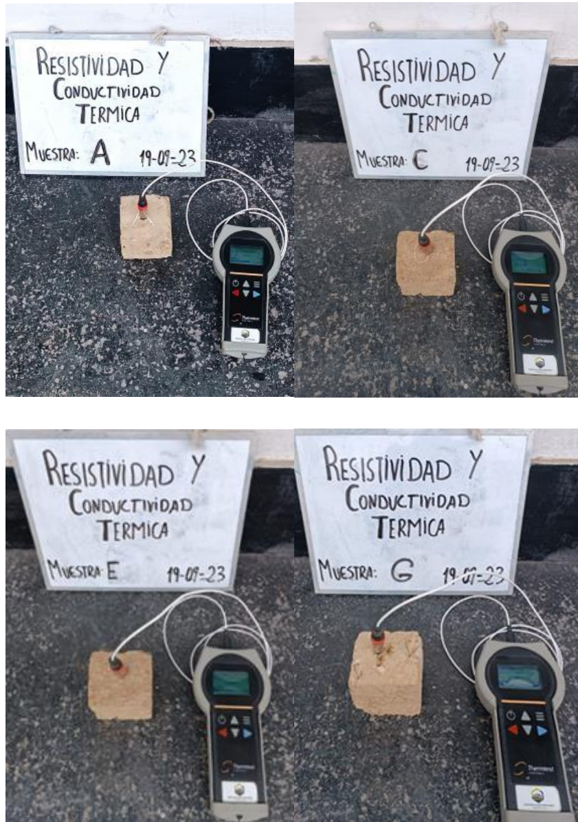
Lecturas de los especímenes con THERMTEST TLS-100
