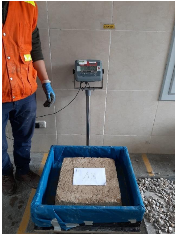
Pesaje de adobe más el depósito después del evacuar el agua.
