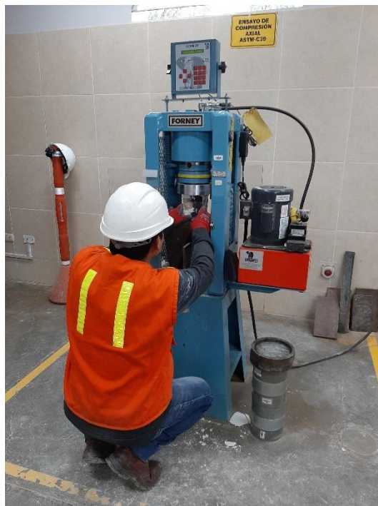
Colocación de cubos de adobe en la máquina de compresión axial.
