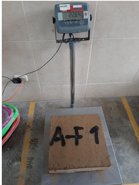
Pesaje de adobe luego de transcurrido el tiempo del ensayo.
