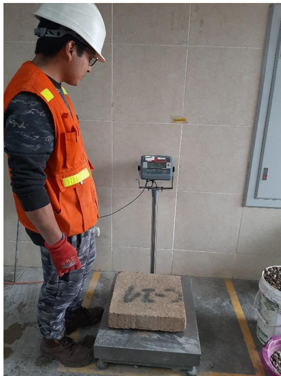
Pesaje de adobe para ensayo de absorción por capilaridad.
