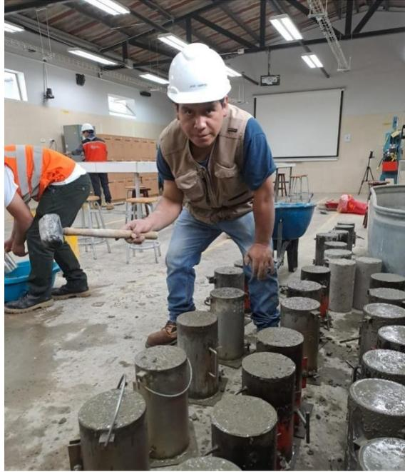
**FOTO 39:** Curado húmedo de las probetas a los 7, 14, 21 y 28 días.
