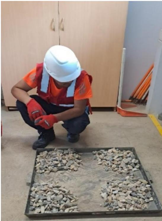
**FOTO 16:** Tamizado de los agregados.
