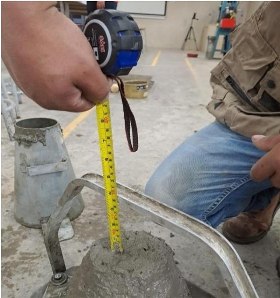
**FOTO 36:** Procedimiento de la prueba del SLUMP, concreto con 60% de agregado reciclado.
