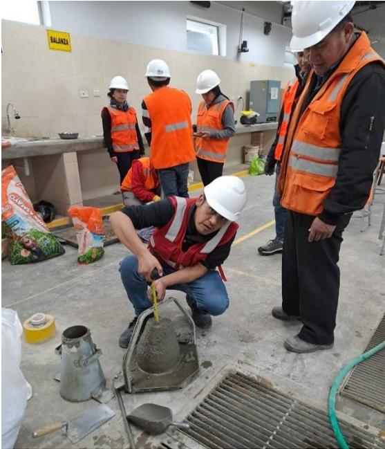
**FOTO 34:** Procedimiento de la prueba del SLUMP, concreto con 30% agregado reciclado.
