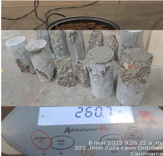
**FOTO 53:** Rotura de probeta con 45% agregado natural a los 21 días de curado.
