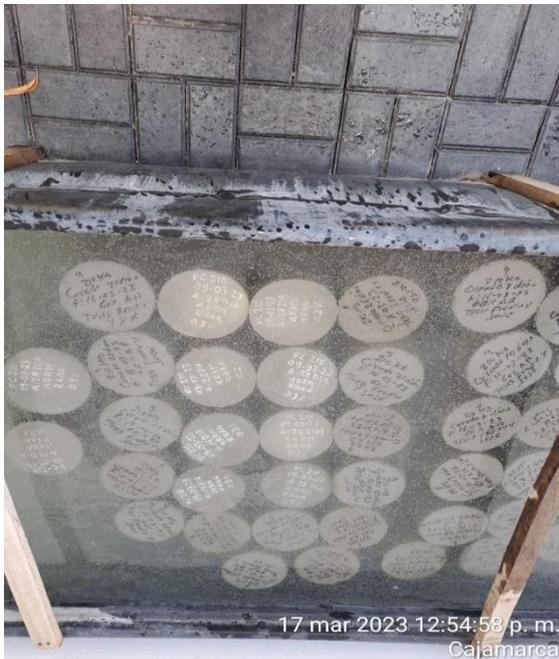
**FOTO 40:** Medición de diámetro de las probetas.
