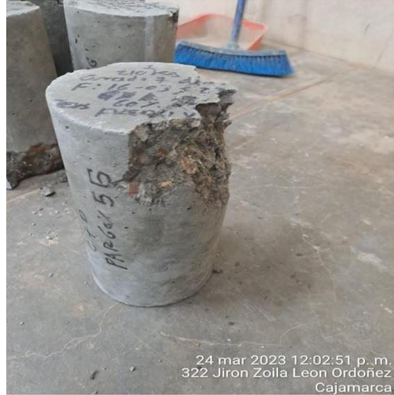
**FOTO 47:** Rotura de probeta con 100% agregado natural a los 14 días de curado.
