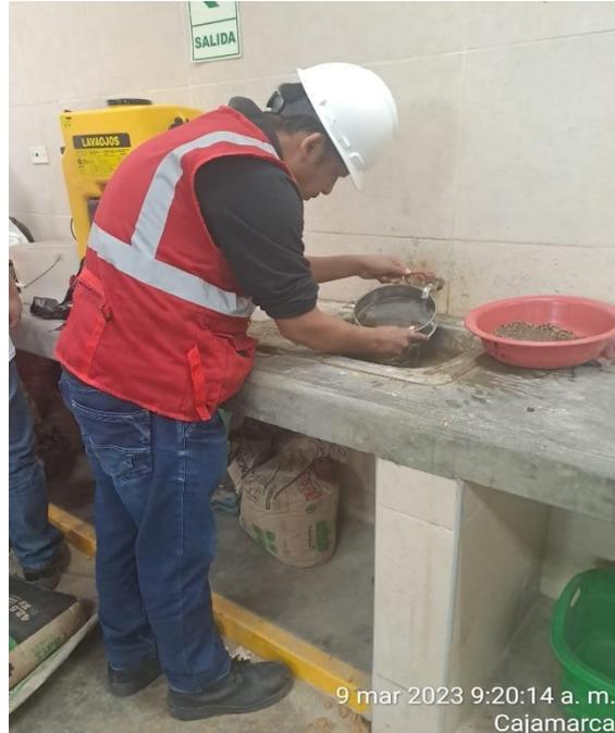
**FOTO 27:** Prueba de cono de Abrams para determinar si el material está saturado superficialmente seco.
