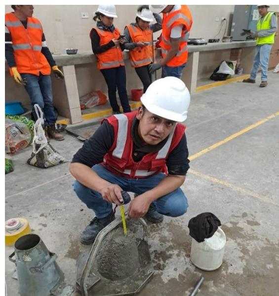
**FOTO 37:** Vaciado de concreto y chuseado en 3 capas con 25 golpes con la varilla.
