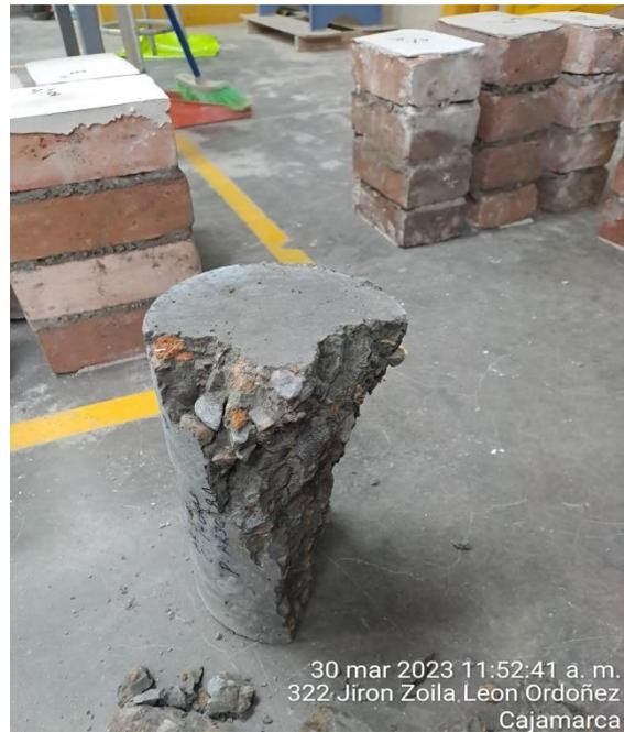
**FOTO 49:** Rotura de probeta con 45%
