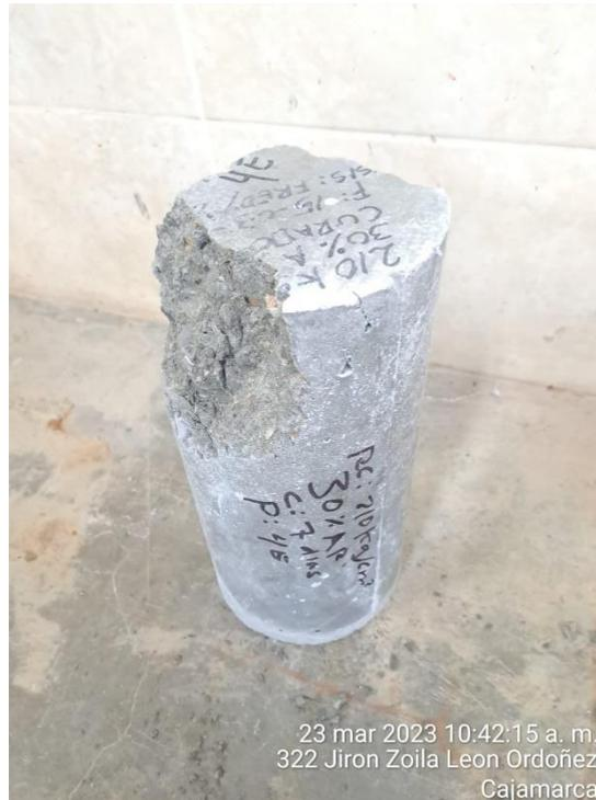
**FOTO 45:** Rotura de probetas con 45% de agregado reciclado a los 7 días.
