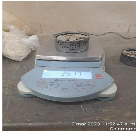
**FOTO 13:** Contenido de humedad agregado grueso reciclado húmedo.
