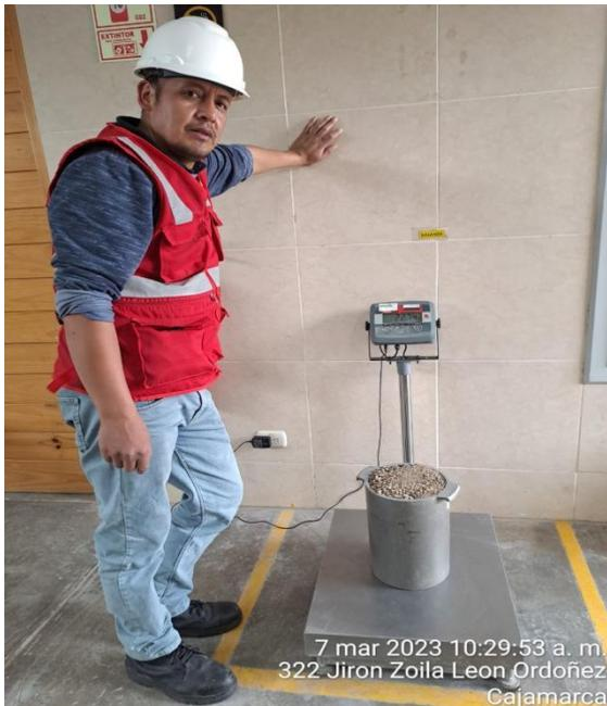
**FOTO 20:** Peso unitario compactado del agregado fino natural.
