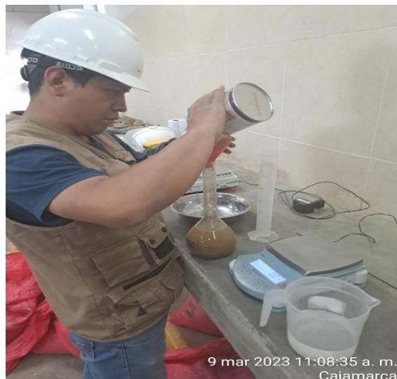
**FOTO 29:** Peso específico de la muestra
