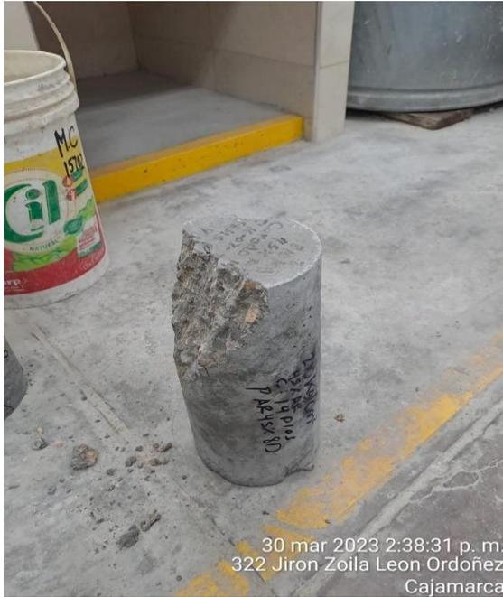
**FOTO 50:** Rotura de probeta con 60%
