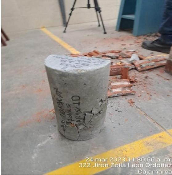
**FOTO 46** Rotura de probetas con 60% agregado reciclado a los 7 días.
