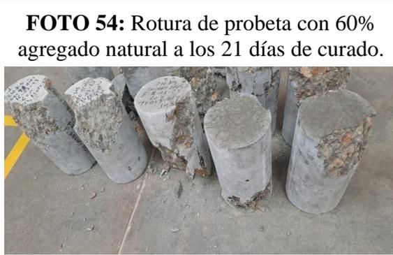
**FOTO 54:** Rotura de probeta con 60% agregado natural a los 21 días de curado.
