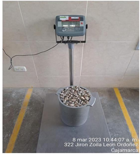
**FOTO 25:** Peso de la muestra para el material fino.
