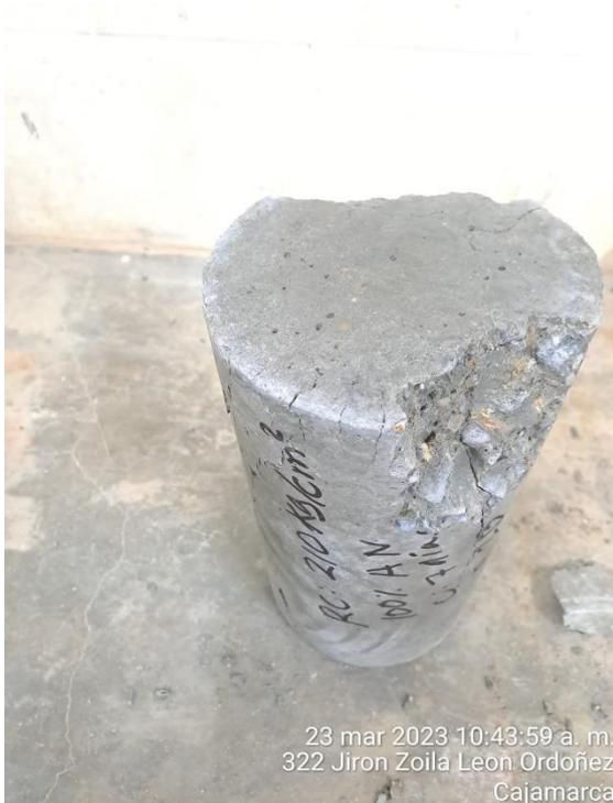
**FOTO 44:** Tipo de rotura de probetas de
