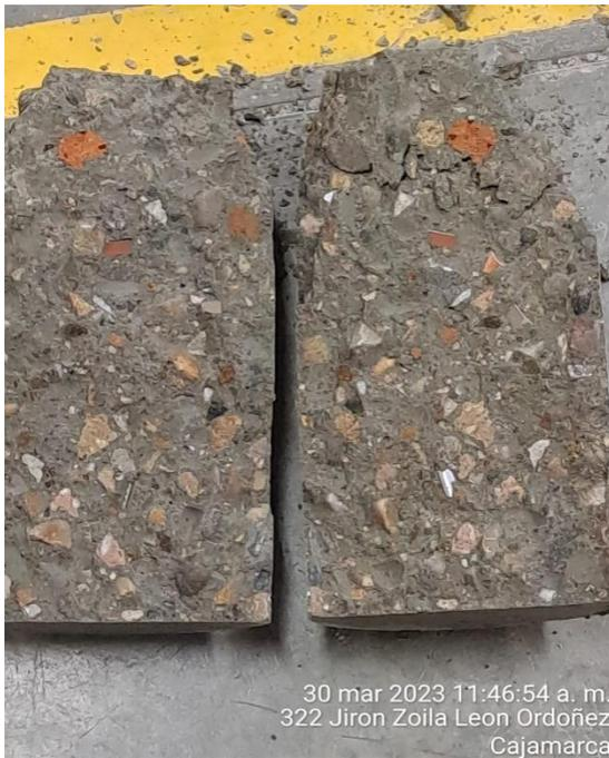
**FOTO 48:** Rotura de probeta con 30% agregado natural a los 14 días de curado.
