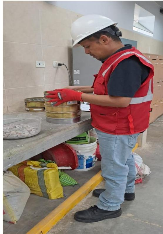
**FOTO 17:** Abrasión los ángeles, desgaste de los materiales agregados gruesos.
