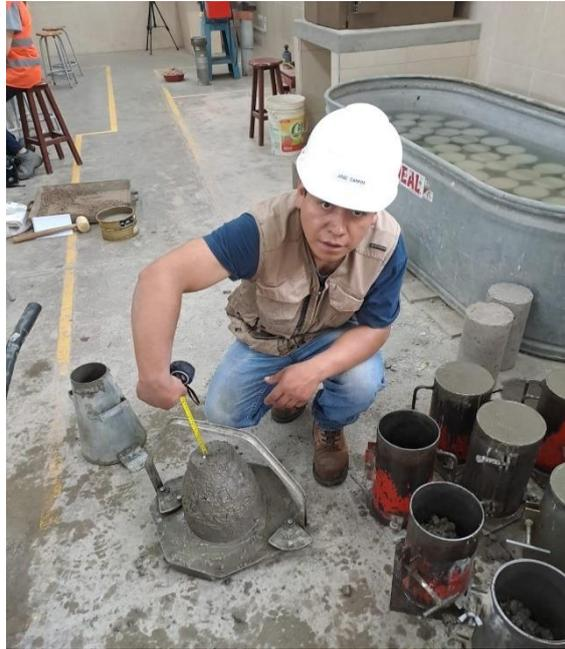
**FOTO 35:** Procedimiento de la prueba del SLUMP, concreto con 45% de agregado reciclado.
