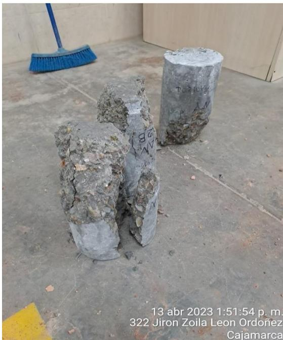
**FOTO 56:** Rotura de probeta con 30% agregado natural a los 28 días de curado.
