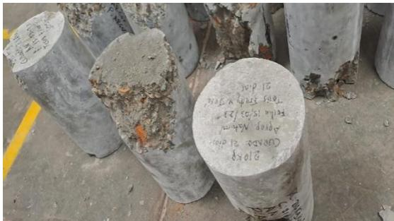
**FOTO 52:** Rotura de probeta con 30%
