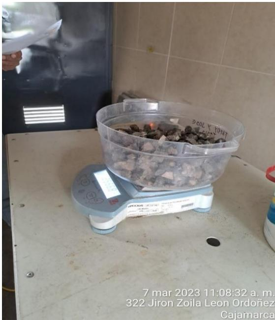
**FOTO 32:** Peso sumergido del agregado
