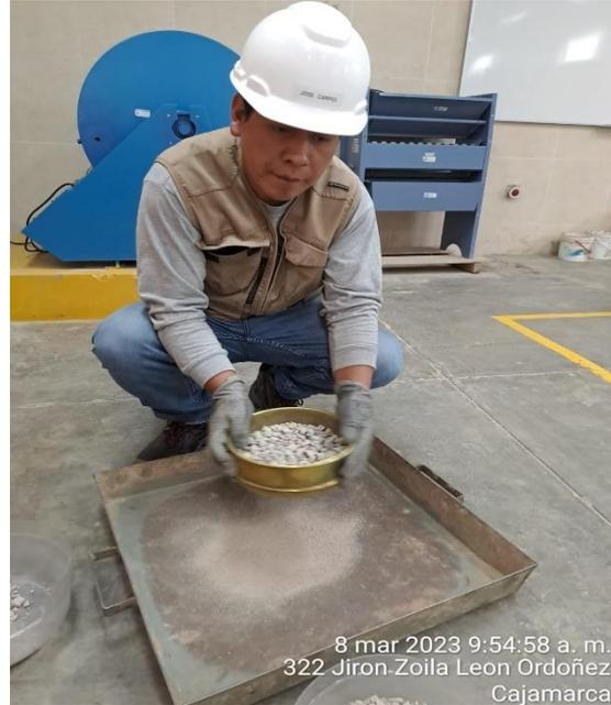
**FOTO 19:** Peso unitario suelto del agregado fino natural.
