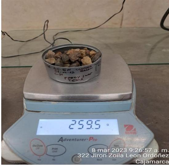
**FOTO 14:** Contenido de humedad agregado grueso reciclado, seco al horno.
