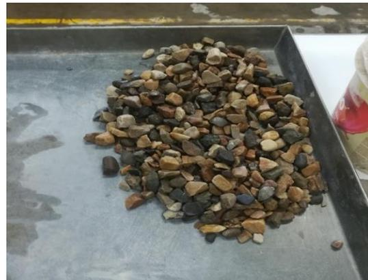
**Fotografía 7** Verificación del estado SSS de la muestra de agregado fino.
