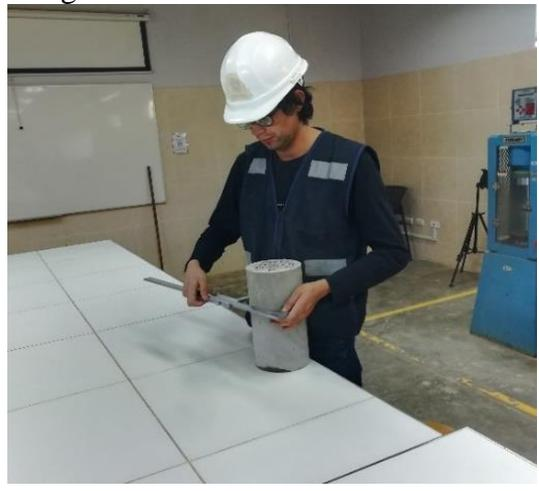
**Fotografía 19** Medición de la altura de testigos cilíndricos.
