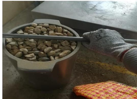
**Fotografía 5** Muestra en saturación para ensayos gravedad específica y absorción.
