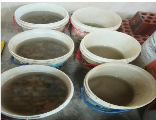
**Fotografía 6** Secado superficial de muestra saturada por 24 horas.
