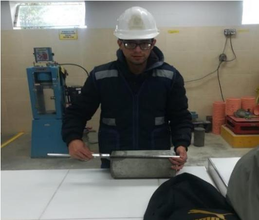
**Fotografía 20** Verificación de la perpendicularidad de testigos cilíndricos.
