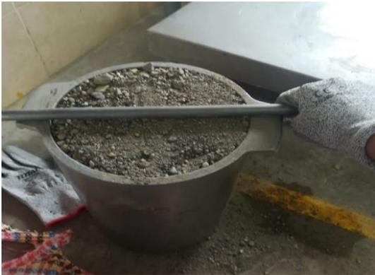
**Fotografía 4** Enrasado de agregado grueso para ensayo de peso unitario.
