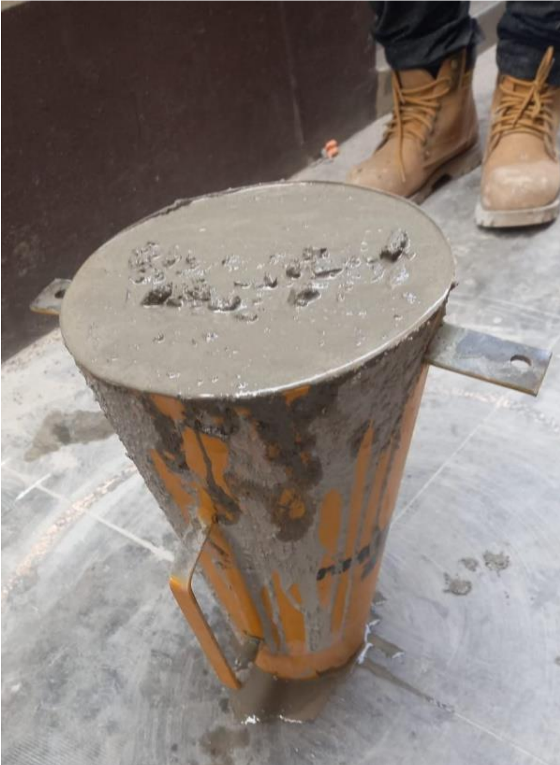
IMAGEN 6: Ensayo de T(500) y flujo de asentamiento.
