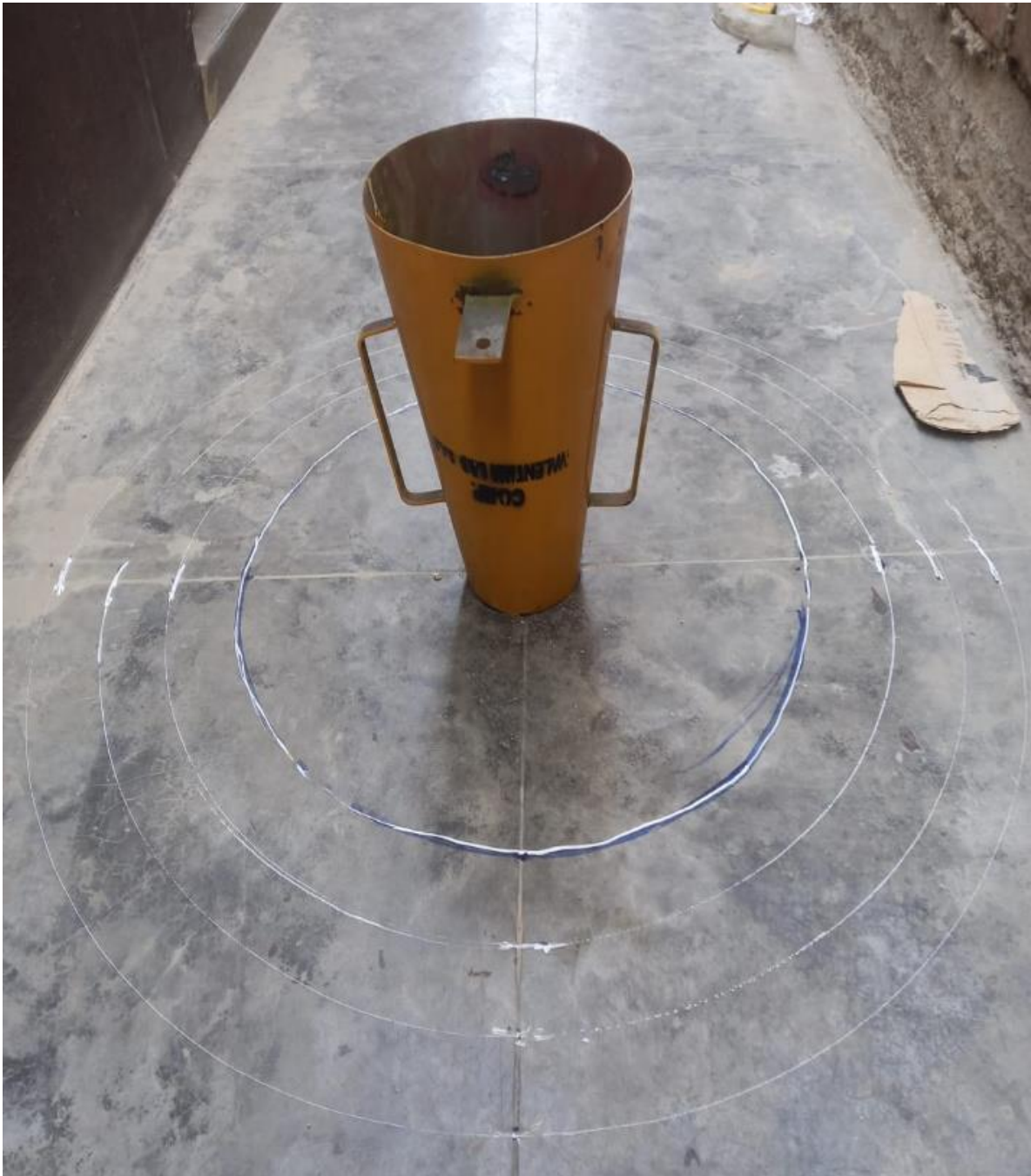
IMAGEN 5: Ensayo de T(500) y flujo de asentamiento.
