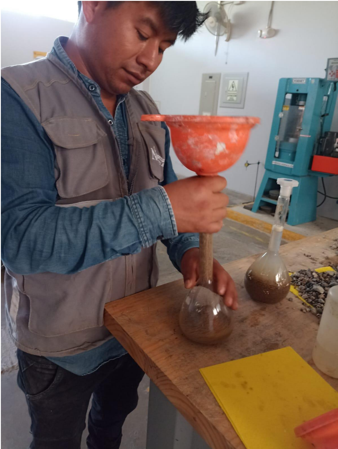
IMAGEN 4: Ensayo de granulometría, peso específico, contenido de humedad y absorción de los agregados.
