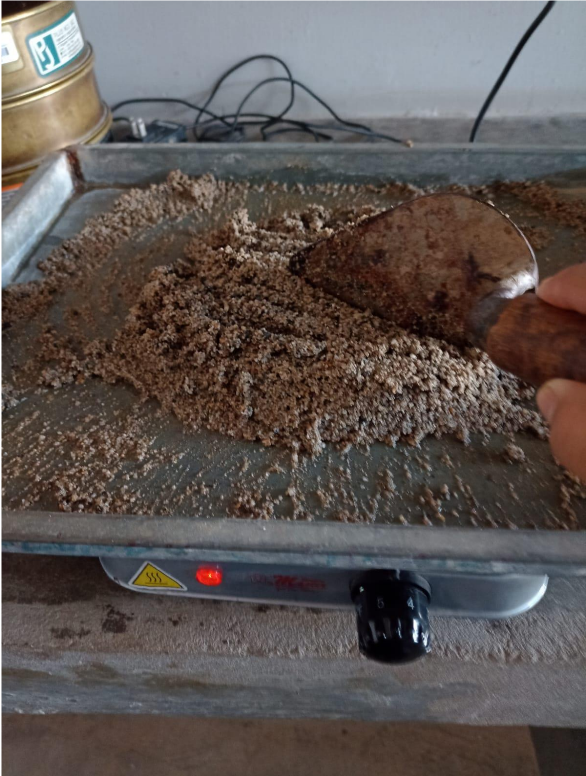
IMAGEN 3: Ensayo de granulometría, peso específico, contenido de humedad y absorción de los agregados.
