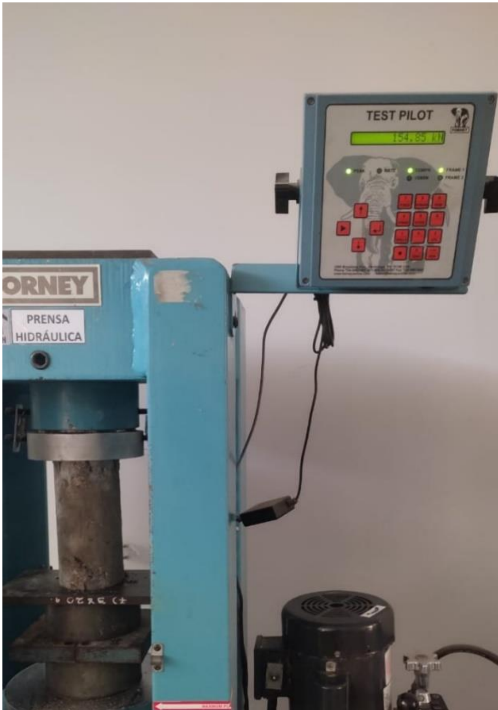
IMAGEN 11: Ensayo de resistencia a la compresión.
