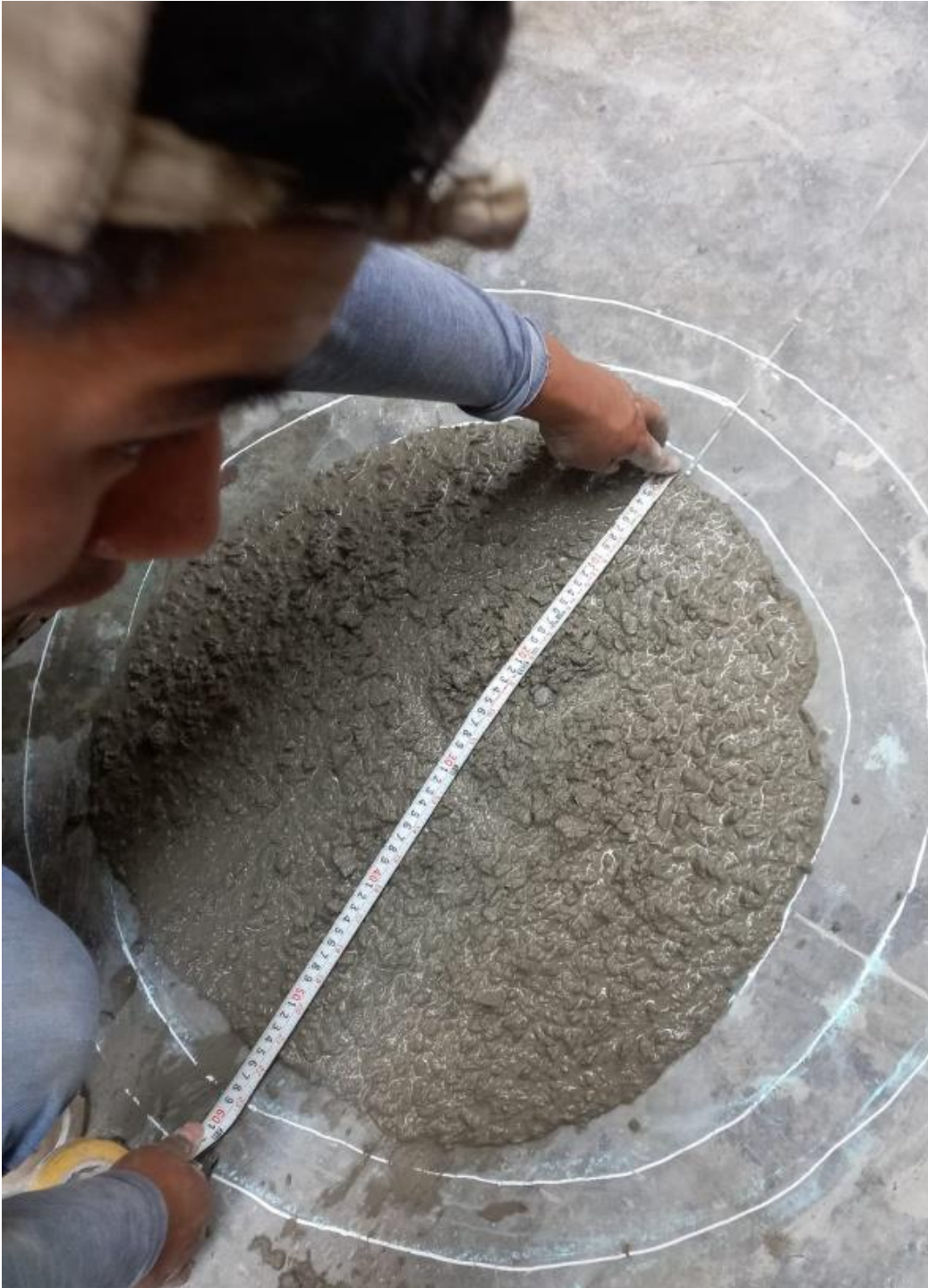
IMAGEN 8: Ensayo de T(500) y flujo de asentamiento.
