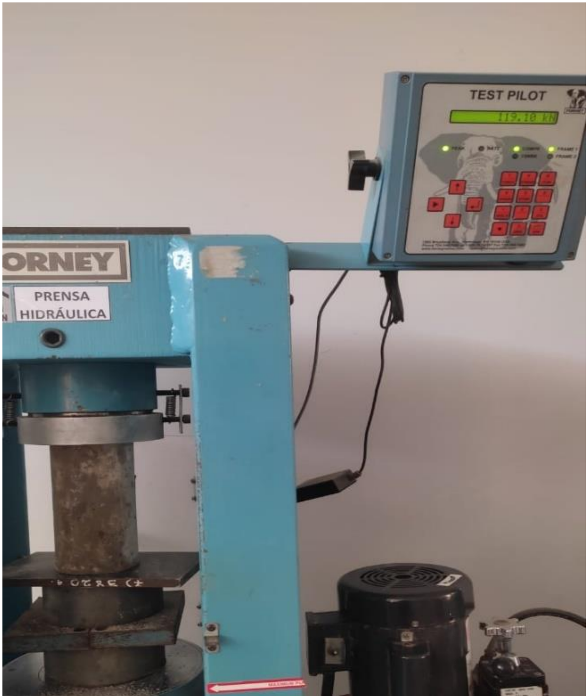
IMAGEN 10: Ensayo de resistencia a la compresión.
