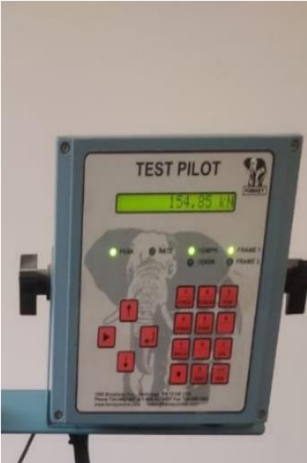
IMAGEN 12: Ensayo de resistencia a la compresión.
