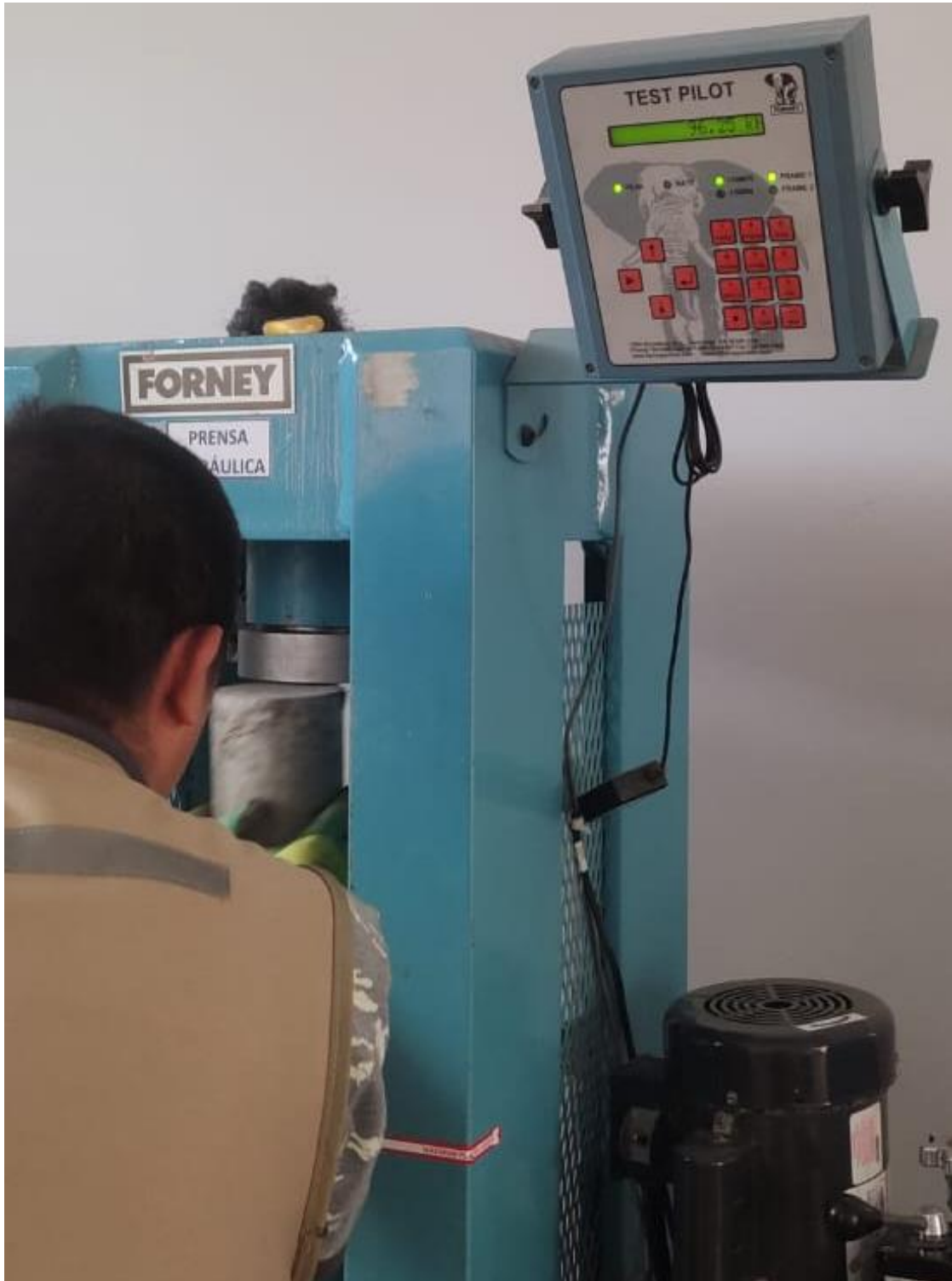
IMAGEN 9: Ensayo de resistencia a la compresión.
