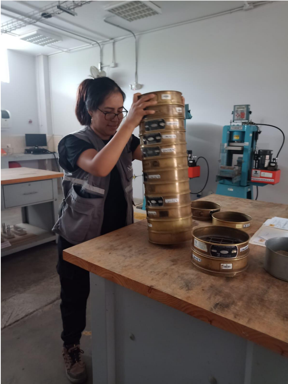
IMAGEN 1: Ensayo de granulometría, peso específico, contenido de humedad y absorción de los agregados.
