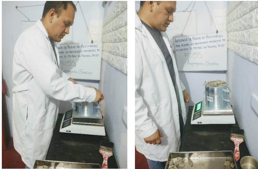
Ilustración 10. Ensayo de peso unitario suelto seco PUSS – agregado grueso
