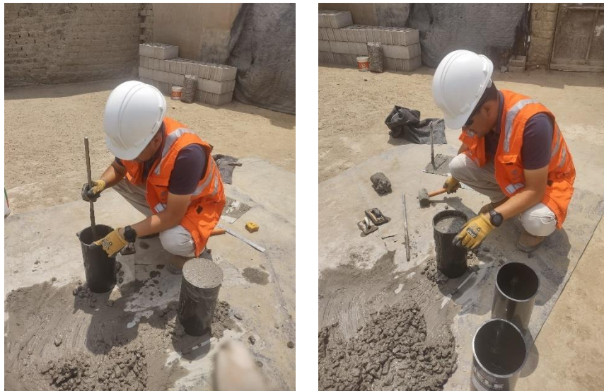
Ilustración 15. Preparación de probetas cilíndricas 15cm x 30cm
