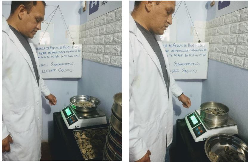
Ilustración 6. Ensayo de granulometría del agregado grueso
