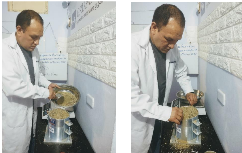
Ilustración 9. Ensayo de peso unitario suelto seco PUCS – agregado fino
