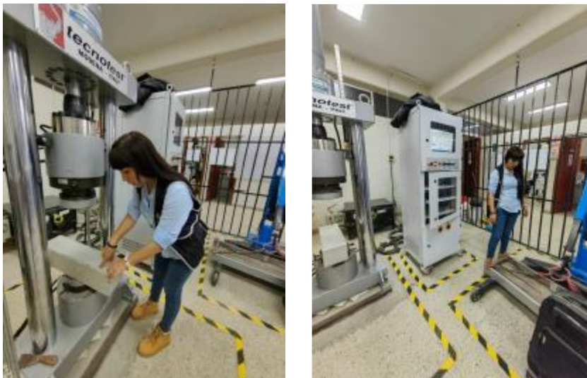
Ilustración 20. Ensayos a flexión de las vigas prismáticas
