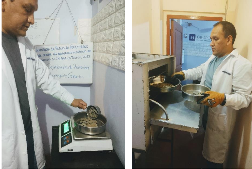
Ilustración 2. Ensayo de contenido de humedad del agregado grueso
