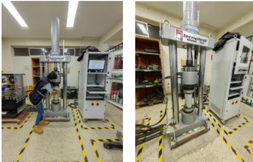
Ilustración 18. Ensayos a compresión de las probetas cilíndricas
