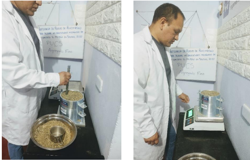
Ilustración 8. Ensayo de peso unitario compactado seco PUCS – agregado fino
