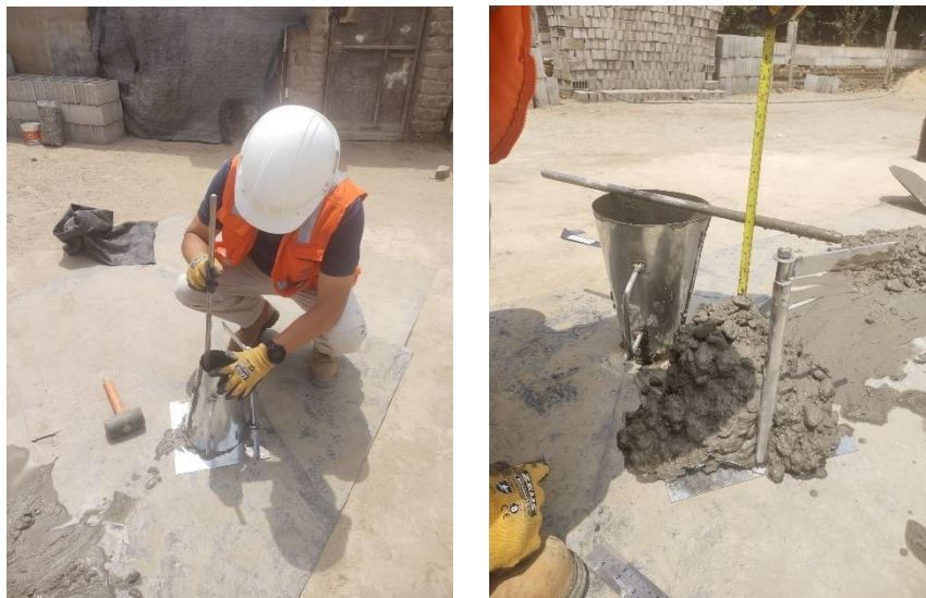
Ilustración 14. Ensayo de cono de Abrams
