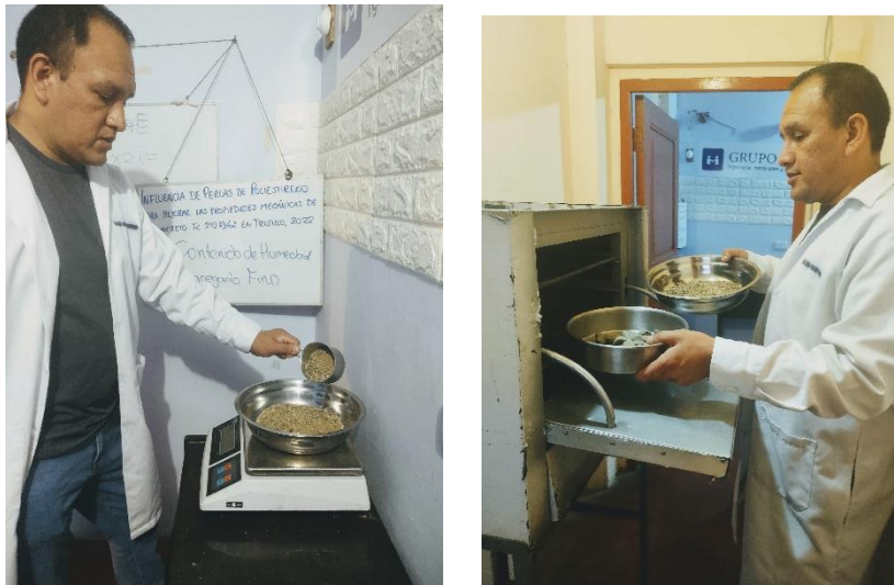
Ilustración 3. Ensayo de contenido de humedad del agregado fino
