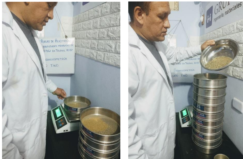
Ilustración 5. Ensayo de granulometría del agregado fino
