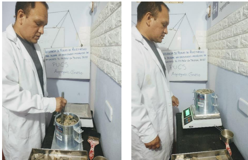
Ilustración 7. Ensayo de peso unitario compactado seco PUCS – agregado grueso
