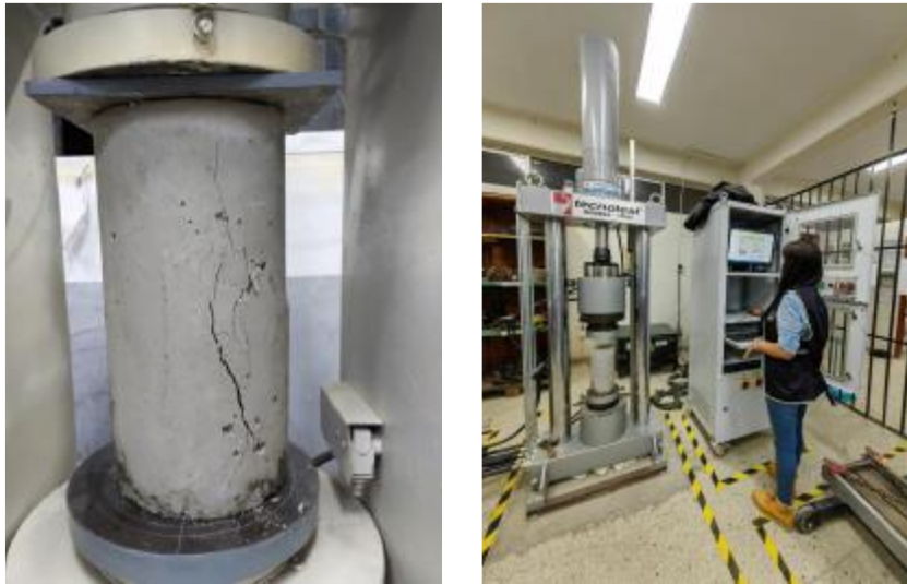
Ilustración 19. Ensayos a compresión de las probetas cilíndricas
