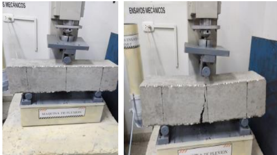
Ilustración 21. Ensayos a flexión de las vigas prismáticas
