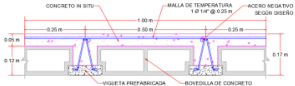
Figura 1.1 Detalle del aligerado con Sistema Vigueta Bovedilla para una losa de peralte de 17 cm.
