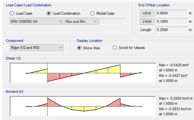
Figura 09: Esfuerzos máximos en viga más solicitada de Terraza 1, de acuerdo a envoltente de diseño
