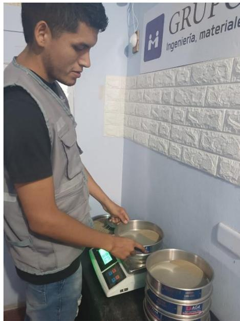
Fotografía 6. Pesado de malla con material fino retenido – ensayo de granulometría
