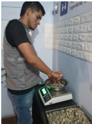
Fotografía 26. Pesamos el agregado grueso – Ensayo de contenido de humedad.
