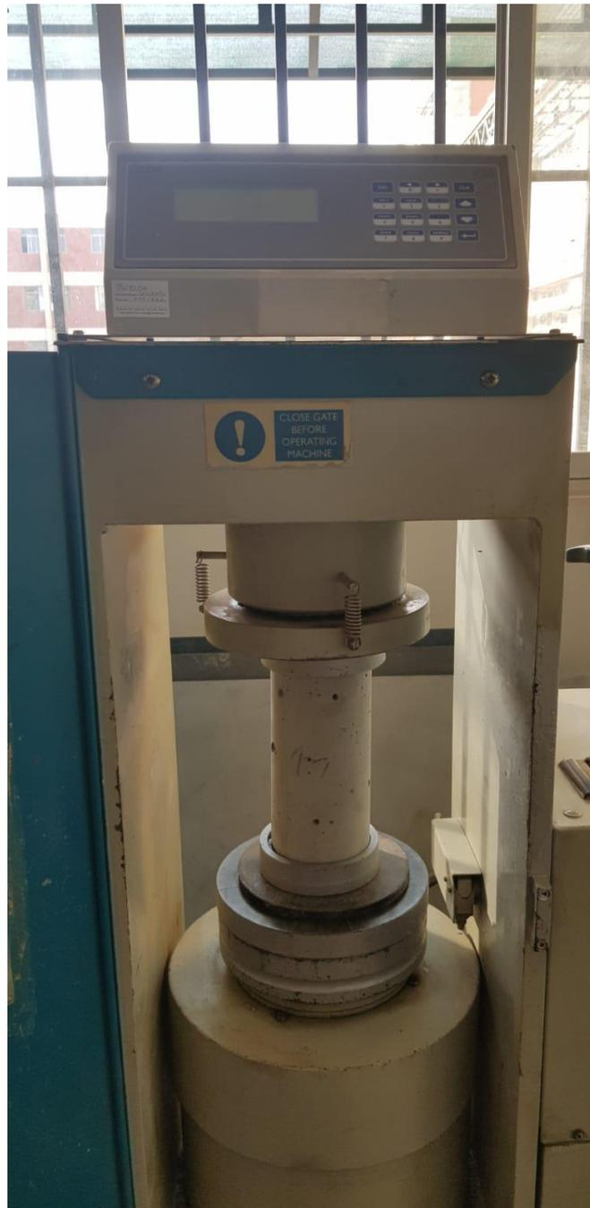
Fotografía 39. Ensayo de ruptura de probetas.
