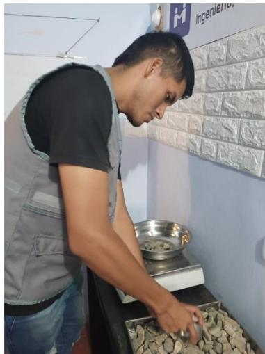
Fotografía 28. Pesamos la muestra seca – Ensayo de contenido de humedad.
