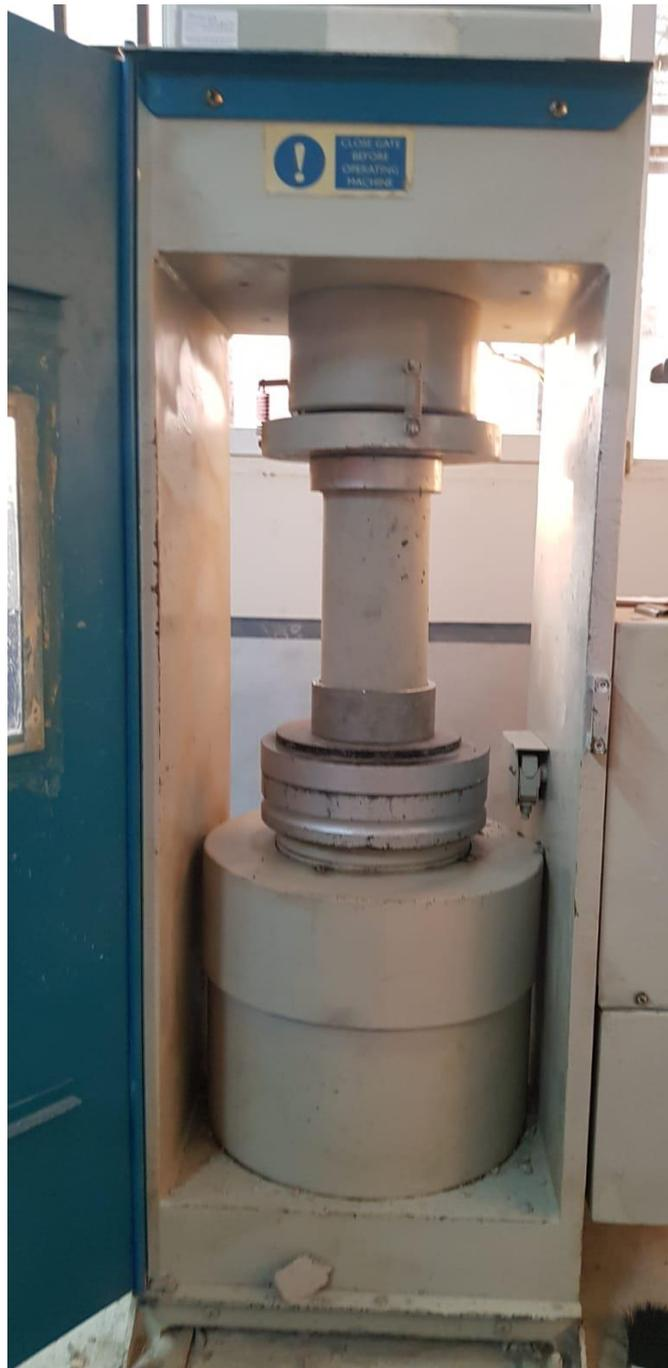
Fotografía 40. Ensayo de ruptura de probetas.
