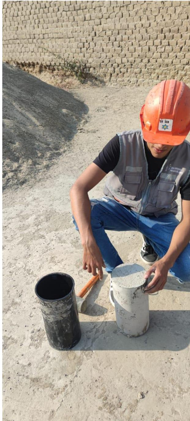
Fotografía 37. Desmoldando las probetas – Elaboración de probetas.
