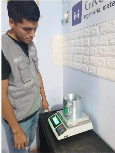
Fotografía 19. Pesamos el recipiente – Ensayo de Peso Unitario Suelto Agregado Grueso Y Fino
