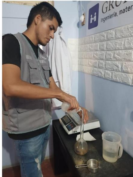
Fotografía 13. Limpiamos los restos de agregado con el gotero – ensayo de peso específico y absorción.
