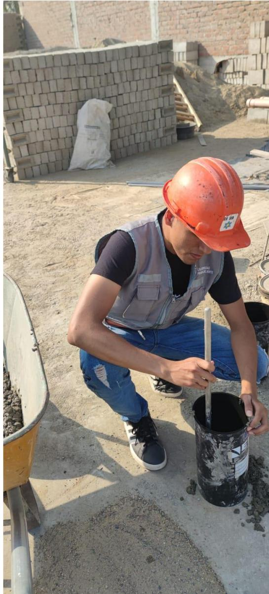
Fotografía 32. Varillamos la mezcla por cada tercio del molde que llenamos – Elaboración de probetas.
