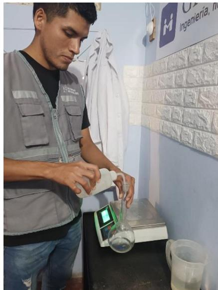
Fotografía 10. Llenado agua a la fiola – ensayo de peso específico y absorción.
