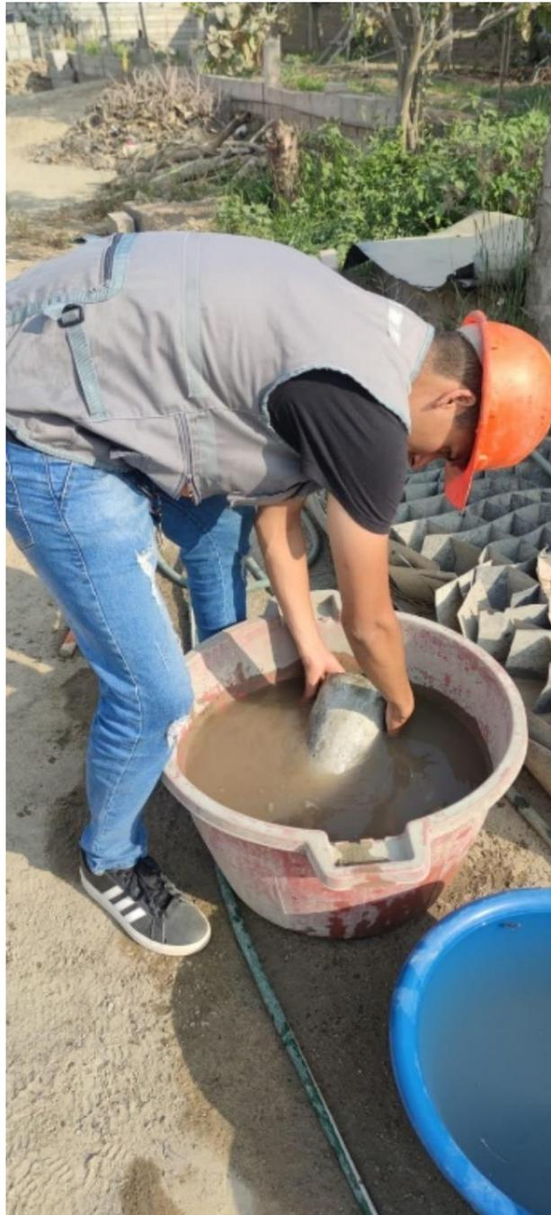
Fotografía 38. Colocamos las probetas en la poza de curado –
