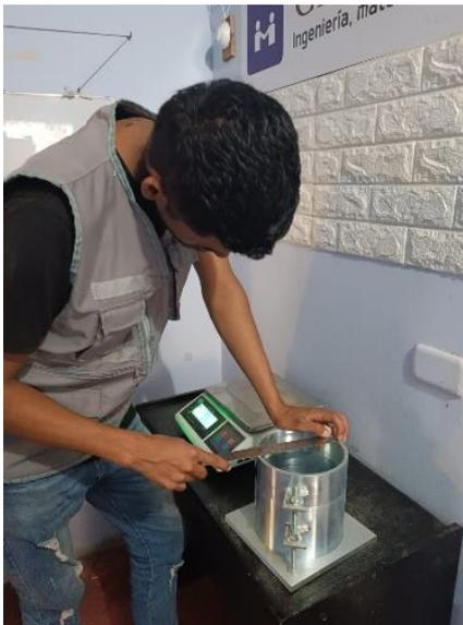
Fotografía 18. Hallamos el volumen del recipiente – Ensayo de Peso Unitario Suelto Agregado Gueso Y Fino
