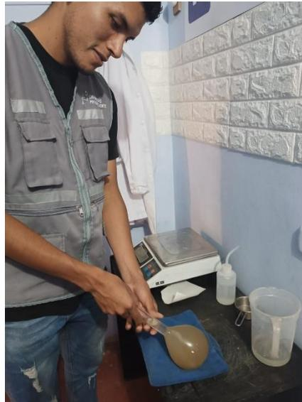
Fotografía 14. Giramos la fiola para sacar las burbujas atrapadas – ensayo de peso específico y absorción.
