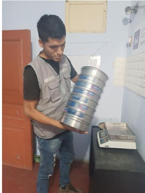
Fotografía 5. Realizando el tamizado – ensayo de granulometría
