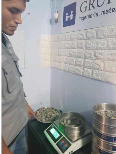
Fotografía 7. Pesado de malla con material grueso retenido – ensayo de granulometría
