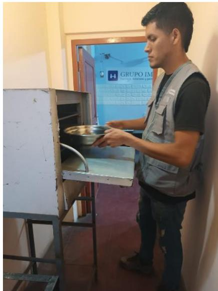
Fotografía 16. Llevamos la muestra al horno por 24h – ensayo de peso específico y absorción.
