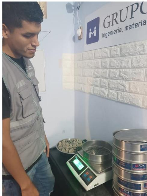
Fotografía 2. Pesado de malla – ensayo de granulometría
