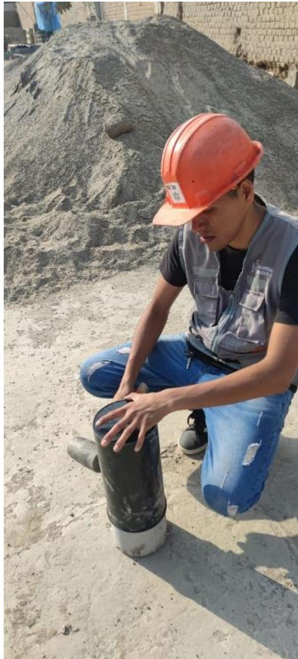
Fotografía 35. Desmoldando las probetas – Elaboración de probetas.
