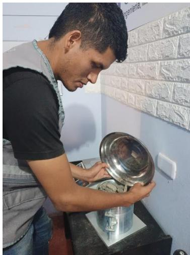
Fotografía 20. Llenamos el recipiente con el agregado grueso – Ensayo de Peso Unitario Suelto Agregado Grueso Y Fino
