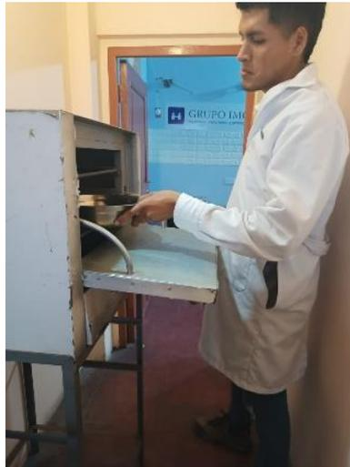
Fotografía 27. Lo llevamos al horno por 24h – Ensayo de contenido de humedad.
