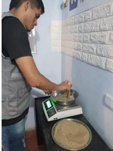
Fotografía 25. Pesamos la muestra seca – Ensayo de contenido de humedad.
