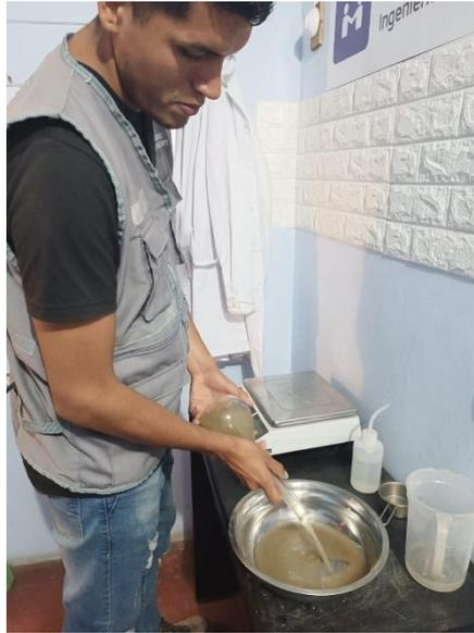
Fotografía 15. Retiramos el contenido de la fiola en un plato – ensayo de peso específico y absorción.
