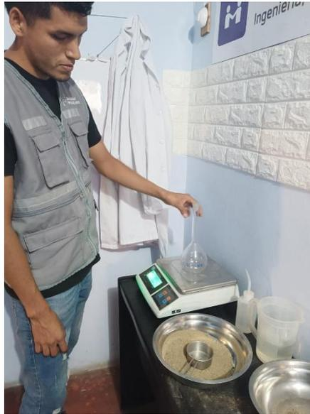
Fotografía 11. Pesamos la fiola más el agua – ensayo de peso específico y absorción.
