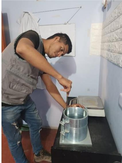
Fotografía 17. Hallamos el volumen del recipiente – Ensayo de Peso Unitario Suelto Agregado Gueso Y Fino
