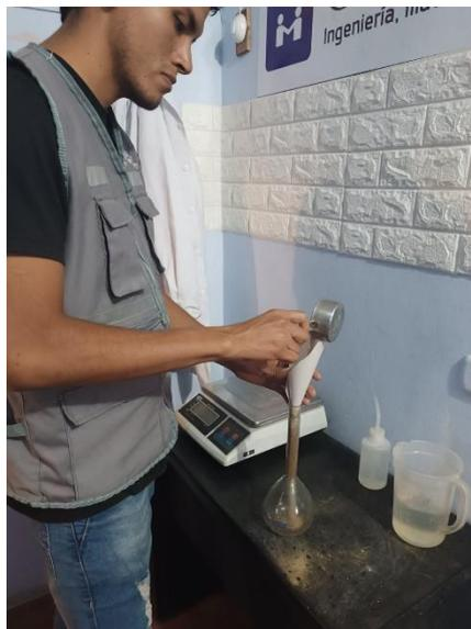
Fotografía 12. Añadiendo el agregado fino – ensayo de peso específico y absorción.
