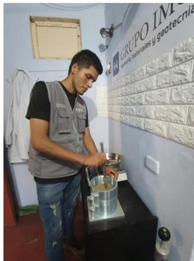
Fotografía 22. Llenamos el recipiente por capas con el agregado fino y
