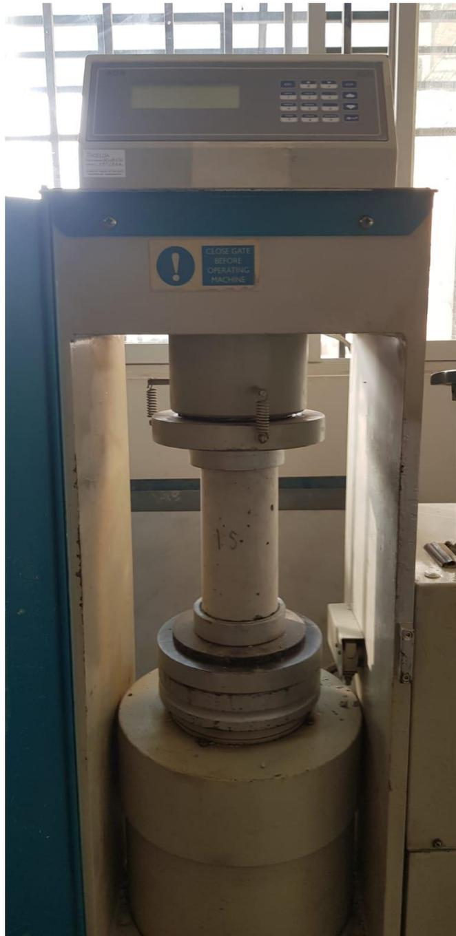
Fotografía 42. Ensayo de ruptura de probetas.
