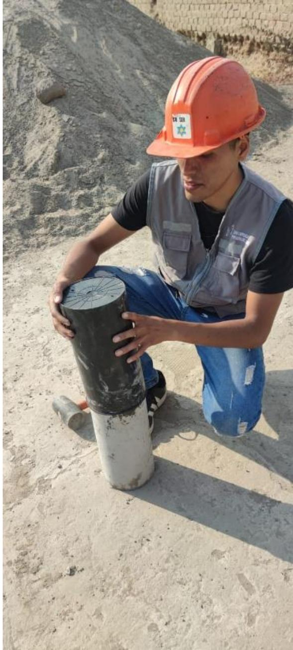
Fotografía 36. Desmoldando las probetas – Elaboración de probetas.
