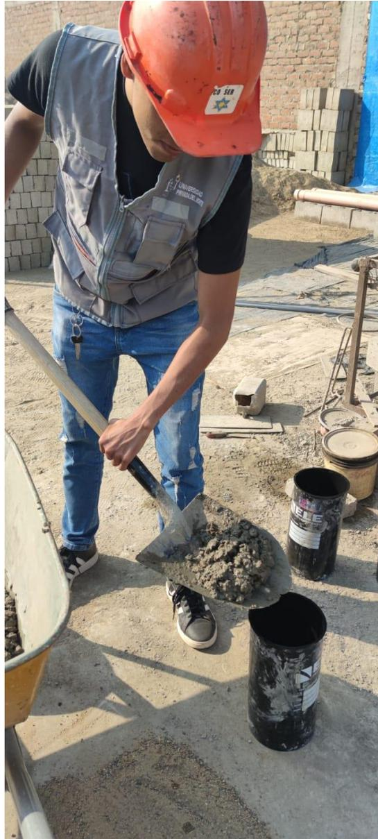
Fotografía 31. Colocación de la mezcla en los moldes enrasados –
