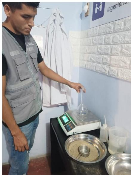
Fotografía 8. Pesado de fiola – ensayo de peso específico y absorción.
