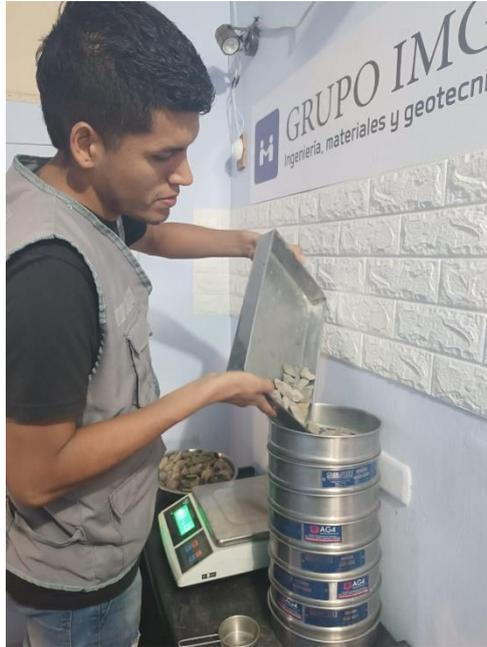
Fotografía 3. Agregando el material grueso – ensayo de granulometría
