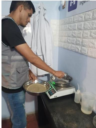
Fotografía 23. Pesamos el agregado fino – Ensayo de contenido de humedad.
