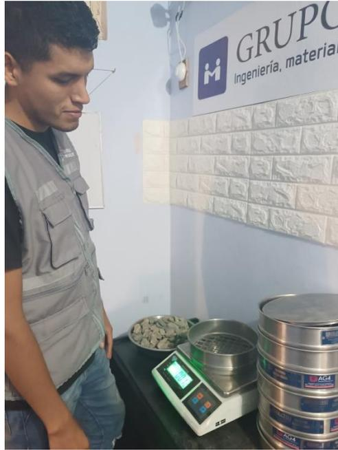
Fotografía 1. Pesado de malla – ensayo de granulometría
