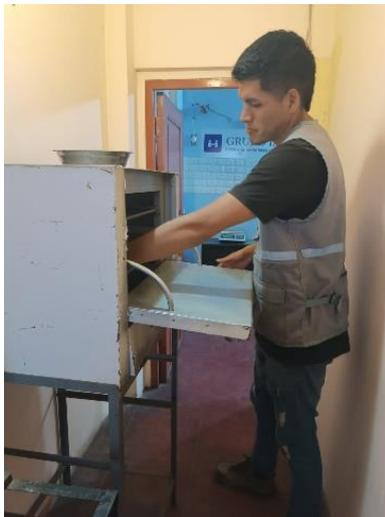
Fotografía 24. Lo llevamos al horno por 24h – Ensayo de contenido de humedad.
