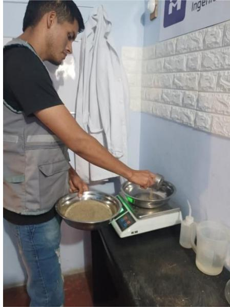
Fotografía 9. Pesamos 100 g de agregado fino – ensayo de peso específico y absorción.
