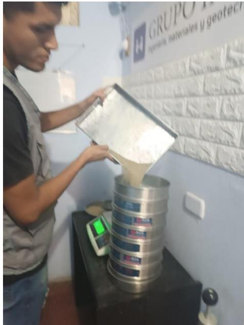
Fotografía 4. Agregando el material fino – ensayo de granulometría
