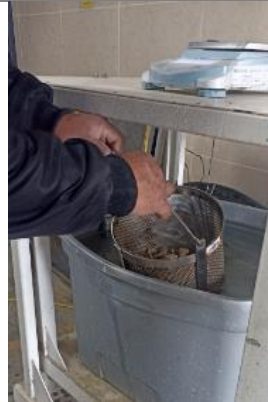
Foto 08: Ensayo de peso específico y absorción del agregado grueso.
