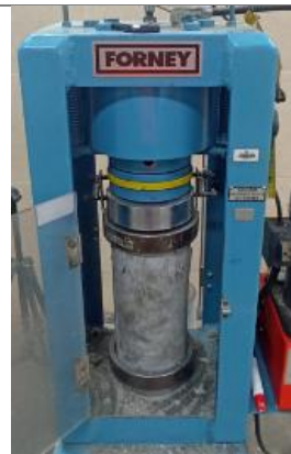
Foto 22: Ensayo de resistencia a Compresión de especímenes de concreto tradicional.
