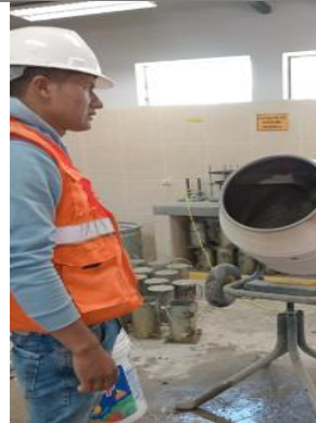
Foto 14: Elaboración de especímenes de concreto tradicional.
