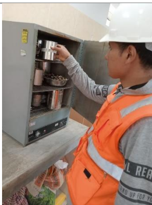
Foto 05: Ensayo de contenido de humedad del agregado fino.
