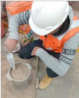
Foto 09: Ensayo de peso unitario suelto del agregado fino.
