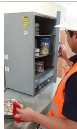
Foto 06: Ensayo de contenido de humedad del agregado grueso.
