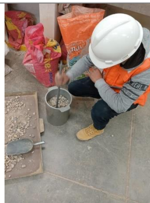
Foto 12: Ensayo de peso unitario compactado del agregado grueso.
