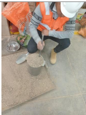
Foto 11: Ensayo de peso unitario compactado del agregado fino.
