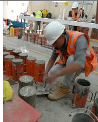
Foto 20: Desmoldado de especímenes de concreto.
