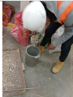
Foto 10: Ensayo de peso unitario suelto de agregado grueso.
