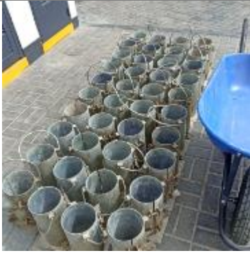
Foto 13: Moldes para la elaboración de especímenes de concreto.
