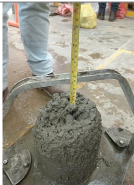
Foto 15: Elaboración de especímenes de concreto con adición de fibras de Nylon.
