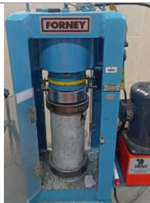
Foto 23: Ensayo de resistencia a Compresión de especímenes de concreto con adición de fibras de Nylon.
