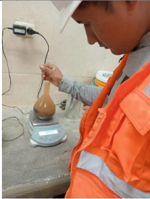
Foto 07: Ensayo de peso específico y absorción del agregado fino.
