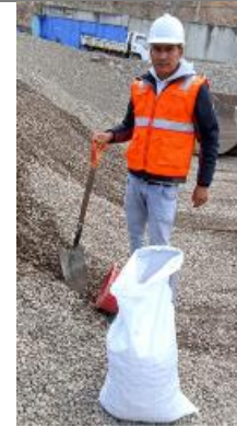
Foto 02: Extracción del agregado grueso de la cantera “Bazán”.
