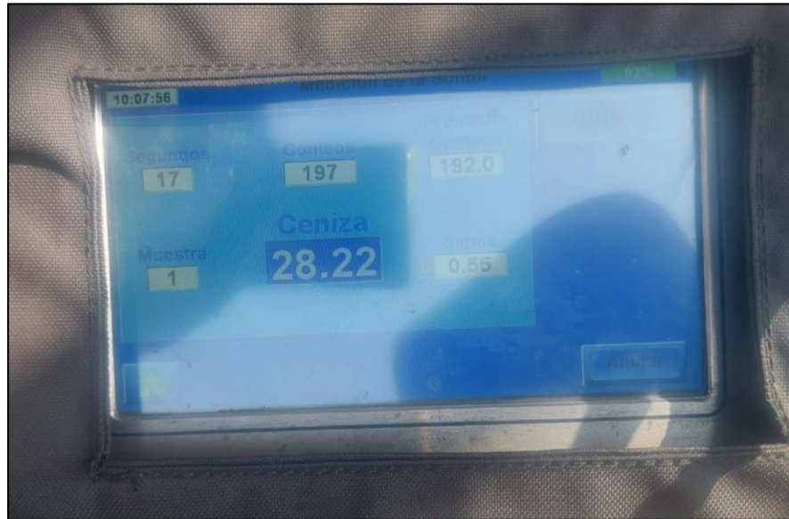
Figura 7. Producto rechazado por alta ceniza (28.22%).
