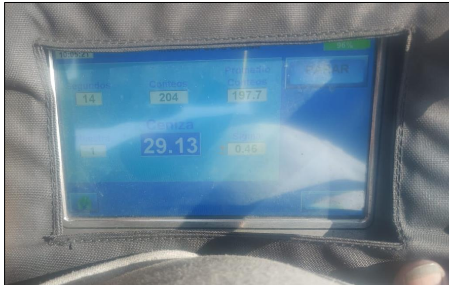
Figura 8. Producto rechazado por alta ceniza (29.13%).
