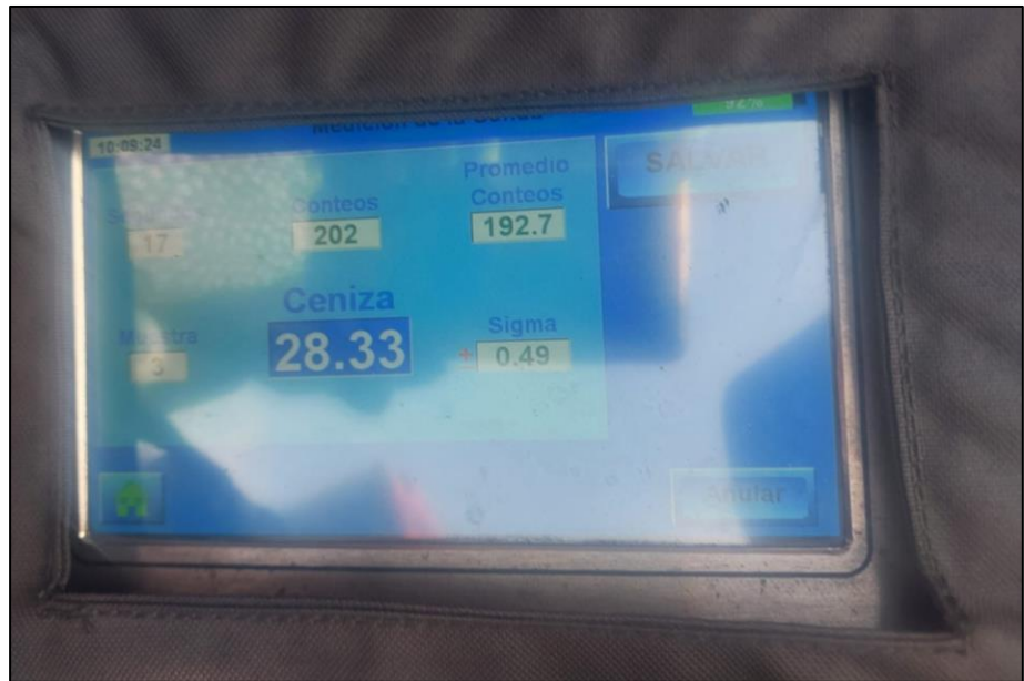
Figura 6. Producto rechazado por alta ceniza (28.33%).
