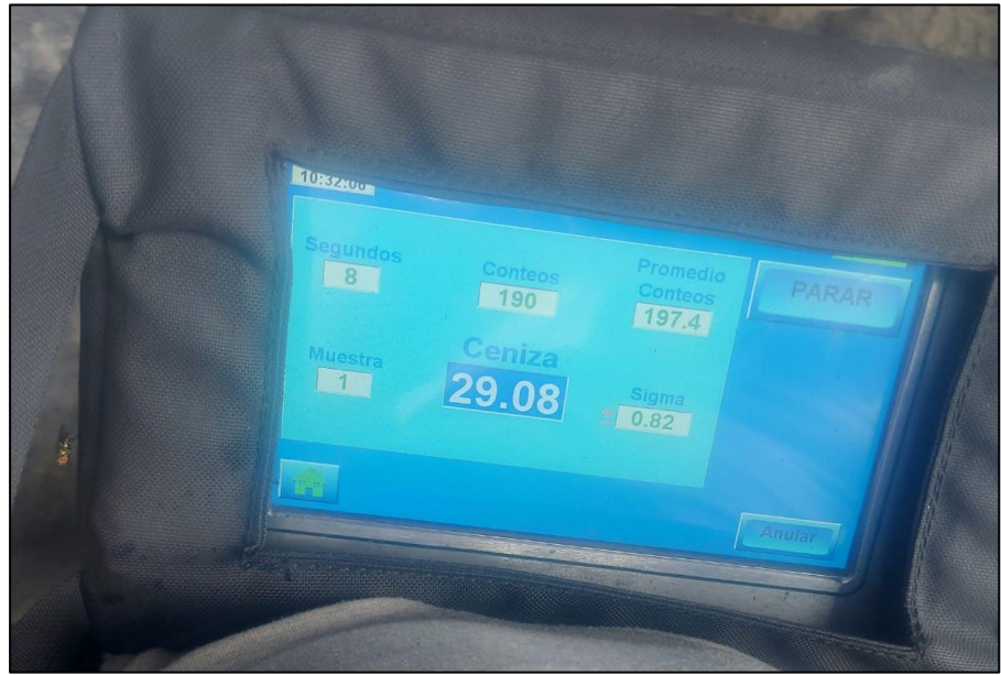
Figura 5. Producto rechazado por alta ceniza (29.08%).
