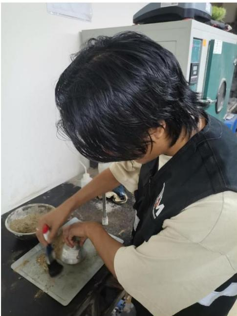
Figure 3 peso especifico y absorcion del AF
