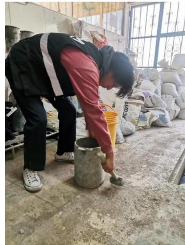
Figure 16 peso unitario del concreto
