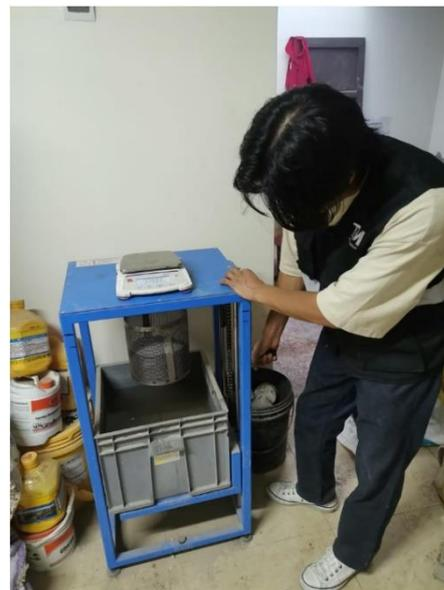
Figure 12 peso específico y absorción del AG
