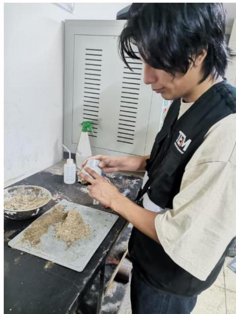
Figure 4 peso especifico y absorcion del AF
