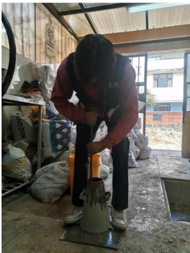
Figure 17 ensayo de asentamiento
