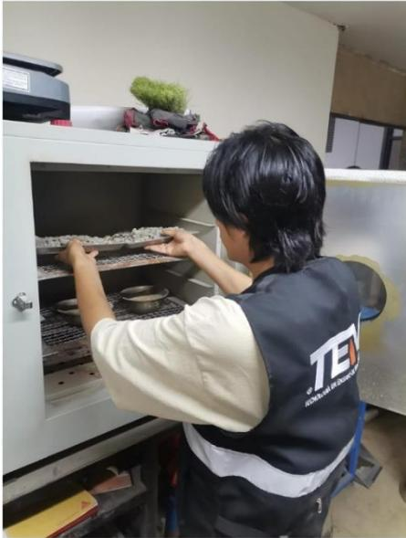
Figure 9 contenido de humedad de los agregados
