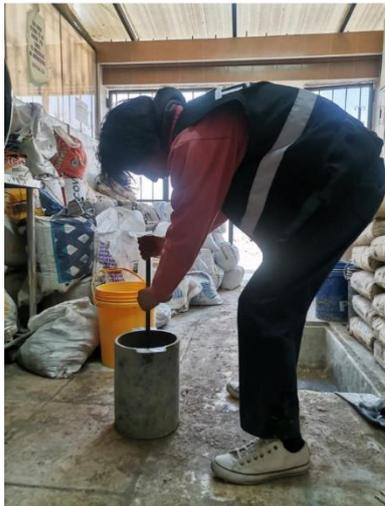
Figure 15 peso unitario del concreto
