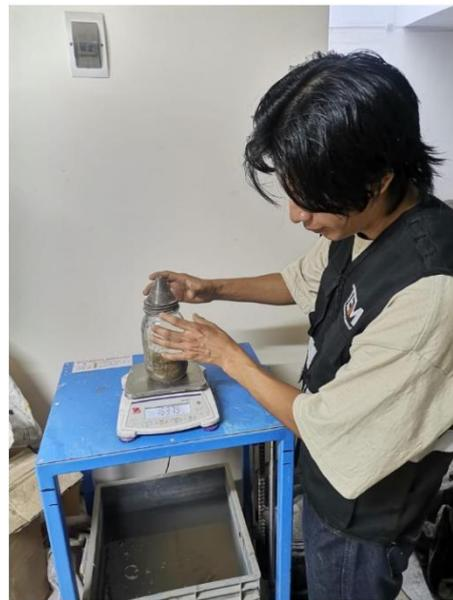
Figure 6 peso específico y absorcion
