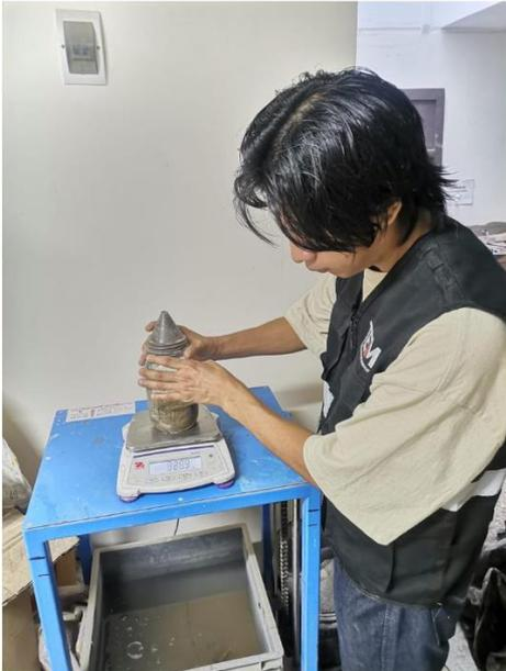
Figure 5 peso específico y absorcion del AF
