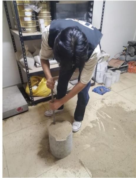
Figure 2 peso unitario del agregado fino
