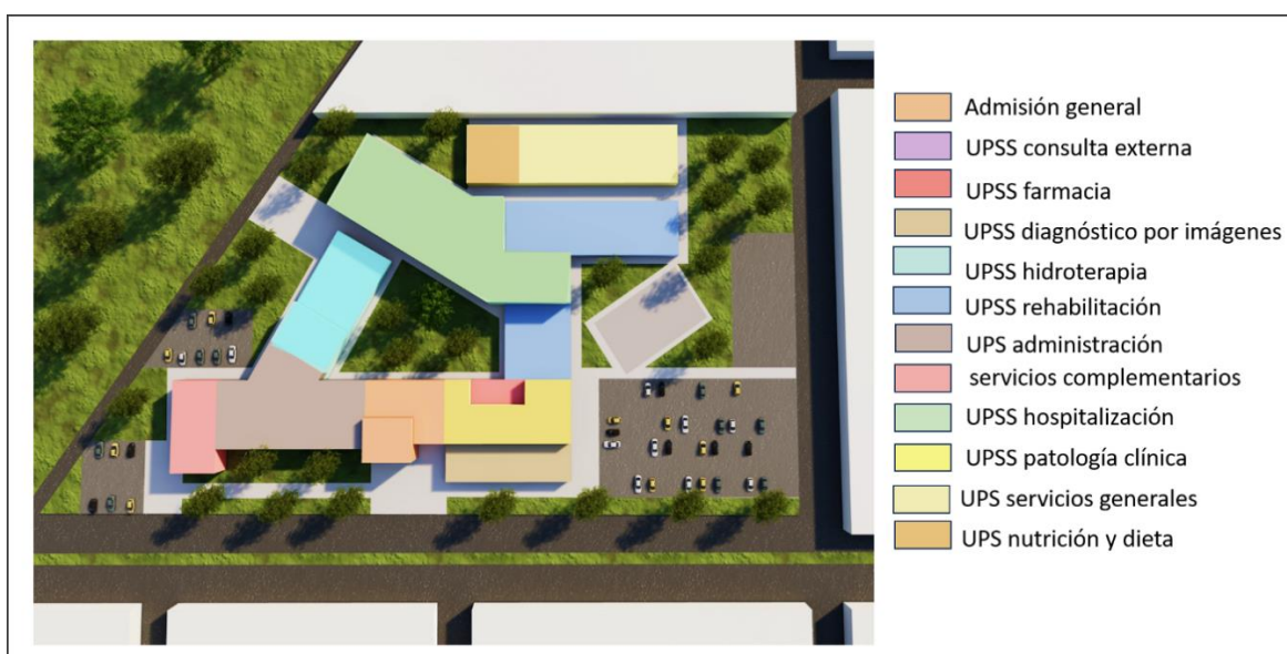
Figura 88: Zonificación Segundo Nivel
