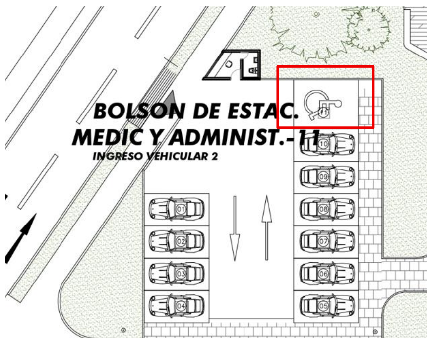
Figura 114: Estacionamiento de discapacitados para personal médico y administrativo
