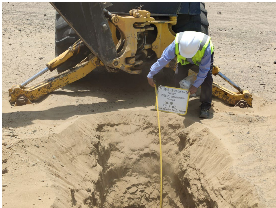
Figura 6. Estudio de mecánica de suelos en proyecto agroalimentario.
