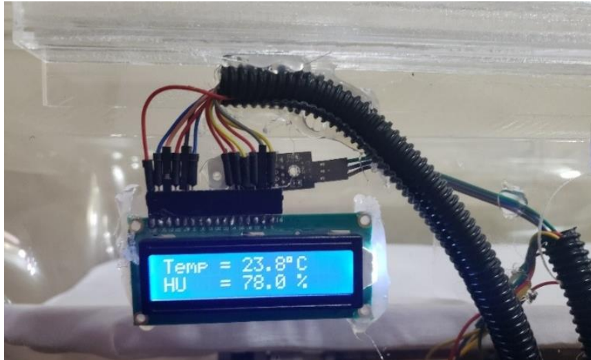
Figura 48: Lectura de temperatura y humedad dentro de la cuna. Fuente: Creación propia.
