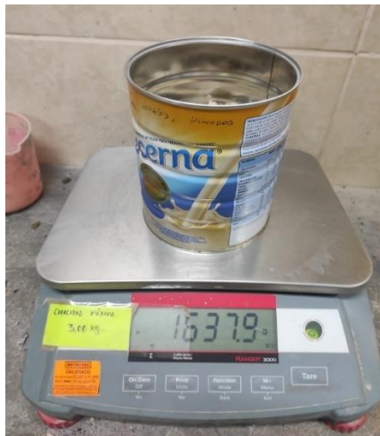
Ilustración 3: Secado de muestras para el contenido de Humedad.
