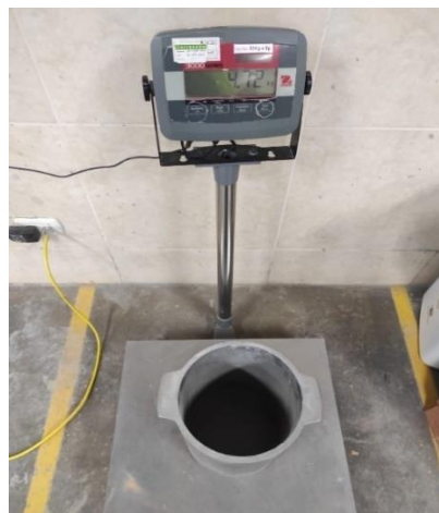
Ilustración 6: Peso vacío del agregado grueso.
