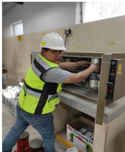
Ilustración 3: Secado de muestras para el contenido de Humedad.
