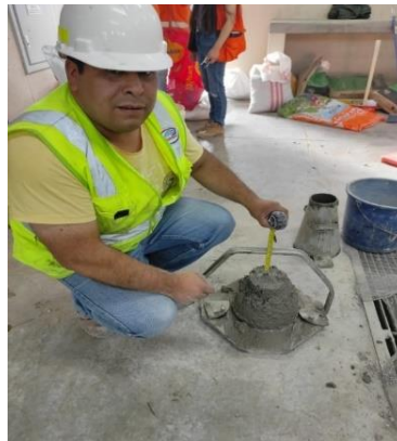
Ilustración 8: Secando la prueba del Slump.
