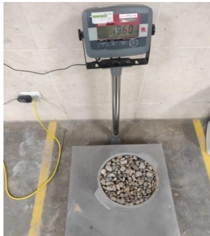
Ilustración 6: Peso vacío del agregado grueso.
