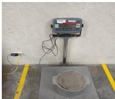
Ilustración 4: Peso unitario y vacío del agregado fino.
