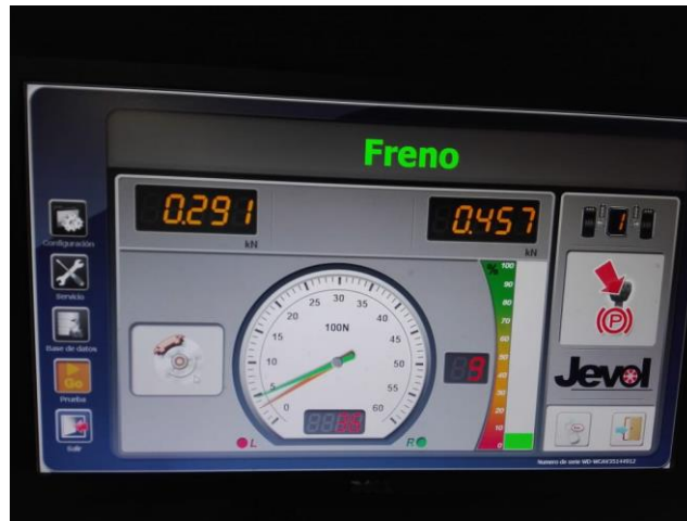
Anexo 1 Panel de medición de Fuerza
