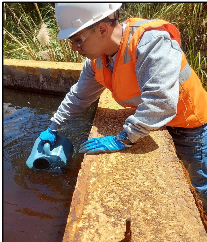
Foto 4. Recojo de la M2 para el análisis en el laboratorio
