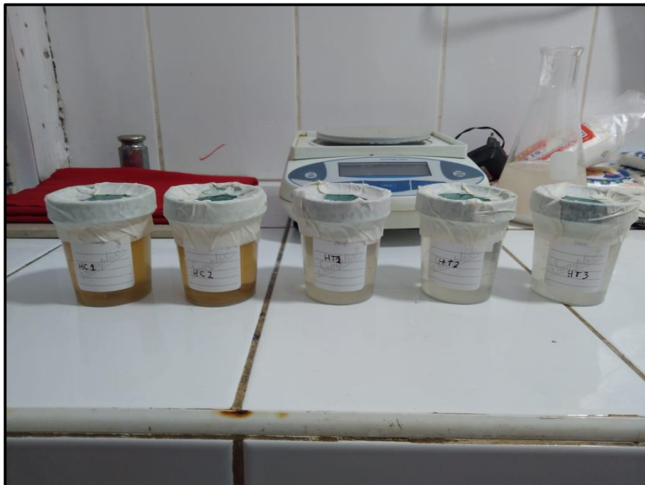
Foto 16. Muestras de cabeza y muestras para analizar después del tratamiento con TiO 2
