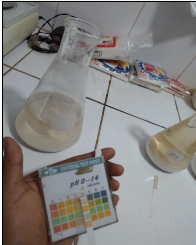
Foto 15. Medición del pH, después del tratamiento con TiO 2
