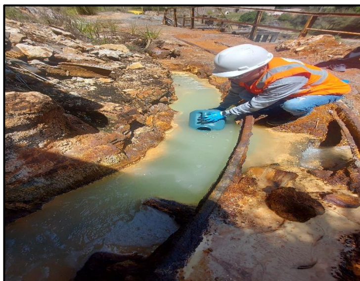
Foto 2. Recojo de la M1 para el análisis en el laboratorio
