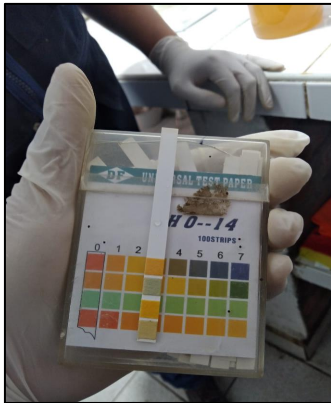
Foto 9. Medición del pH del agua recolectada de drenaje ácido
