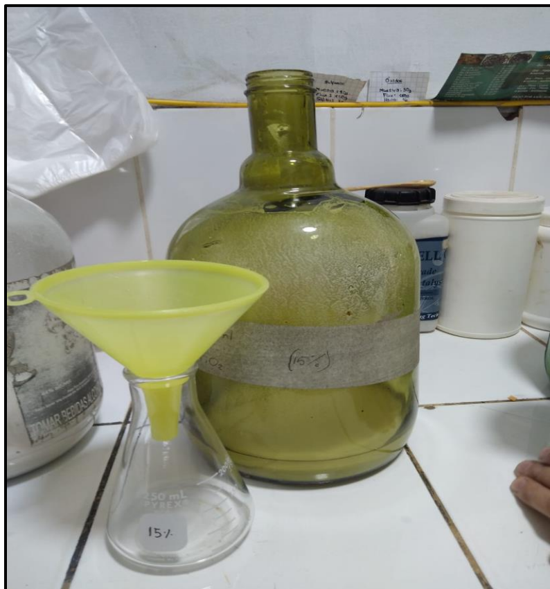
Foto 12. Vertiendo después de la agitación, para analizar la muestra al 15% de TiO 2
