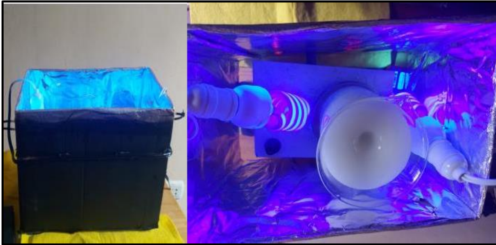
Foto 17. Pruebas experimentales de fotocatalisis heterogénea UV
