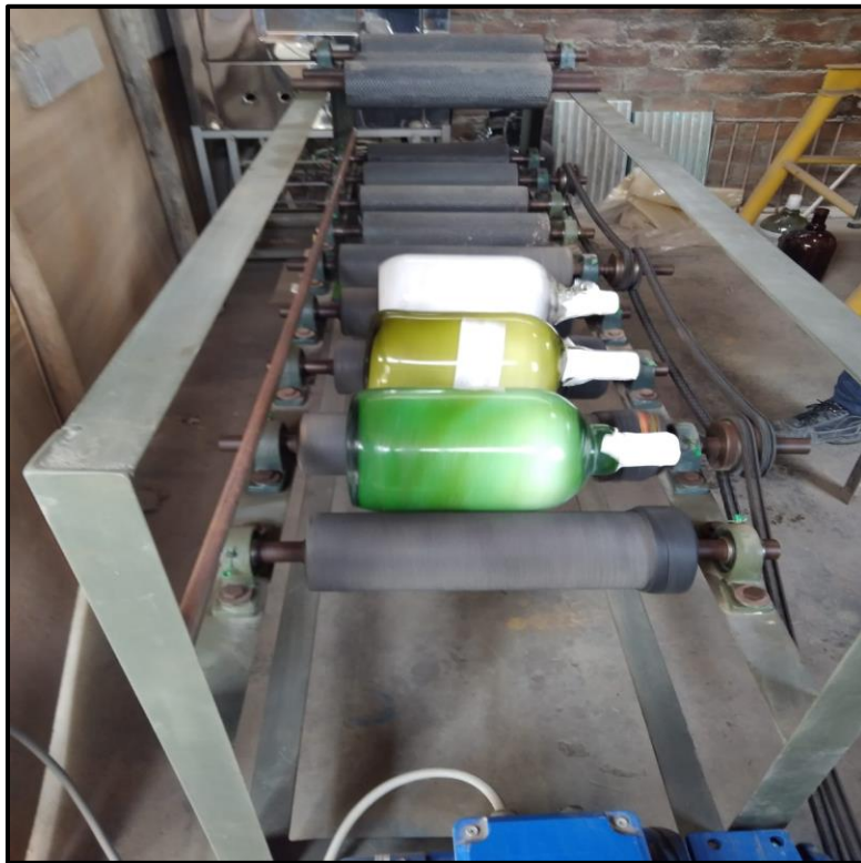
Foto 11. Tiempo de agitación de 1h. con el TiO 2 añadido
