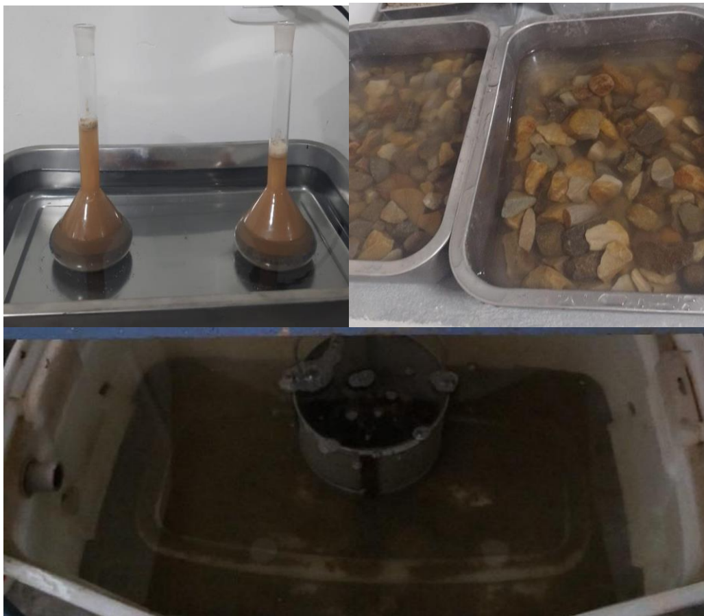
Fotografía 12, 13 y 14: Gravedad específica y absorción del agregado grueso y fino
