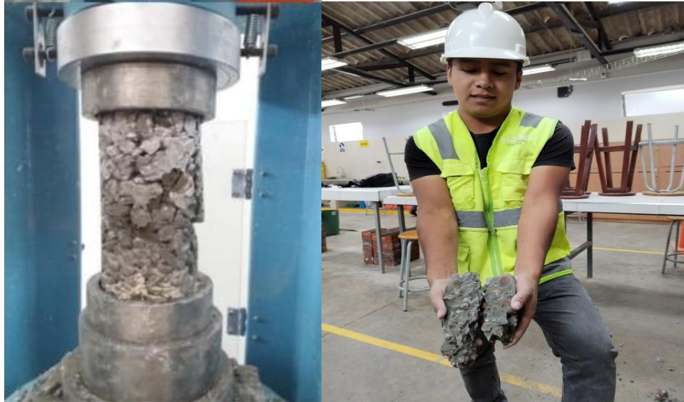
Fotografía 22 y 23 Ensayo de resistencia a la compresión
