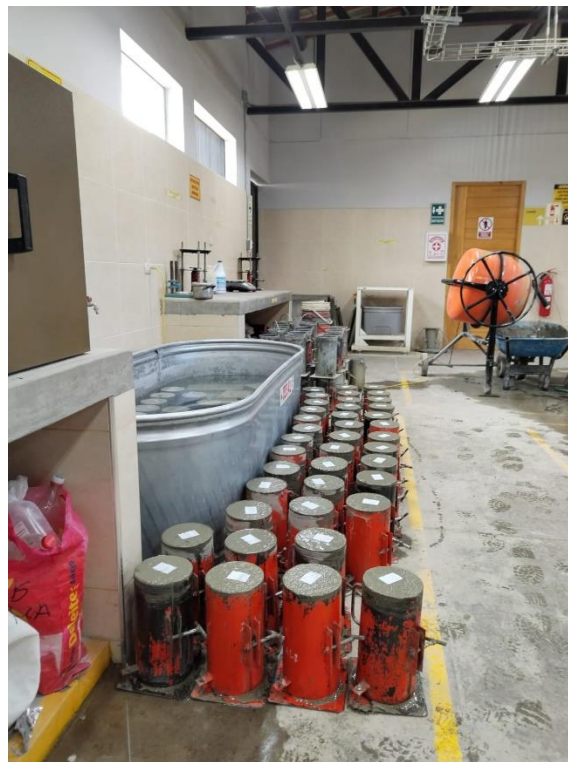
Fotografía 19, 20 y 21 Elaboración de probetas
