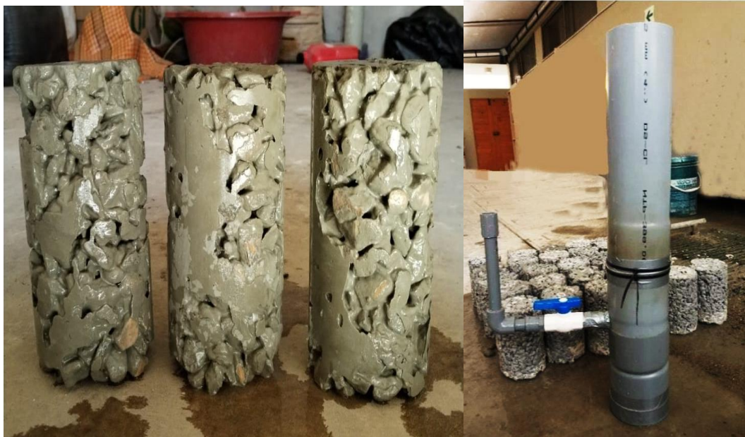
Fotografía 24, 25 y 26 Ensayo de permeabilidad.
