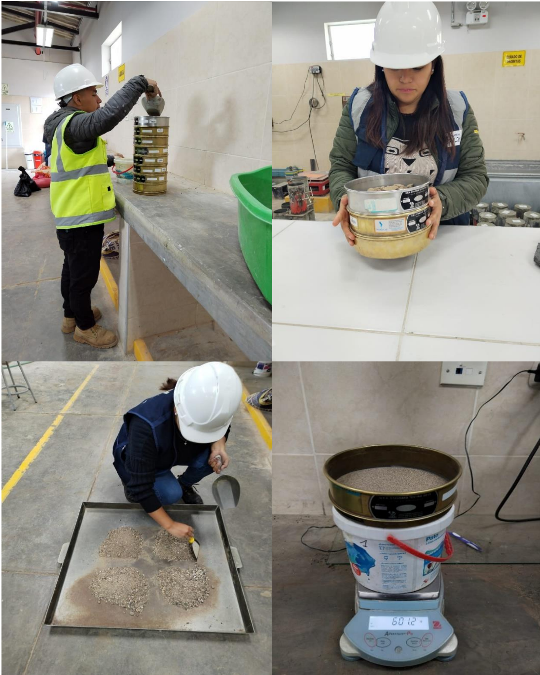
Fotografía 6, 7, 8 y 9 Análisis granulométrico de los agregados
