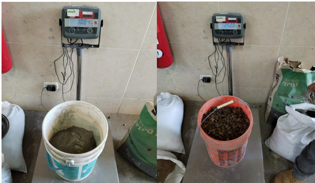
Fotografía 17 y 18 agregado grueso y fino.
